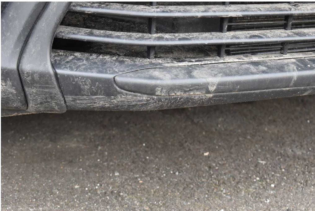
Bild 16 Fahrzeugfront Stoßfänger vorne verkratzt mit Materialabtrag
