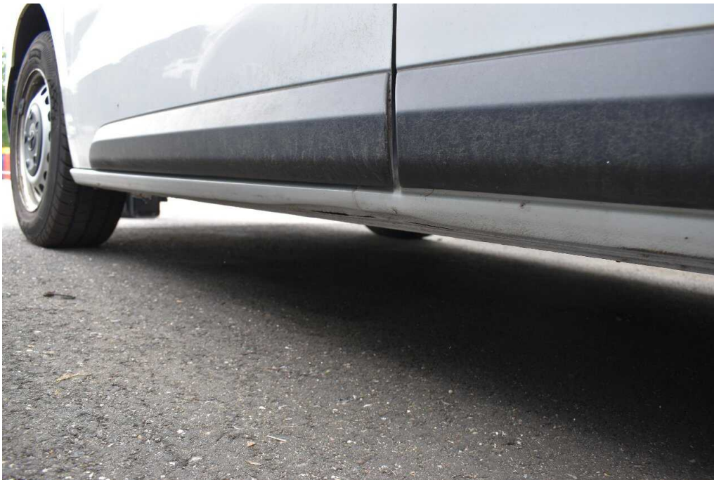
Bild 17 linke Seite Schweller links eingedrückt
