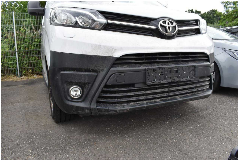
Bild 14 Fahrzeugfront Stoßfänger vorne verkratzt mit Materialabtrag
