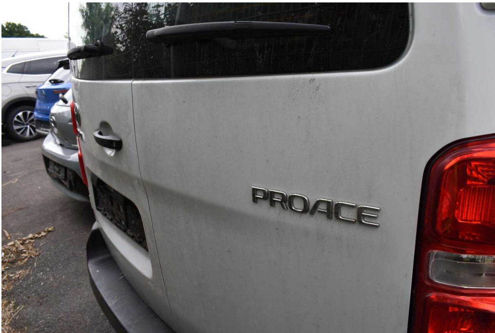
Bild 19 Fahrzeugheck Heckflügeltür rechts Delle
