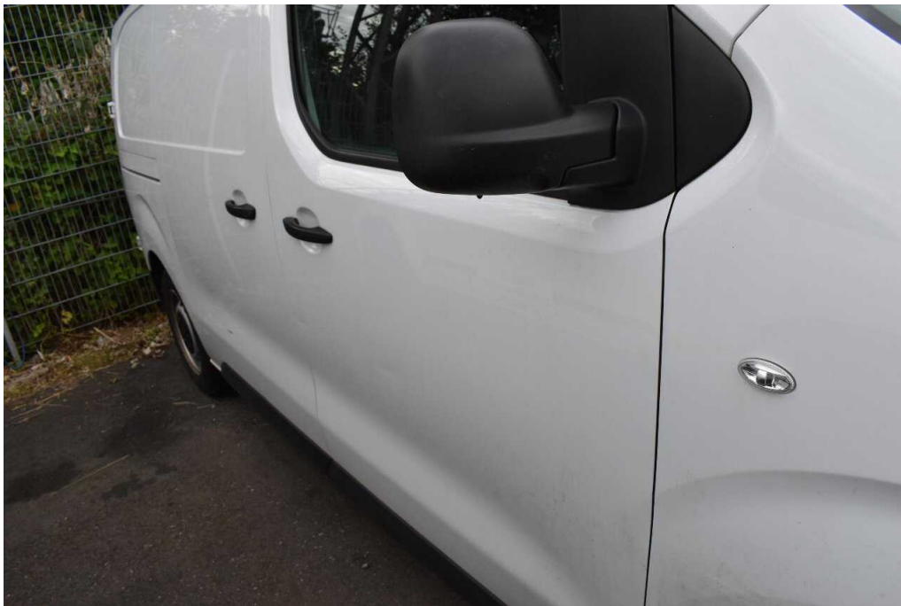
Bild 25 rechte Seite Tür vorne rechts Dellen
