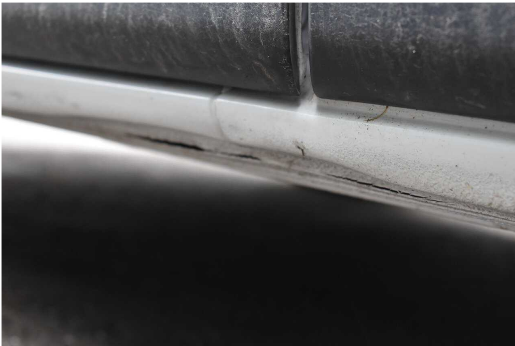
Bild 18 linke Seite Schweller links eingedrückt
