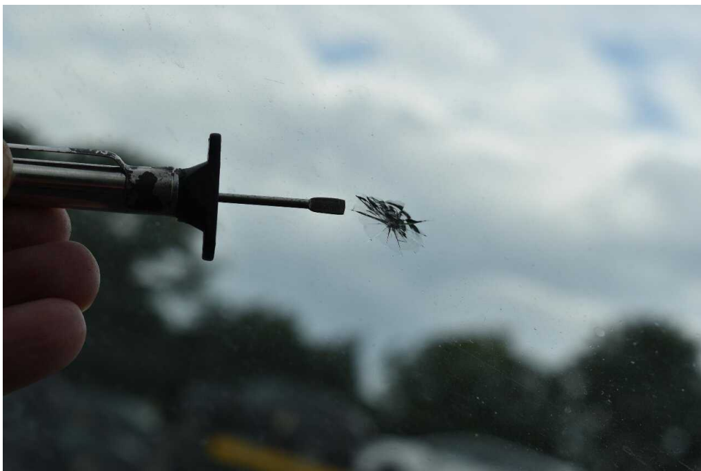
Bild 30 Fahrzeugfront Frontscheibe Steinschlag
