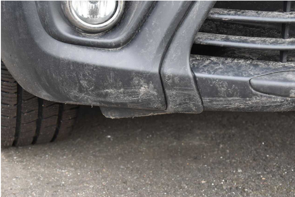
Bild 15 Fahrzeugfront Stoßfänger vorne verkratzt mit Materialabtrag
