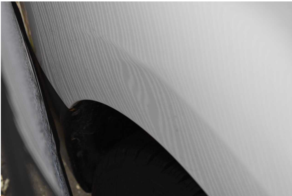
Bild 24 rechte Seite Seitenwand hinten rechts Dellen
