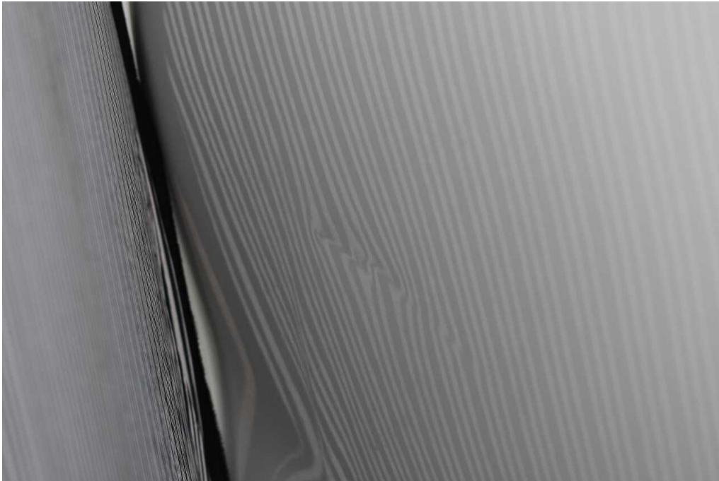
Bild 27 rechte Seite Tür vorne rechts Dellen
