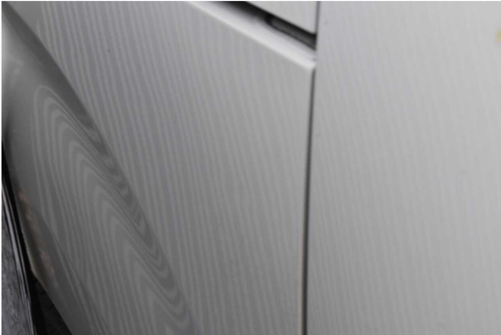
Bild 23 rechte Seite Seitenwand hinten rechts Dellen
