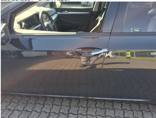
Beschädigung #2: Tür vorn links: Griff außen - Delle / Lackschaden - Smart Repair
