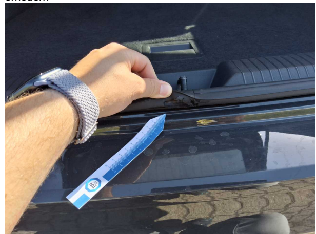
Beschädigung #3: Heckklappe/-tür: Dichtung - beschädigt - erneuern
