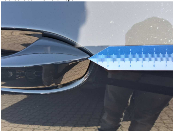
Beschädigung #1: Tür hinten rechts: Griff außen - Delle / Lackschaden - Smart Repair
