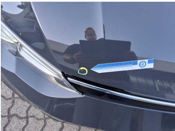
Beschädigung #6: Motorhaube: Motorhaube - Kratzer - lackieren
