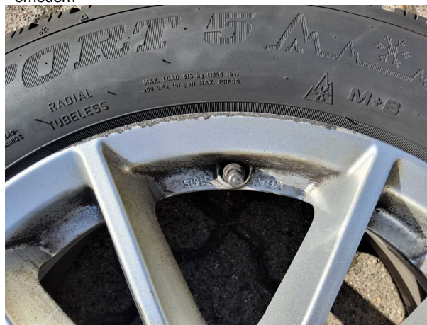
Beschädigung #5: 2.Radsatz: 1 Leichtmetallfelge - beschädigt - erneuern
