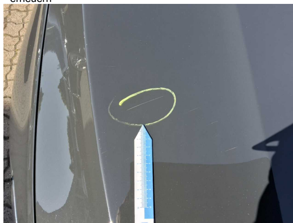
Beschädigung #6: Motorhaube: Motorhaube - Kratzer - lackieren
