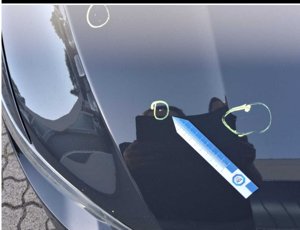
Beschädigung #6: Motorhaube: Motorhaube - Kratzer - lackieren
