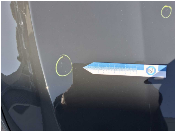
Beschädigung #6: Motorhaube: Motorhaube - Kratzer - lackieren
