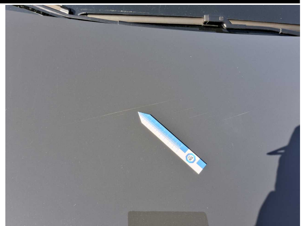
Beschädigung #6: Motorhaube: Motorhaube - Kratzer - lackieren
