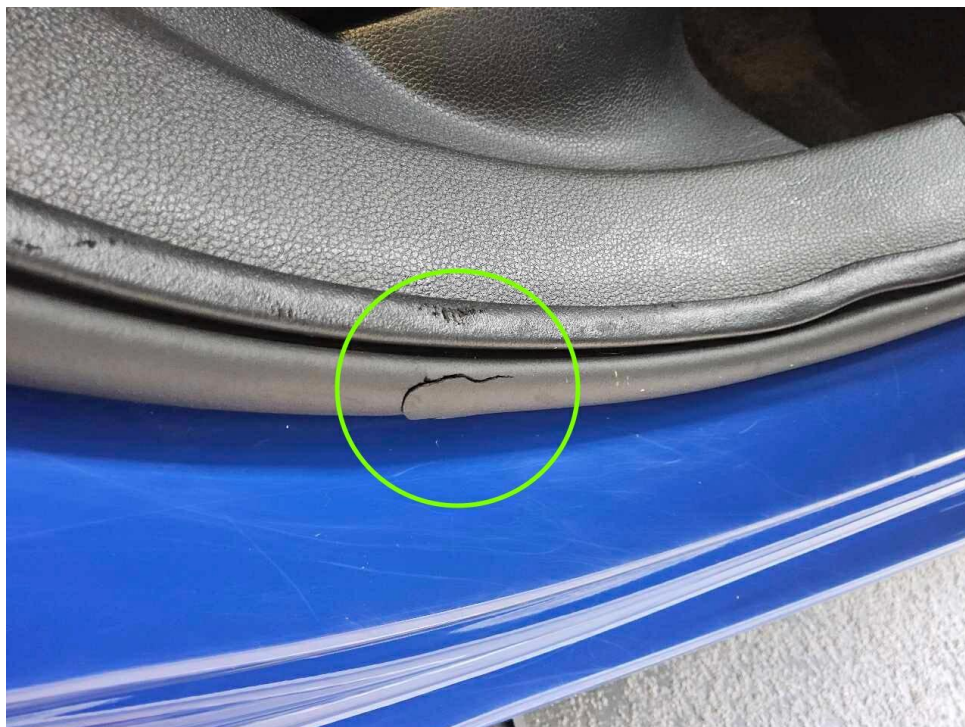
Bild 16 : Tüрдichtung hinten rechts eingerissen
