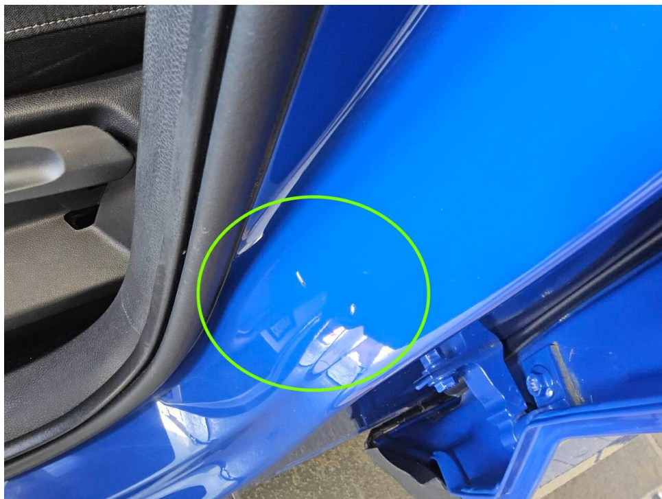
Bild 18 : Tür vorne links Einstieg, verschrammt, smart repair
