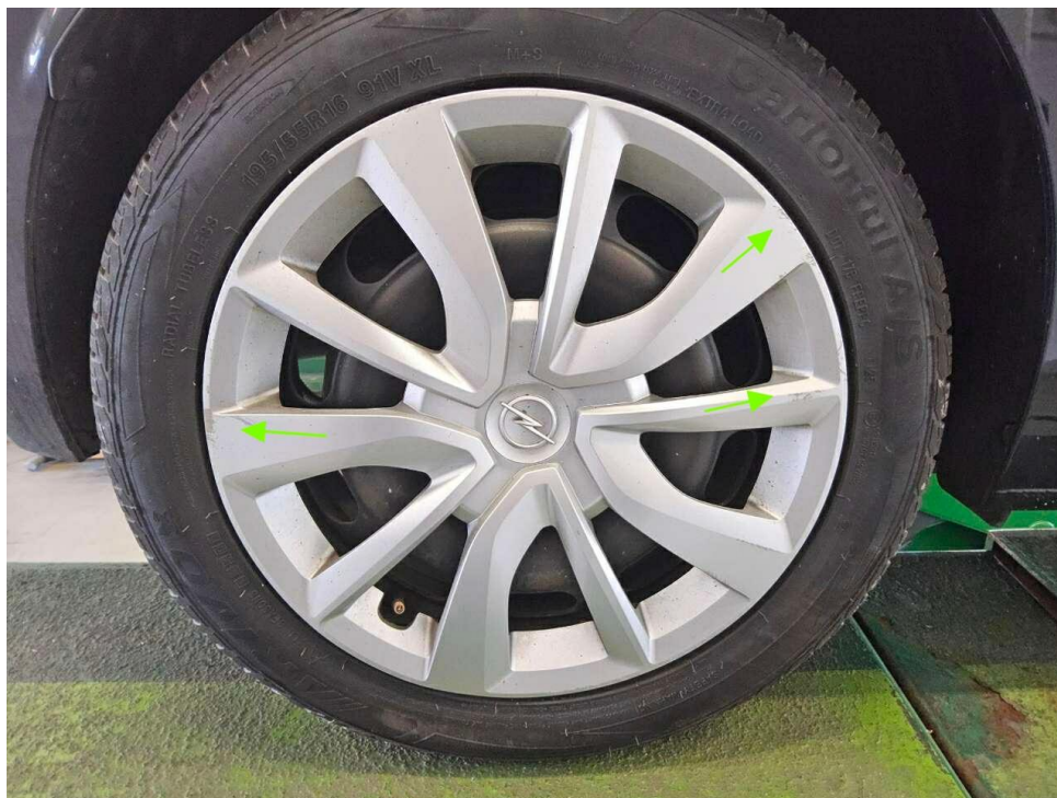
Bild 15 : Felge hinten rechts Radzierdeckel, verschrammt, erneuern
