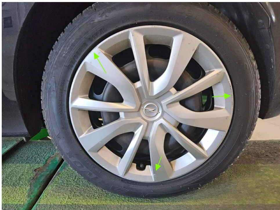
Bild 14 : Felge hinten links Radzierdeckel, verschrammt, erneuern
