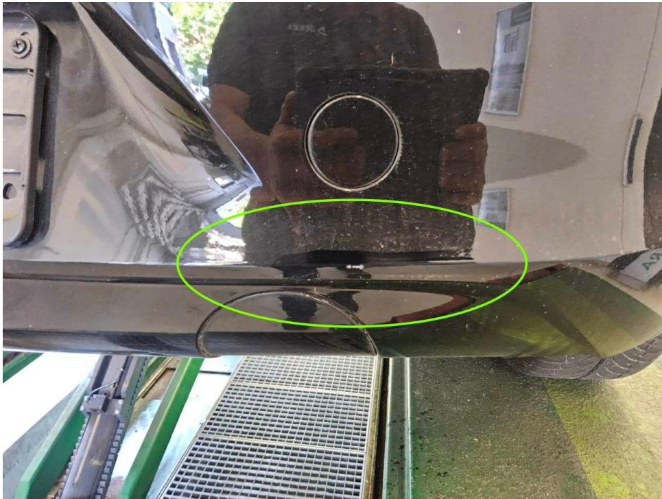
Bild 21 : Stoßfänger hinten Lackierung, verschrammt, lackieren mit Lackaufbau
