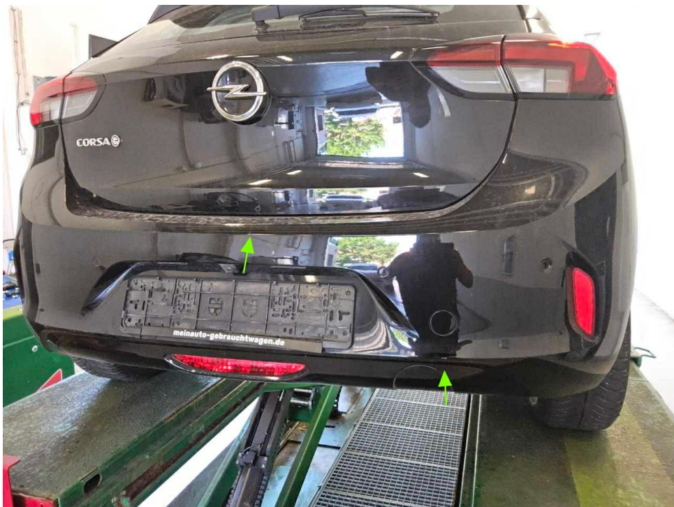
Bild 20 : Stoßfänger hinten Lackierung, verschrammt, lackieren mit Lackaufbau
