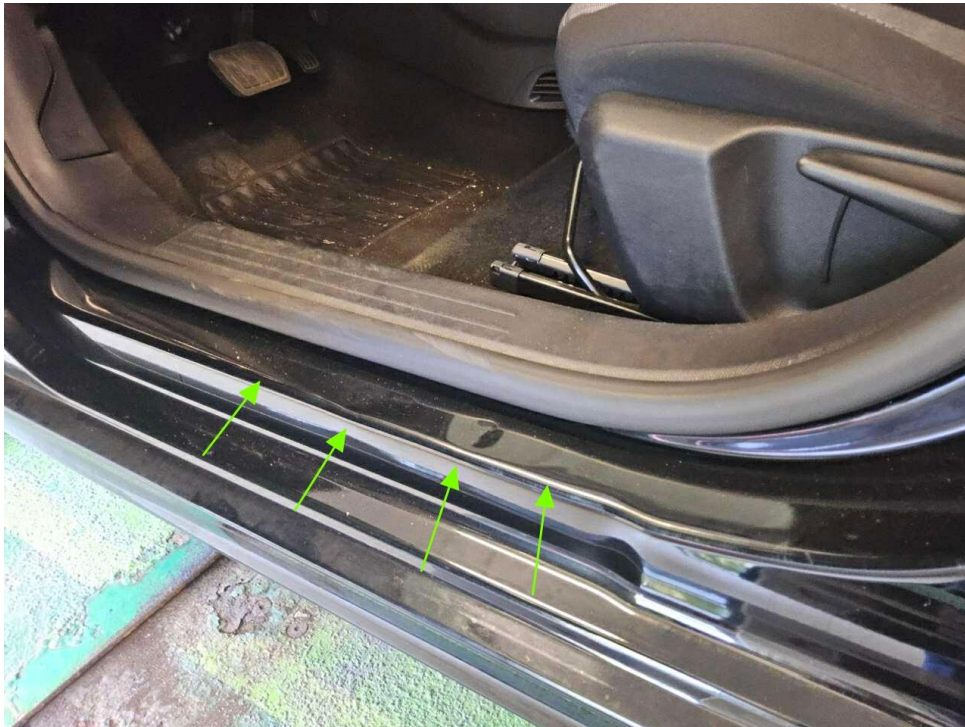
Bild 19 : Tür vorne links Einstieg, deformiert, instandsetzen und lackieren mit Lackaufbau
