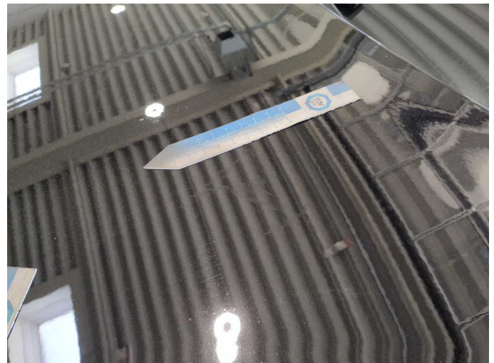
Damage 4: Bonnet: Bonnet (Anätzung) - Paint defect - Paint
