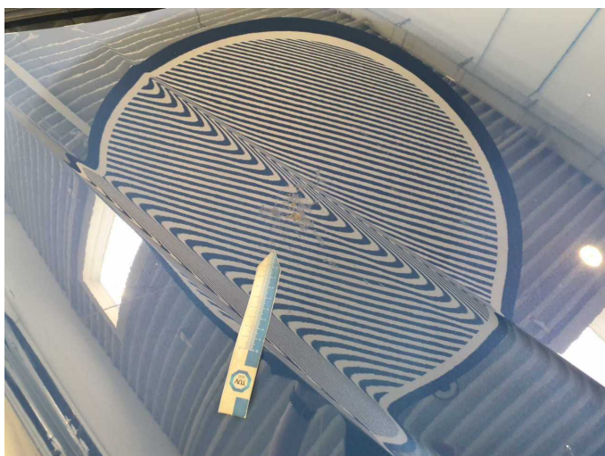
Damage 14: Bonnet: Bonnet (Anätzung) - Paint defect - Paint
