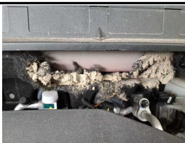
Beschädigung #4: Fahrerhaus: Dämmmatte - Marderschaden - erneuern
