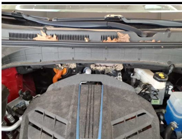
Beschädigung #4: Fahrerhaus: Dämmmatte - Marderschaden - erneuern
