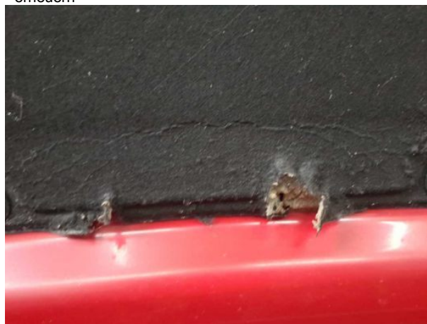
Beschädigung #5: Motorhaube: Dämmmatte - Marderschaden - erneuern
