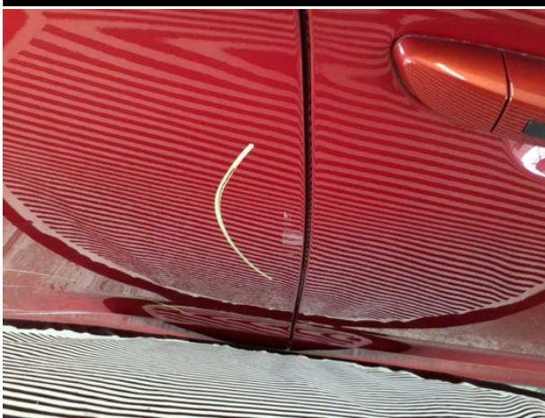
Beschädigung #10: Tür hinten rechts: Tür - Delle / Lackschaden - instandsetzen und lackieren
