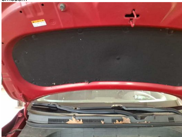
Beschädigung #5: Motorhaube: Dämmmatte - Marderschaden - erneuern
