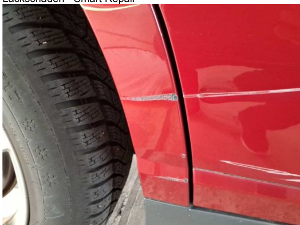
Beschädigung #7: Seitenwand rechts: Radlauf - verkratzt / verschürft - erneuern
