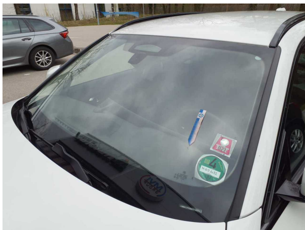
Beschädigung 5: Verglasung: Frontscheibe - gebrochen / geriss... - erneuern
