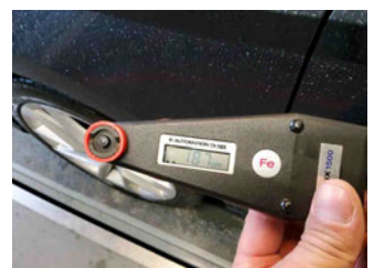
Lackstärke Kotflügel vorne links
