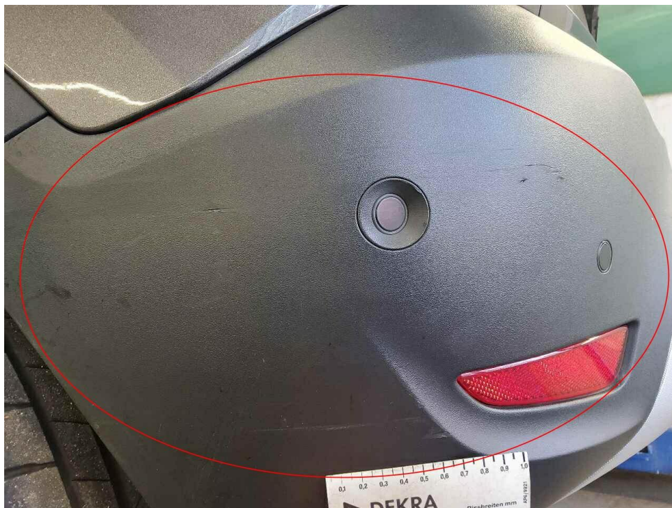
Bild 19 : Schaden Stoßfänger hinten links
