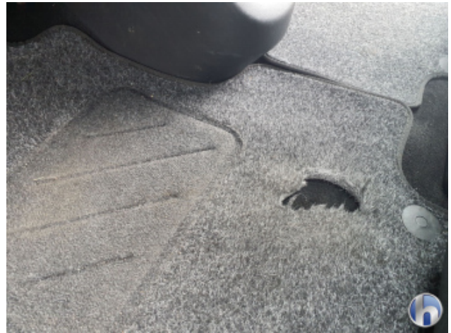
6. Fußraum Innenraum links vorne Loch - Erneuern
