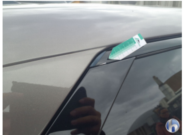
1. Seitenscheibe - Hinten - Links Kratzer - Erneuern
