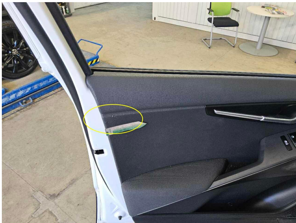
Bild 18 : Türverkleidung vorne links eingekerbt
