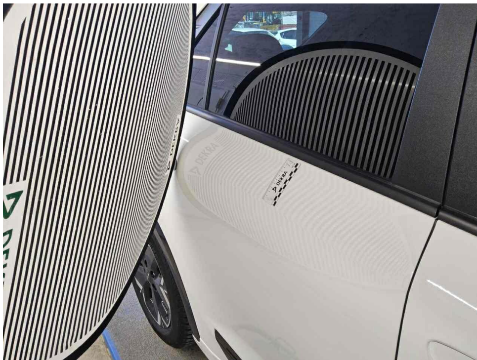
Bild 13 : Tür hinten rechts, eingedellt, Gebrauchsspur
