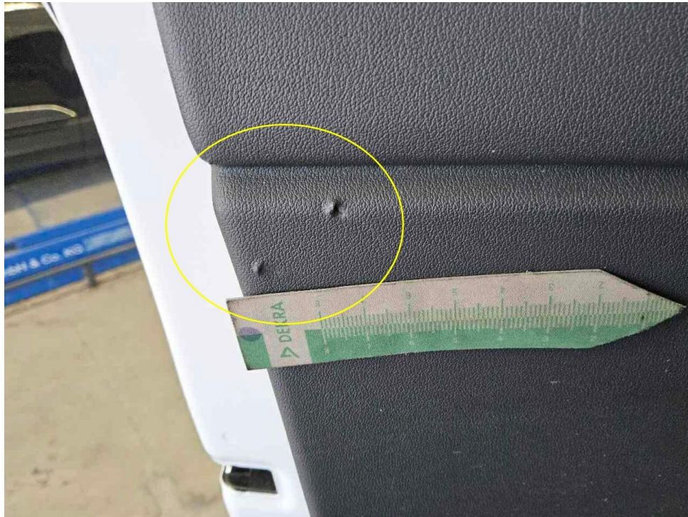
Bild 17 : Türverkleidung vorne links eingekerbt
