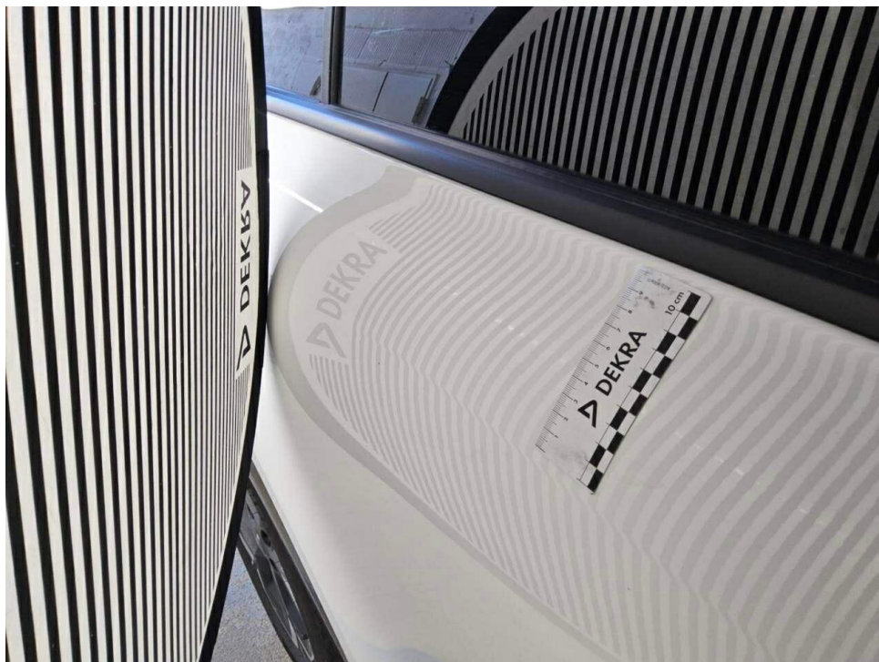
Bild 14 : Tür hinten rechts, eingedellt, Gebrauchsspur
