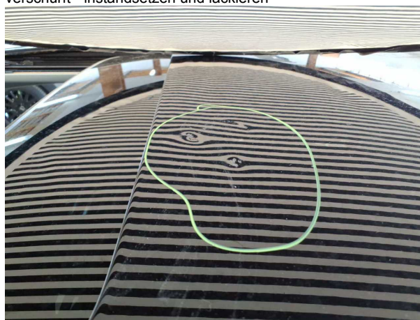
Beschädigung #9: Fahrzeugdach: Dach - Delle / Lackschaden - instandsetzen und lackieren
