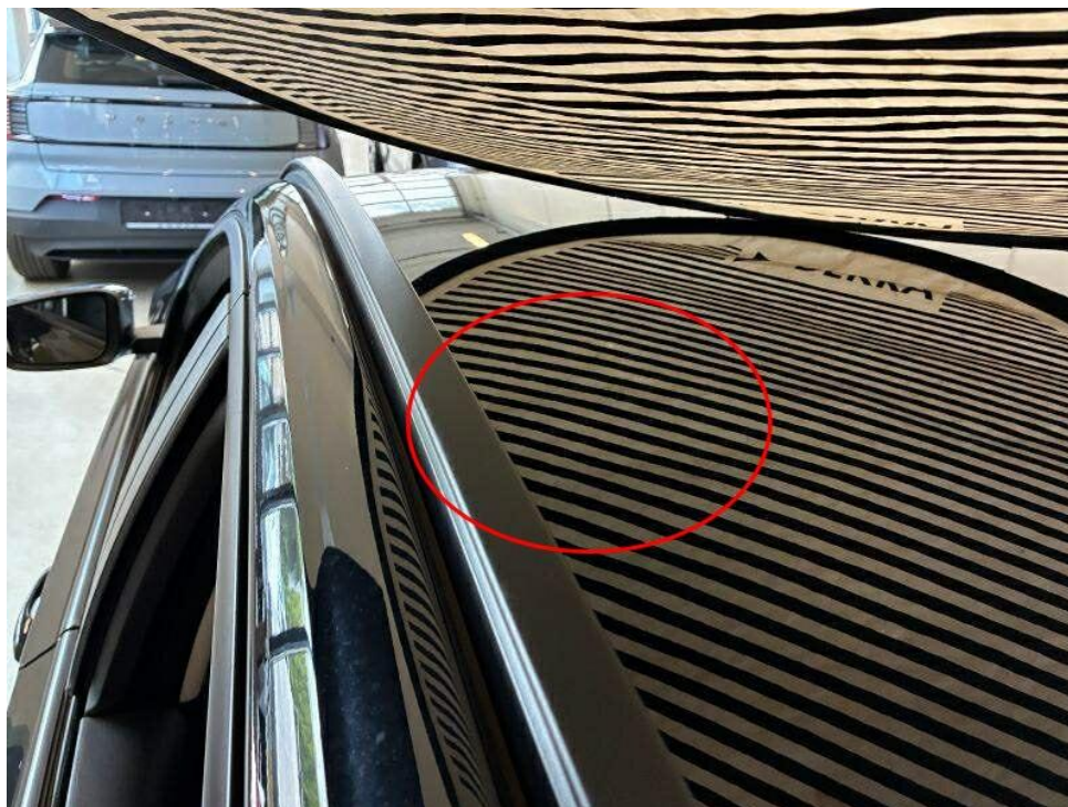
Bild 17 : Dach + Dachrahmen links + rechts Dellen
