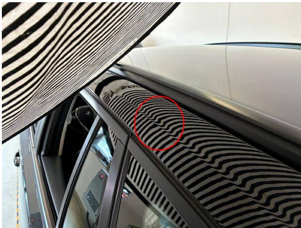
Bild 15 : Dach + Dachrahmen links + rechts Dellen
