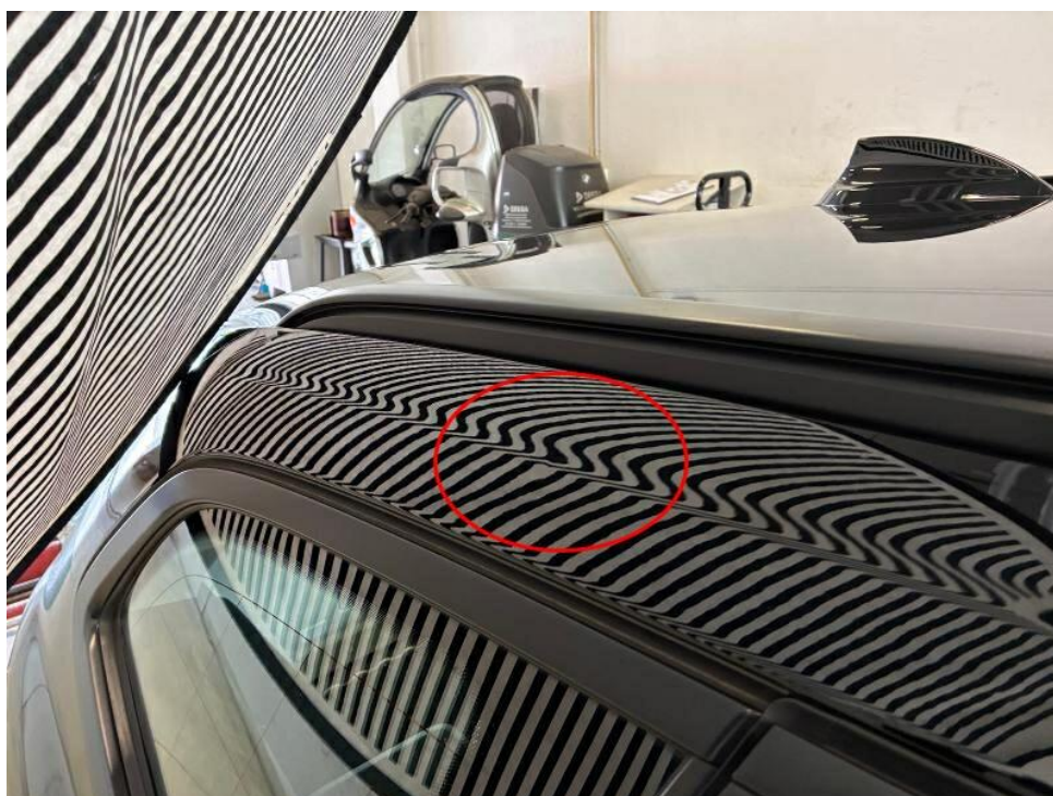
Bild 16 : Dach + Dachrahmen links + rechts Dellen
