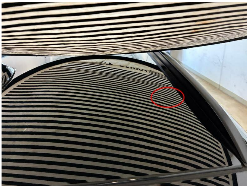
Bild 18 : Dach + Dachrahmen links + rechts Dellen
