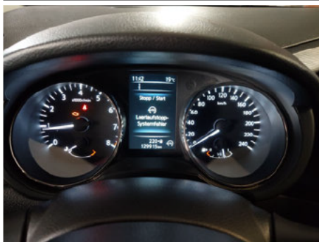
Warnleuchte Motor / Defekt
