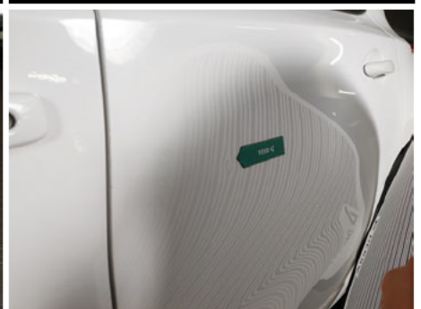
Tür / Hinten Links / Delle
