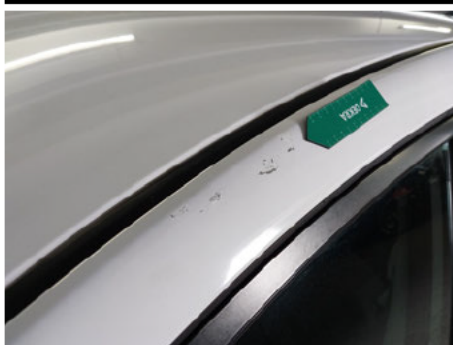
Dachholm / Links / Abgewetzt
