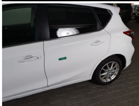
Tür / Hinten Links / Delle
