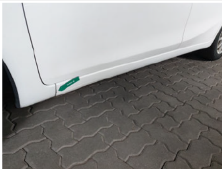
Schweller / Links / Rost
