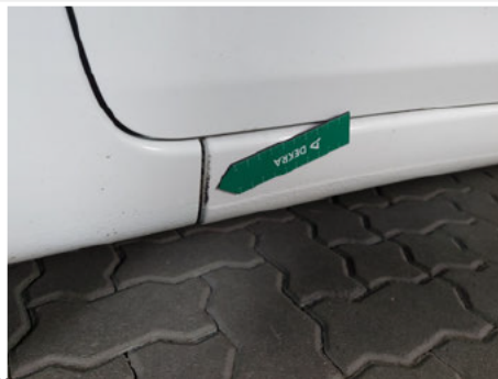
Schweller / Links / Rost
