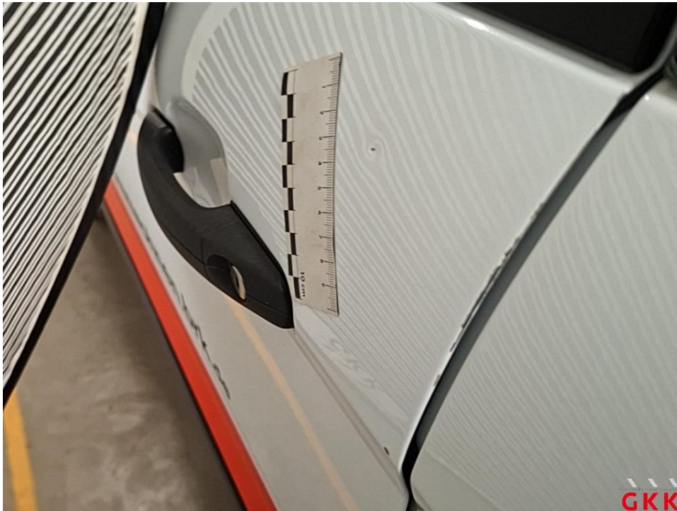
Bild 33 Tür vorne links, beschädigt, instand setzen - lackieren
