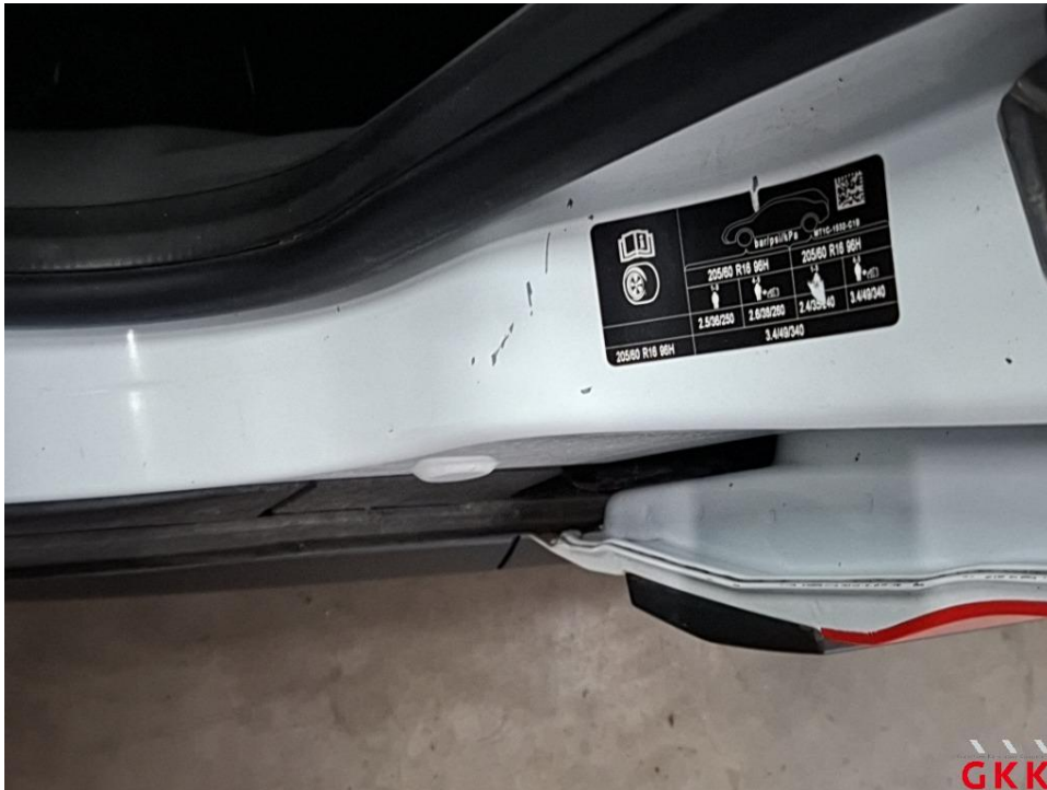
Bild 41 Tür vorne links, Einstieg, beschädigt, instand setzen - lackieren
