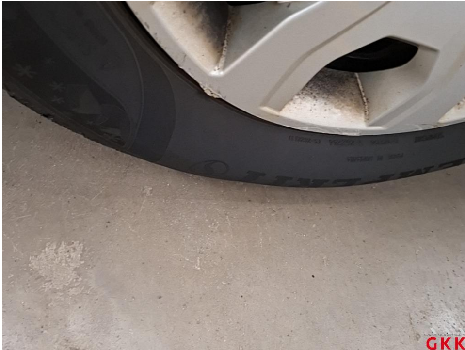
Bild 43 Radkappe(n), vorne links, beschädigt, ersetzen
