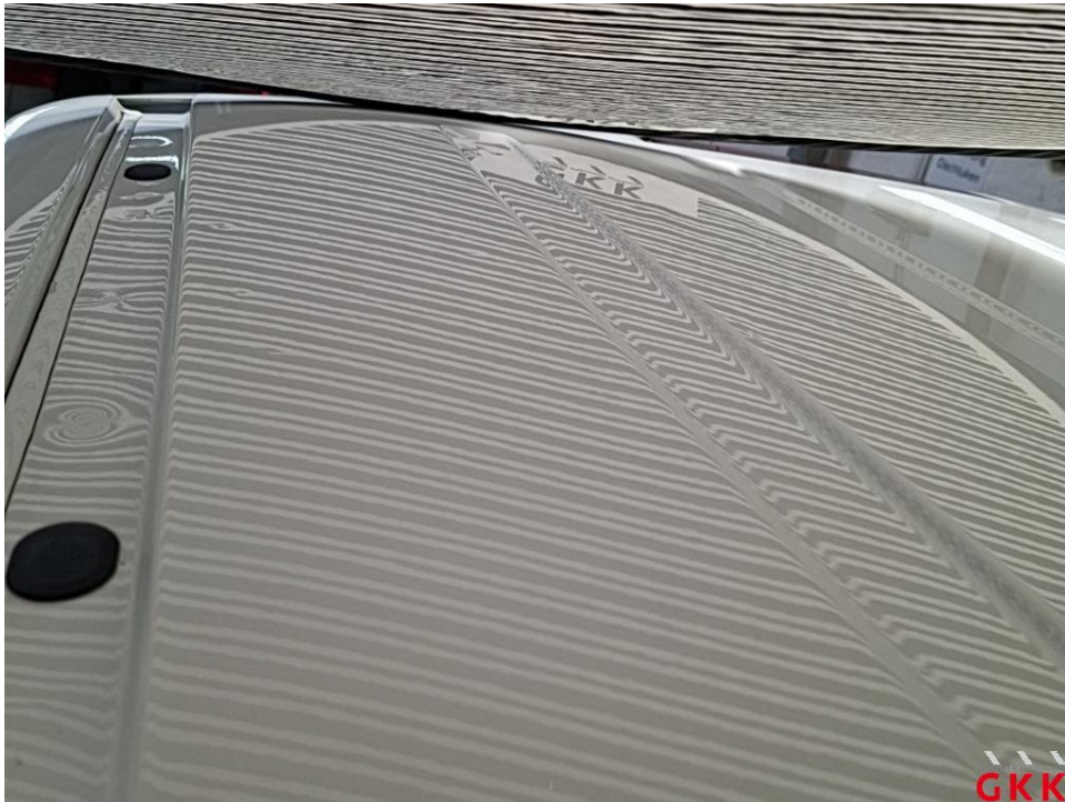
Bild 29 Fahrzeug, Hagelschaden, kalt drücken
