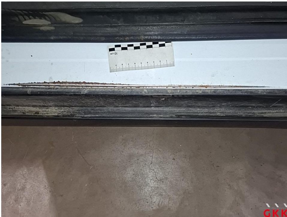
Bild 40 Tür vorne links, Einstieg, beschädigt, instand setzen - lackieren
