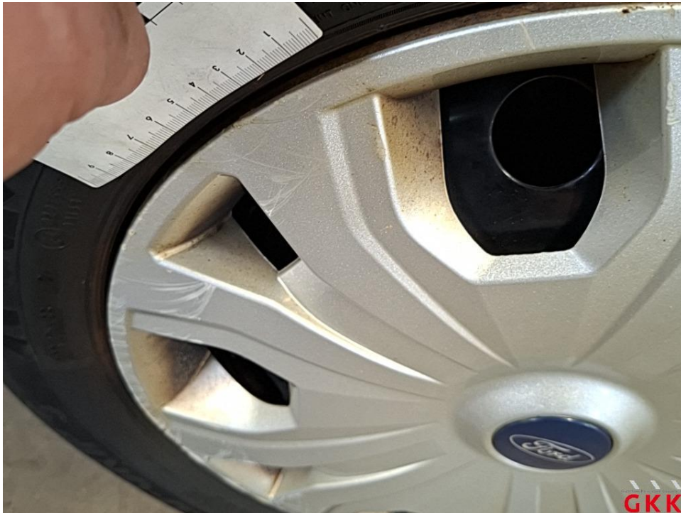
Bild 21 Radkappe(n), vorne rechts, beschädigt, ersetzen
