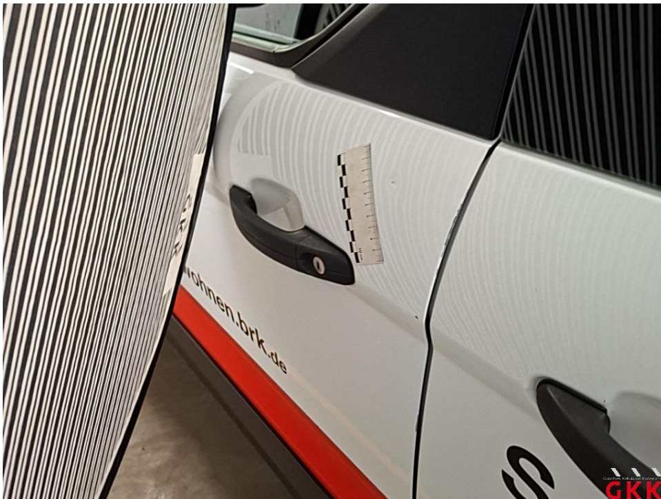
Bild 32 Tür vorne links, beschädigt, instand setzen - lackieren
