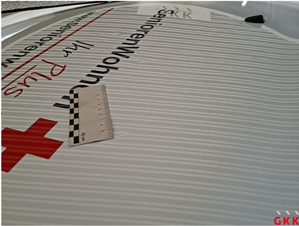
Bild 25 Fahrzeug, Hagelschaden, kalt drücken
