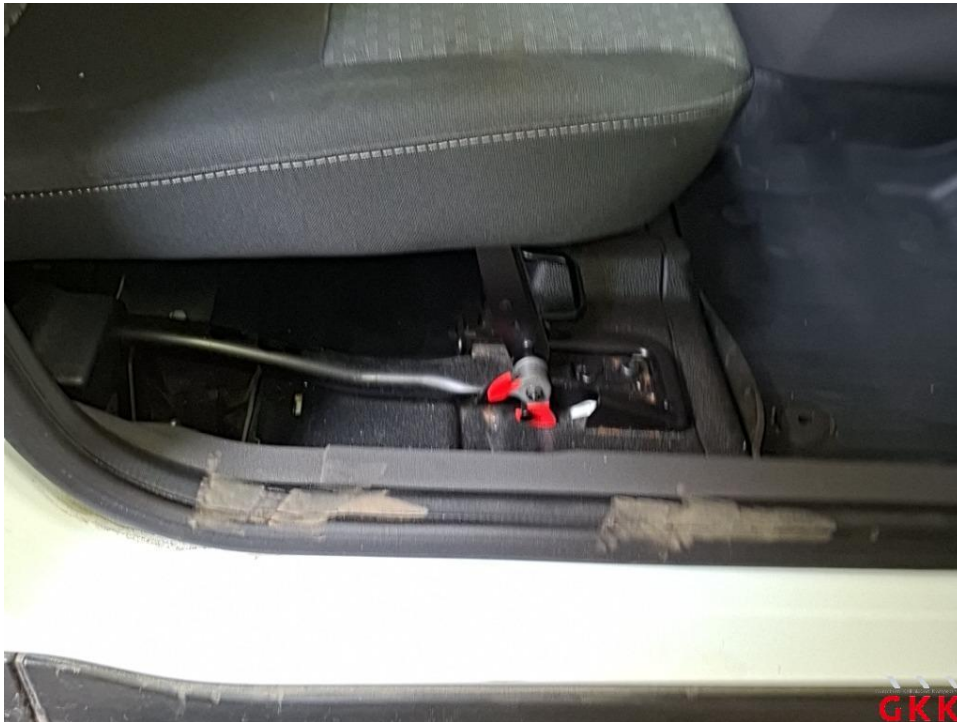
Bild 61 Sitz vorne rechts, Verkleidung, fehlt, ersetzen
