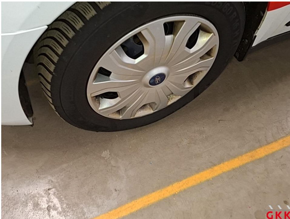
Bild 42 Radkappe(n), vorne links, beschädigt, ersetzen
