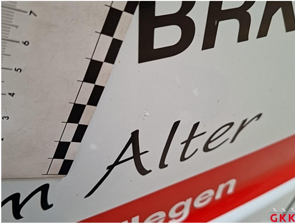
Bild 47 Hecktür links, korrodiert, lackieren
