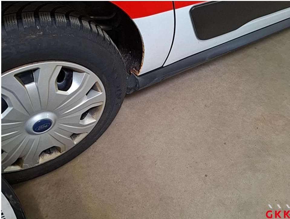
Bild 56 Seitenwand rechts, unterhalb, korrodiert, lackieren
