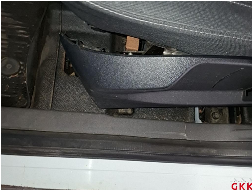
Bild 35 Sitz vorne links, Verkleidung, beschädigt, ersetzen
