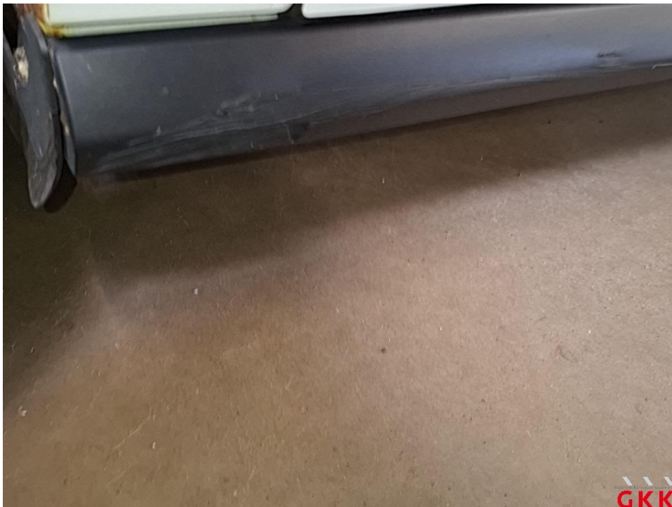
Bild 60 Schweller rechts, Abdeckung -unlackiert-, beschädigt, ersetzen
