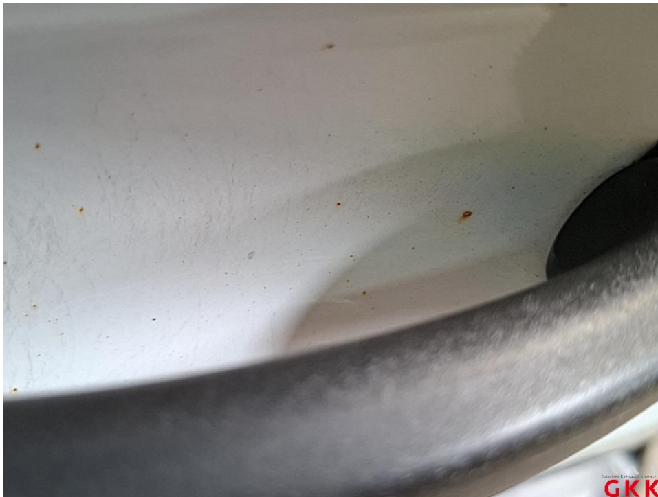
Bild 50 Hecktür rechts, korrodiert, lackieren
