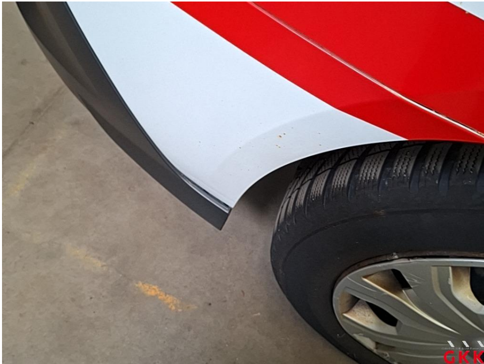
Bild 31 Fahrzeug, außen, Lackierung verwittert / matt, aufbereiten
