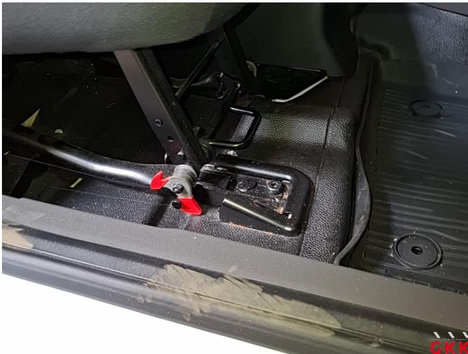
Bild 62 Sitz vorne rechts, Verkleidung, fehlt, ersetzen
