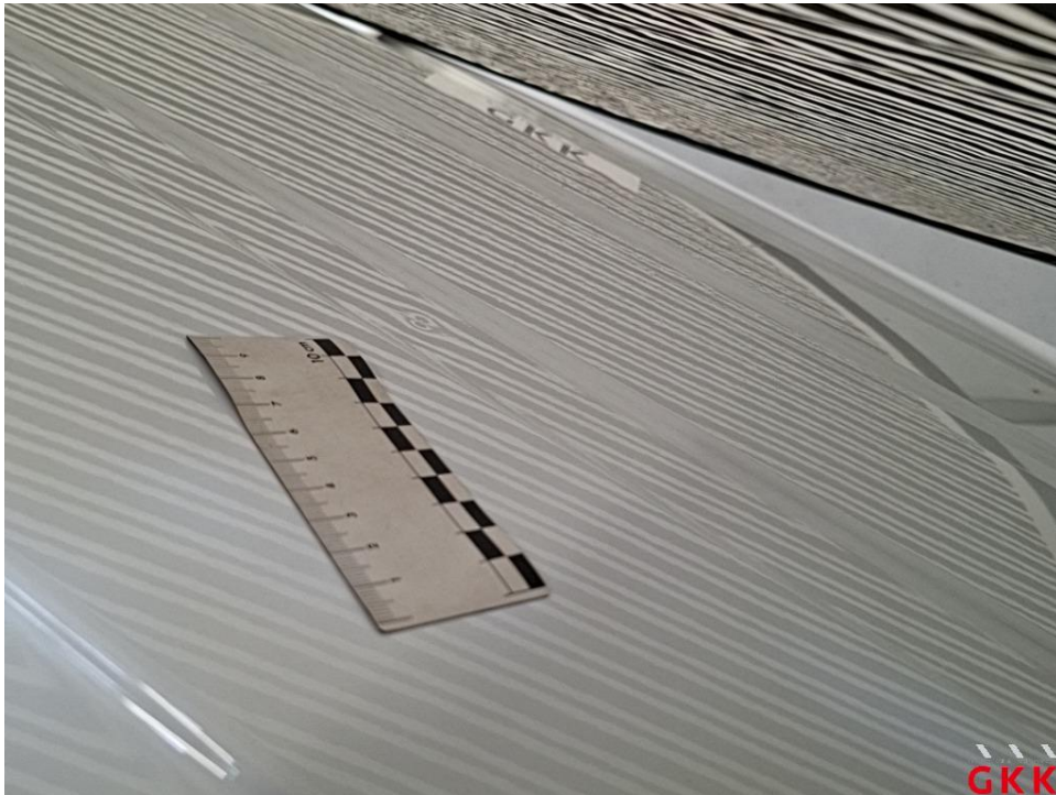
Bild 27 Fahrzeug, Hagelschaden, kalt drücken
