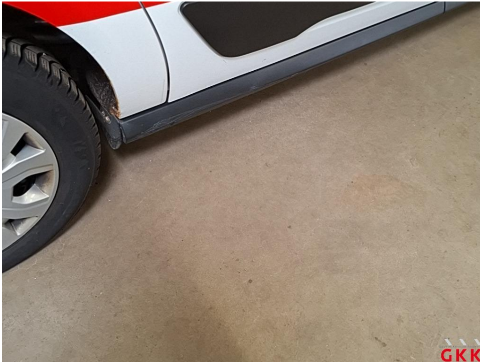
Bild 59 Schweller rechts, Abdeckung -unlackiert-, beschädigt, ersetzen
