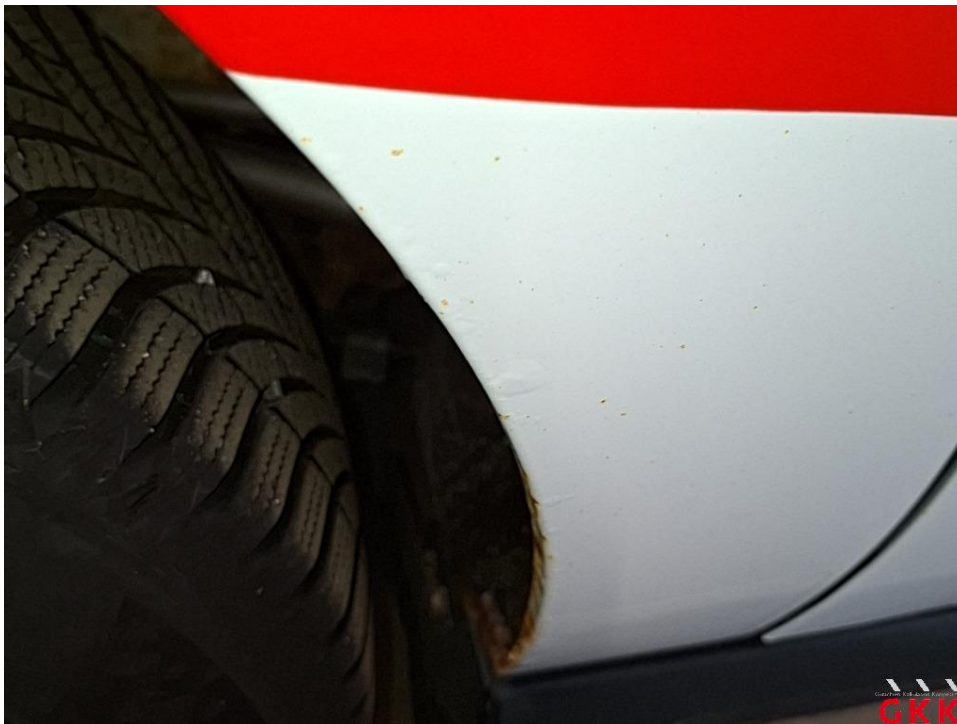
Bild 58 Seitenwand rechts, unterhalb, korrodiert, lackieren
