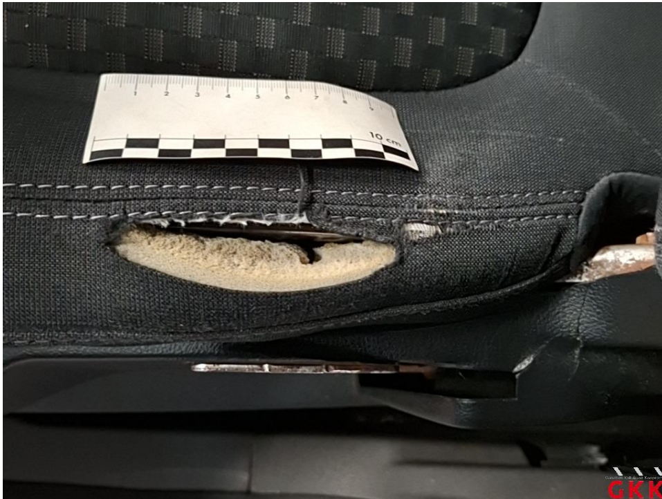
Bild 39 Sitz vorne links, Polster Sitzkissen, beschädigt, ersetzen
