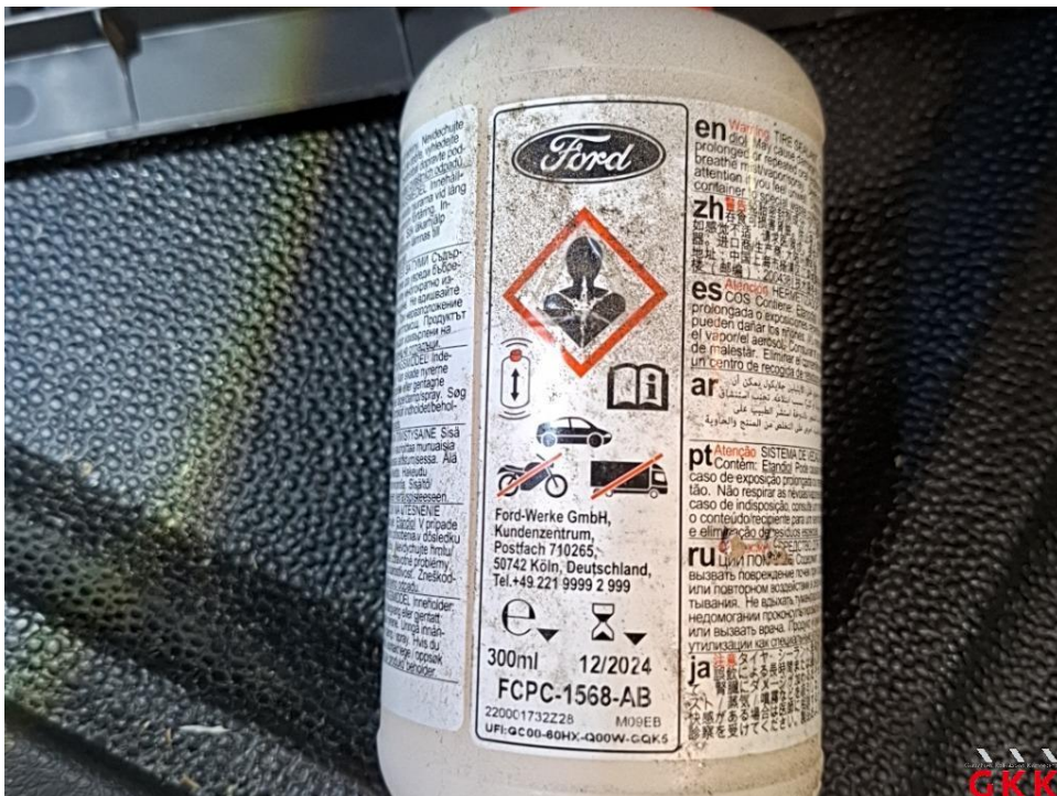
Bild 16 Reifenreparaturset, Füllflasche, MHD überschritten, ersetzen
