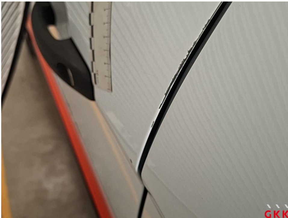
Bild 34 Tür vorne links, beschädigt, instand setzen - lackieren
