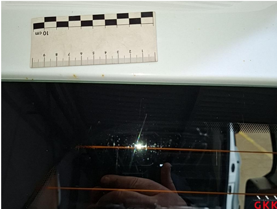
Bild 49 Hecktür rechts, korrodiert, lackieren
