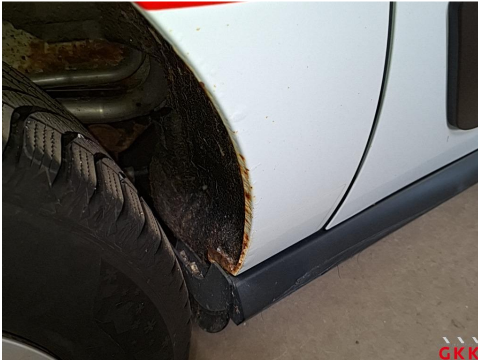
Bild 57 Seitenwand rechts, unterhalb, korrodiert, lackieren
