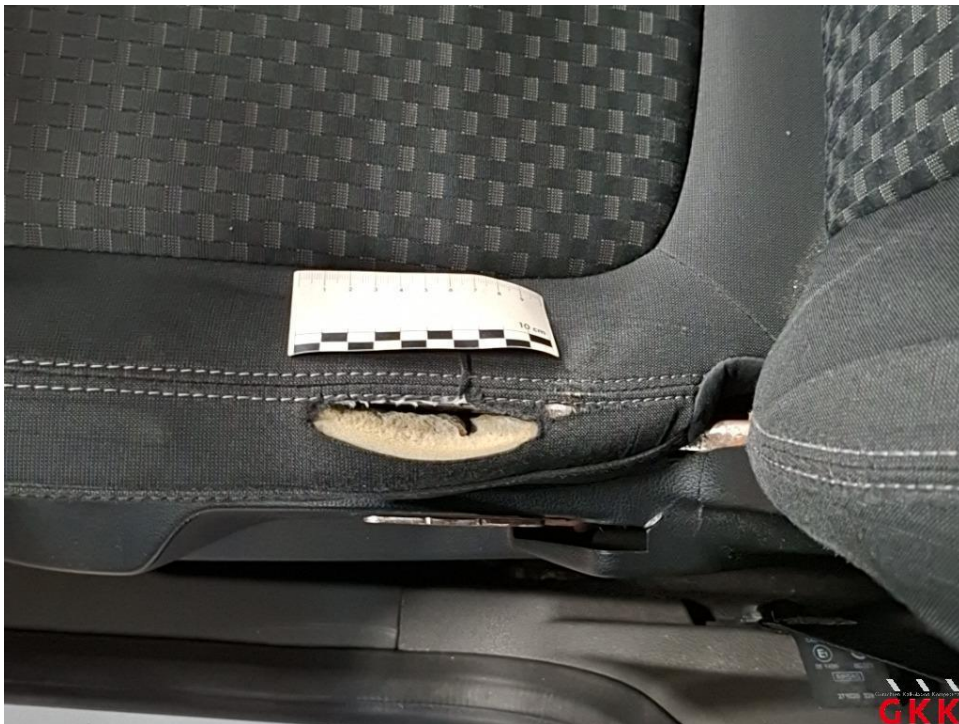
Bild 38 Sitz vorne links, Bezug Sitzkissen -Stoff-, beschädigt, ersetzen
