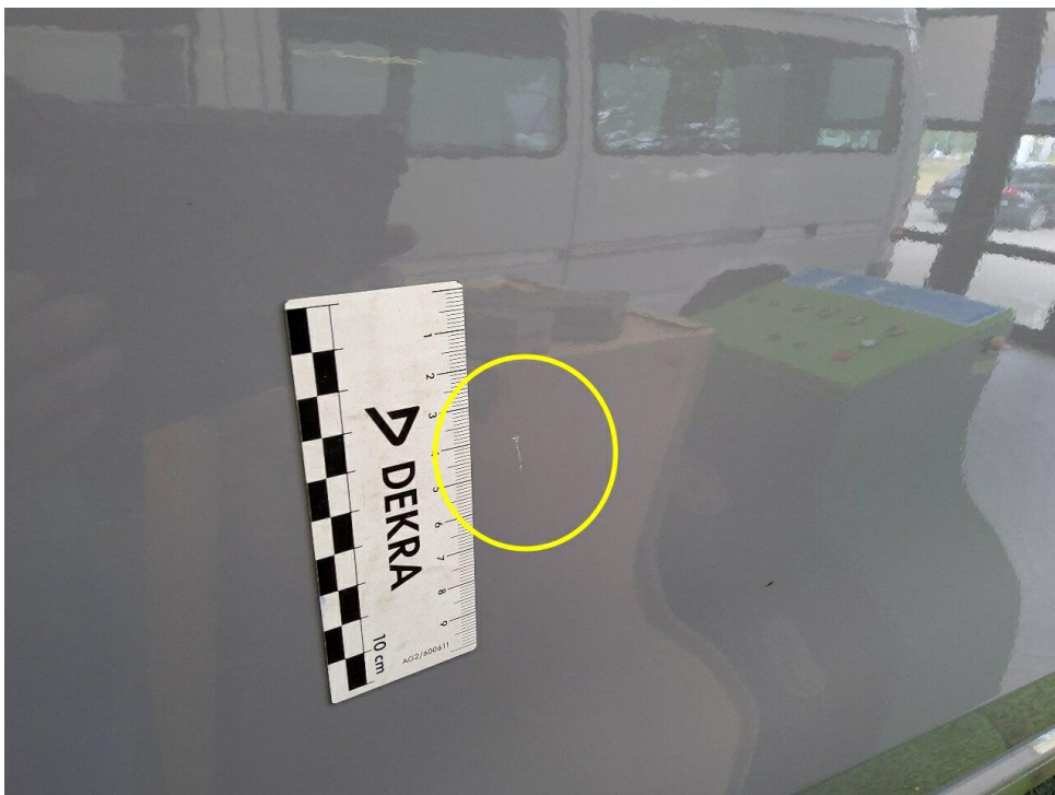
Bild 18 : Tür hinten rechts Lackierung, verschrammt, lackieren mit Lackaufbau
