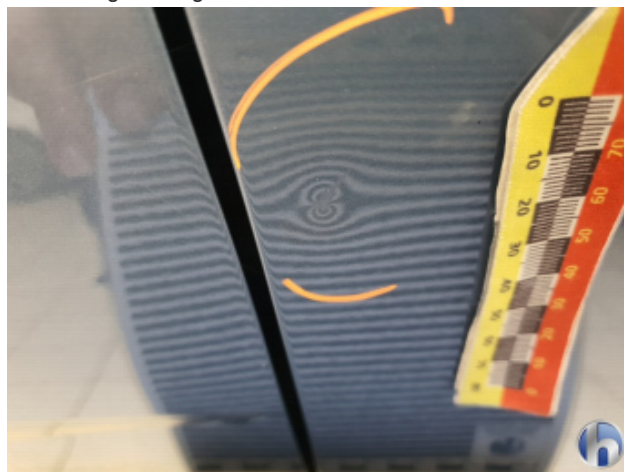
2. Kotflügel Vorne - Rechts 1 Delle - Sanft Instandsetzen
