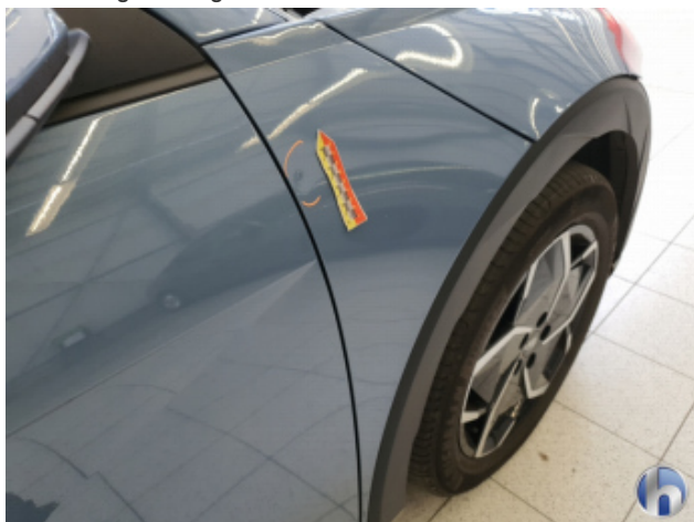
2. Kotflügel Vorne - Rechts 1 Delle - Sanft Instandsetzen
