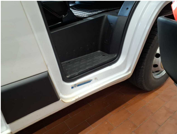
Damage 5: Sill - right side: Sill (Verätzung) - Paint defect - Smart repair
