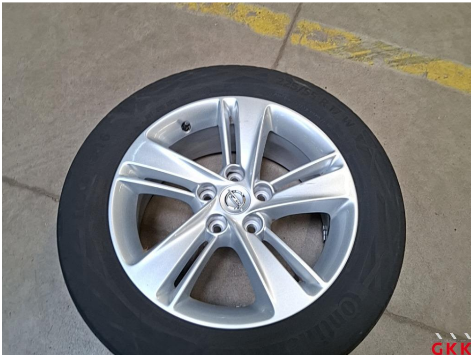
Bild 20 LM-Rad, 1 x beiliegend, verkratzt, Smartrepair
