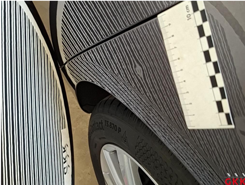
Bild 35 Seitenwand links, unterhalb, beschädigt, Smartrepair
