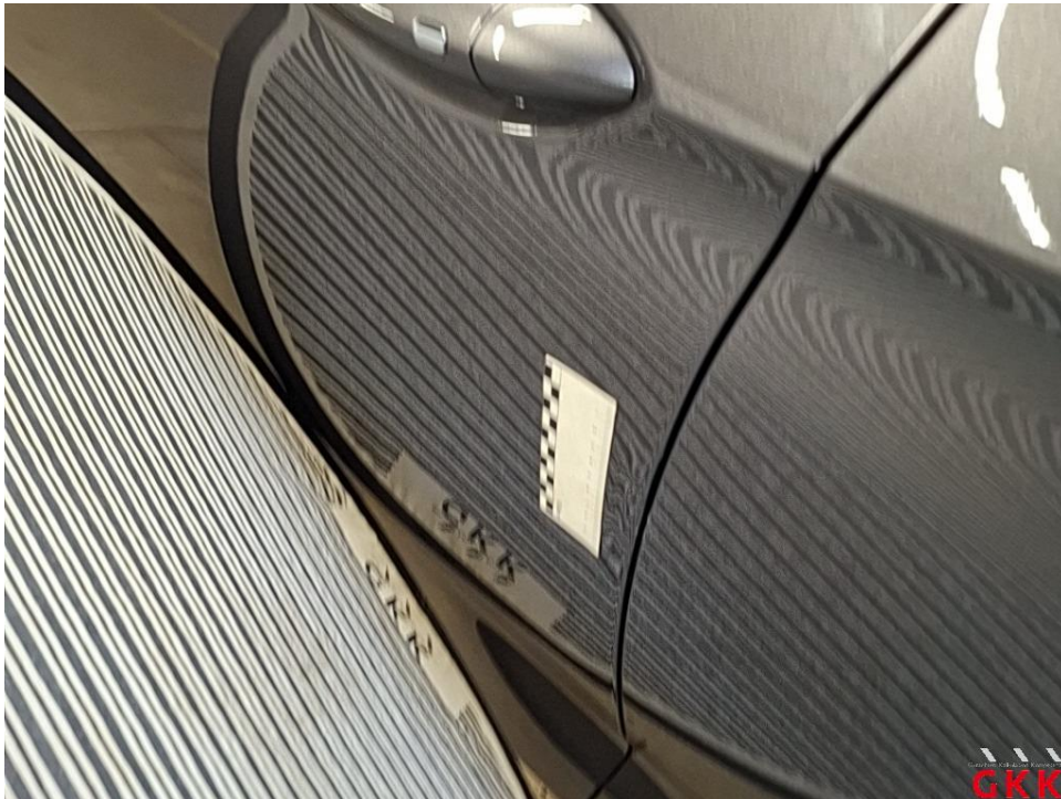
Bild 31 Tür vorne links, beschädigt, instand setzen - lackieren
