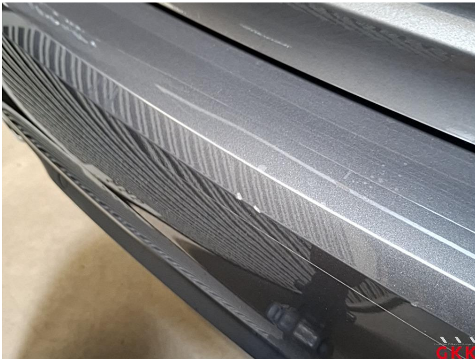
Bild 36 Stoßfänger hinten, Schutzfolie, beschädigt, ersetzen
