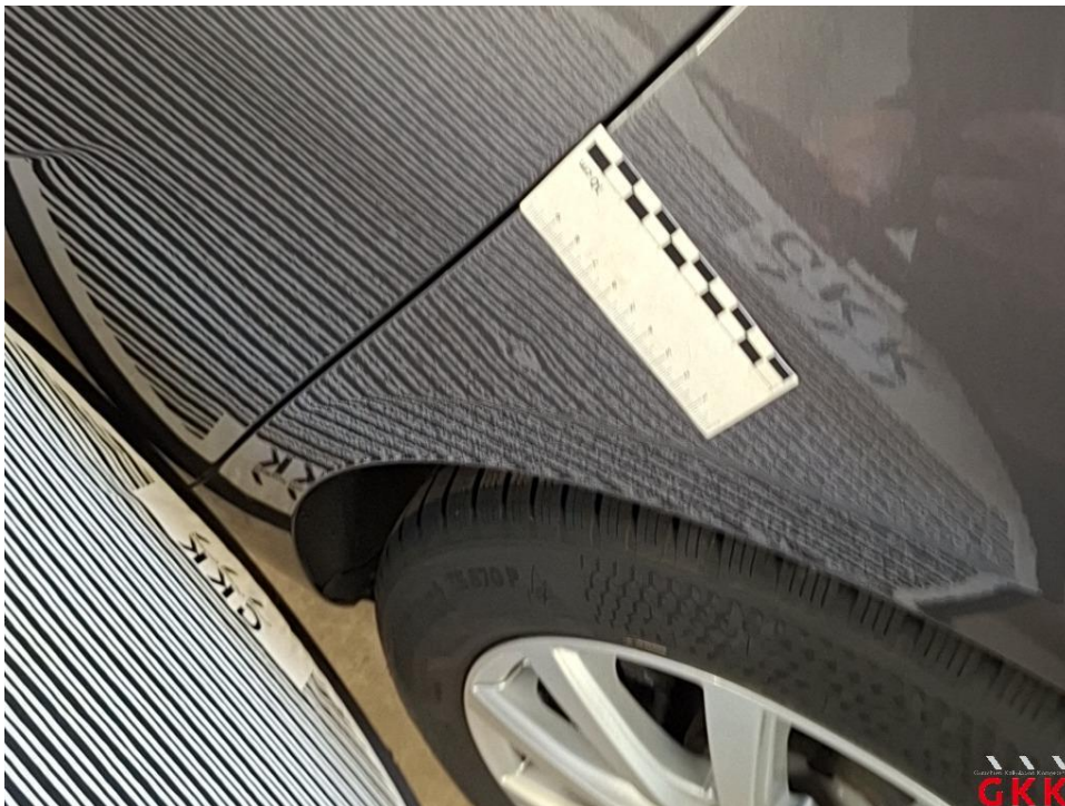
Bild 34 Seitenwand links, unterhalb, beschädigt, Smartrepair
