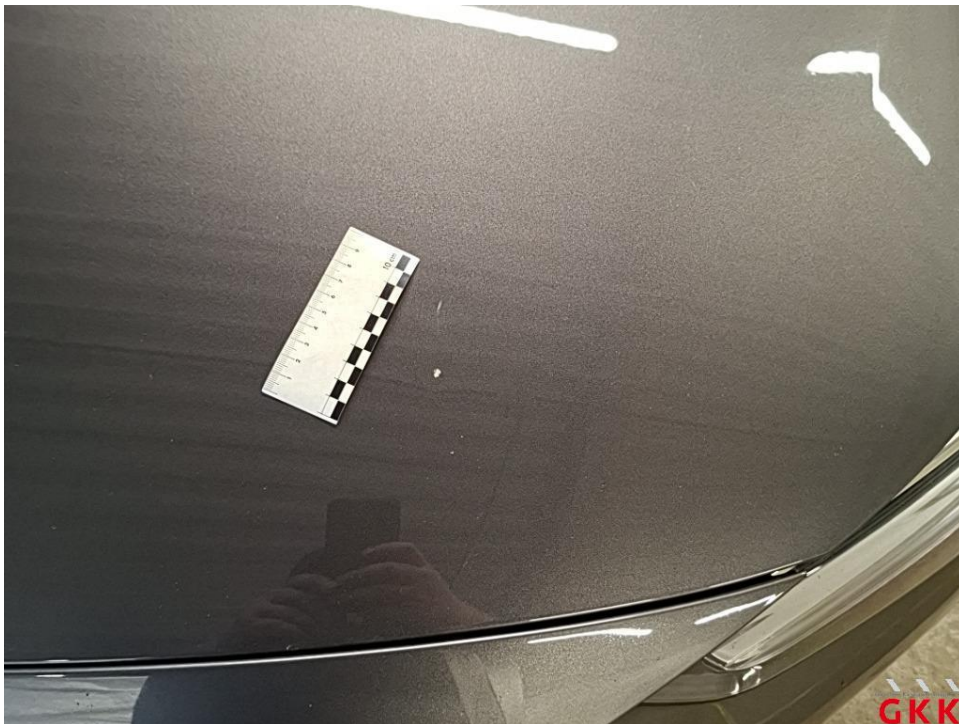
Bild 28 Motorhaube, beschädigt, instand setzen - lackieren
