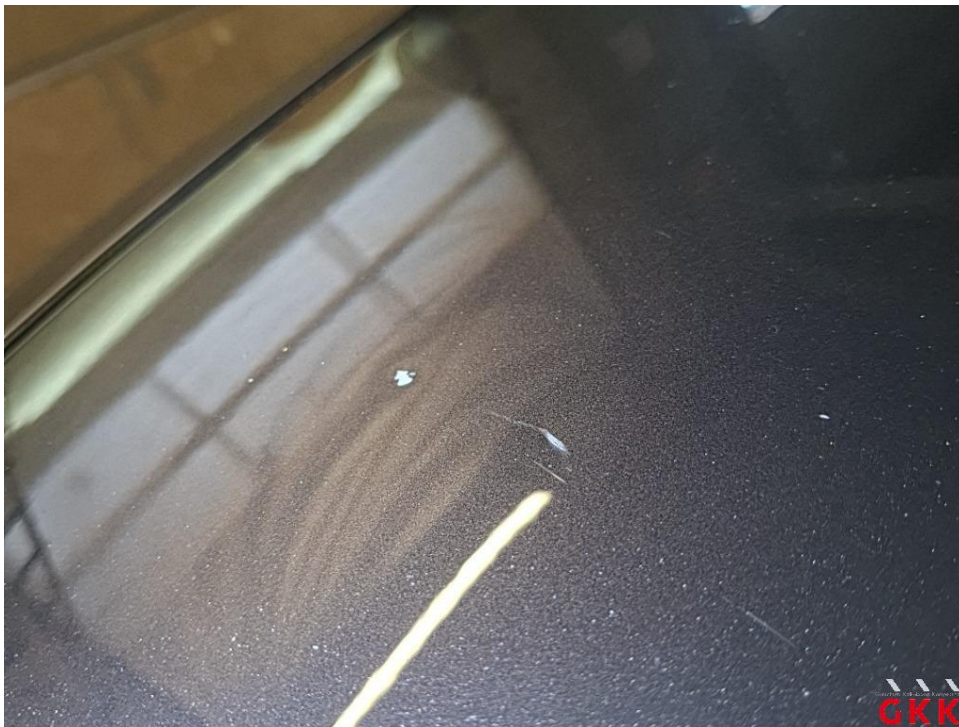
Bild 30 Motorhaube, beschädigt, instand setzen - lackieren
