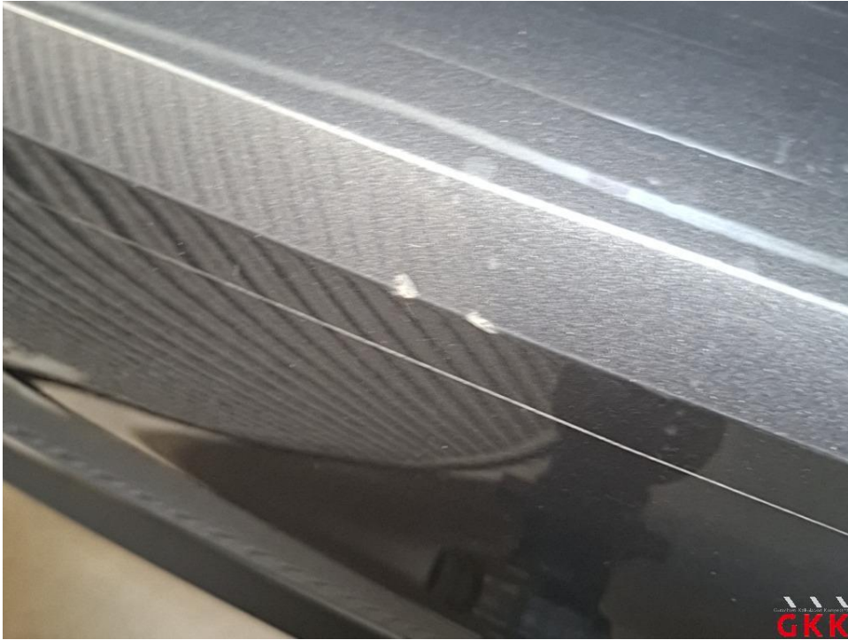
Bild 37 Stoßfänger hinten, Schutzfolie, beschädigt, ersetzen
