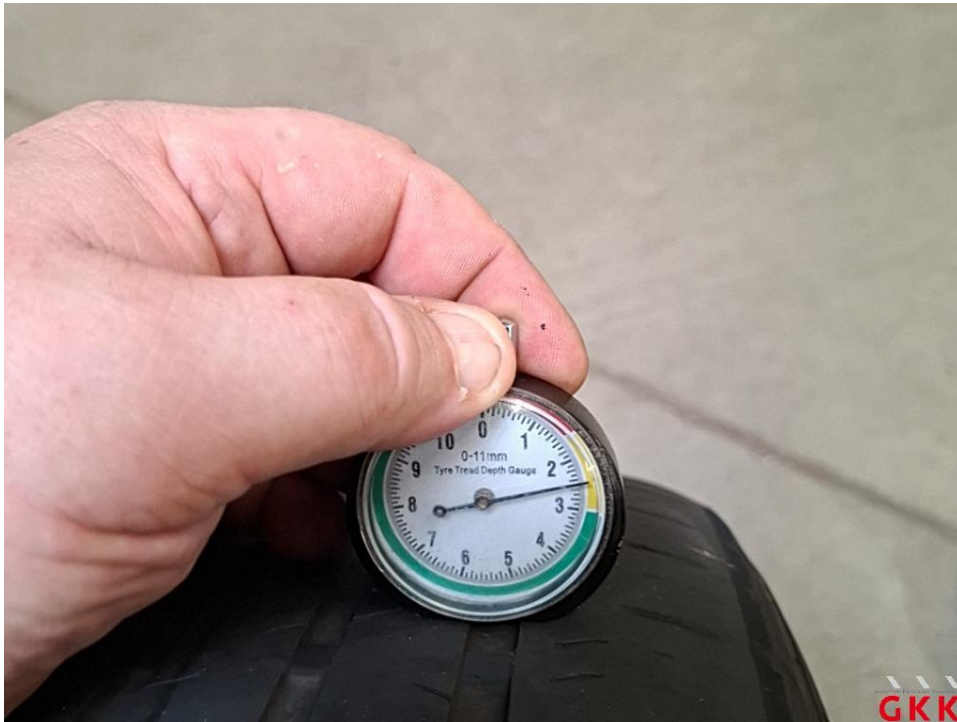
Bild 17 Reifen, 2 x beiliegend, einseitig abgefahren und Untermaß, ersetzen
