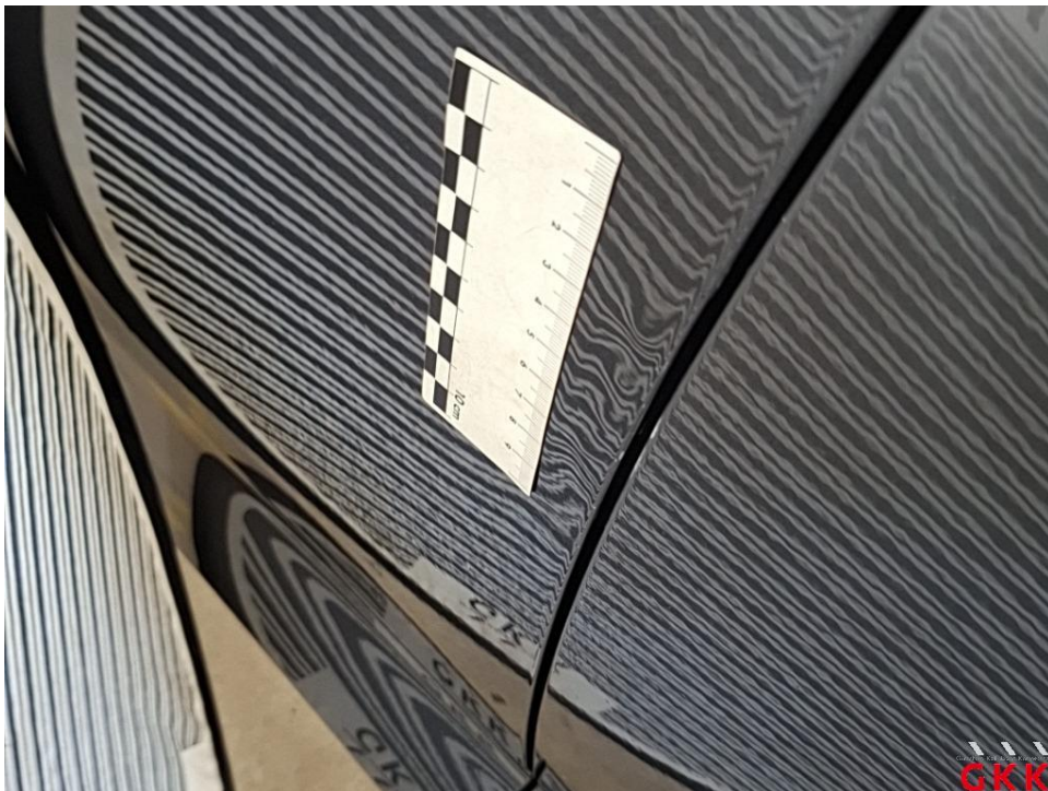
Bild 32 Tür vorne links, beschädigt, instand setzen - lackieren
