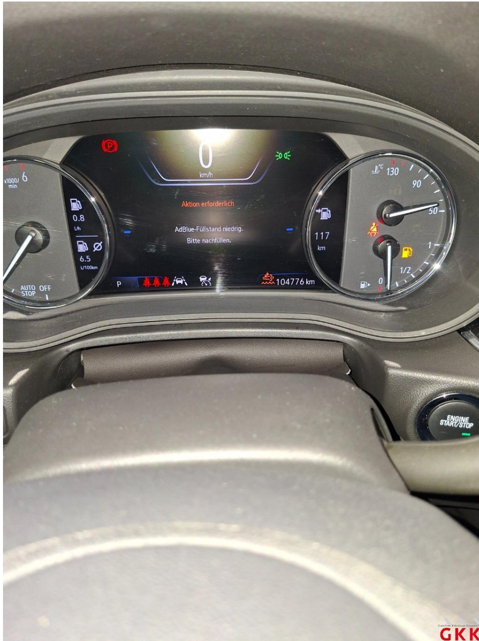
Bild 16 Abgassystem, Additiv AdBlue, Servicehinweis, auffüllen
