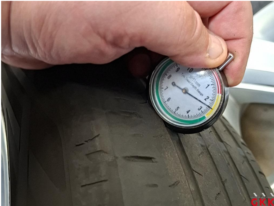
Bild 19 Reifen, 2 x beiliegend, einseitig abgefahren und Untermaß, ersetzen
