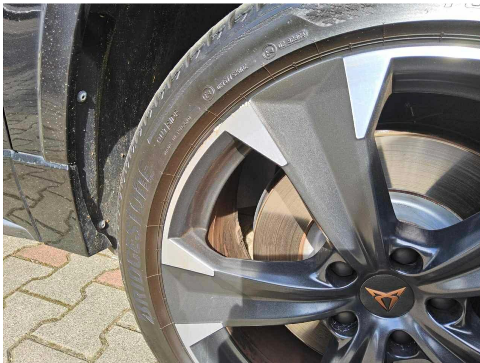
Bild 14 : Felge vorne rechts, zerkratzt, erneuern
