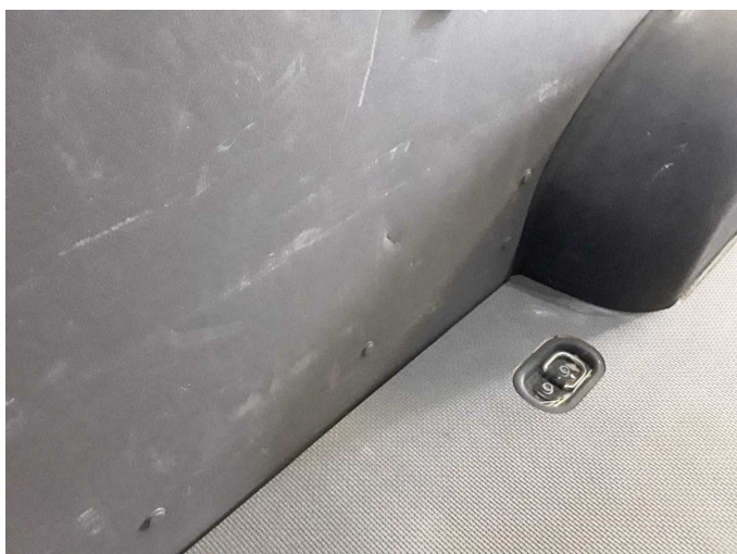
Damage 4: Interior: Interior (Laderaumverkleidungen) - Broken / torn - Replace
