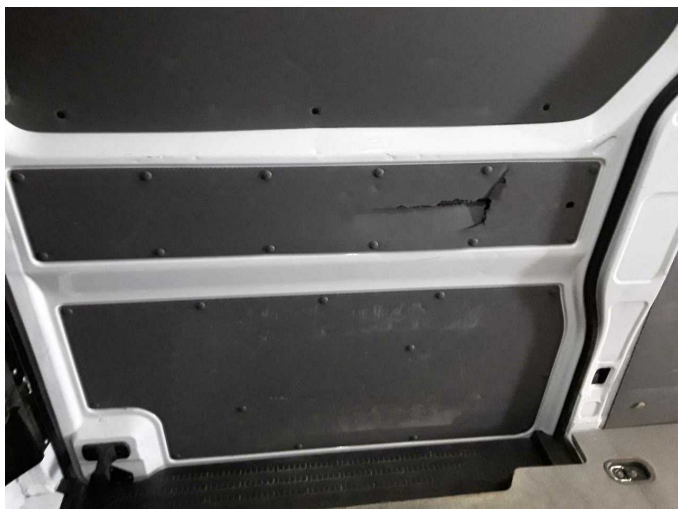
Damage 4: Interior: Interior (Laderaumverkleidungen) - Broken / torn - Replace
