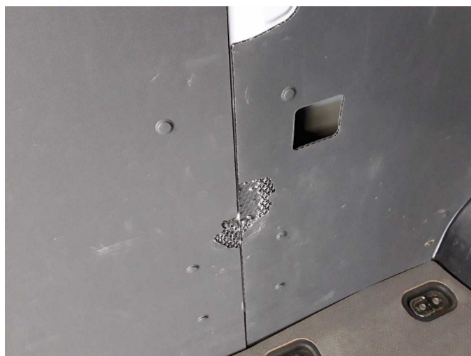
Damage 4: Interior: Interior (Laderaumverkleidungen) - Broken / torn - Replace
