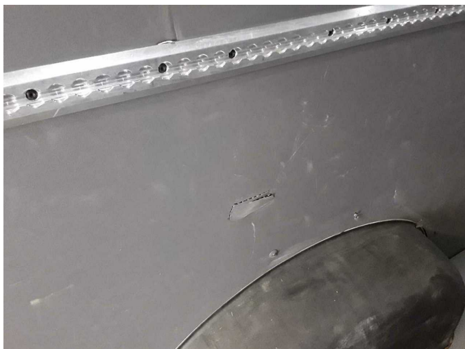
Damage 4: Interior: Interior (Laderaumverkleidungen) - Broken / torn - Replace
