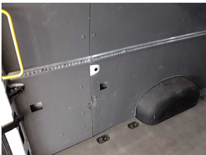
Damage 4: Interior: Interior (Laderaumverkleidungen) - Broken / torn - Replace
