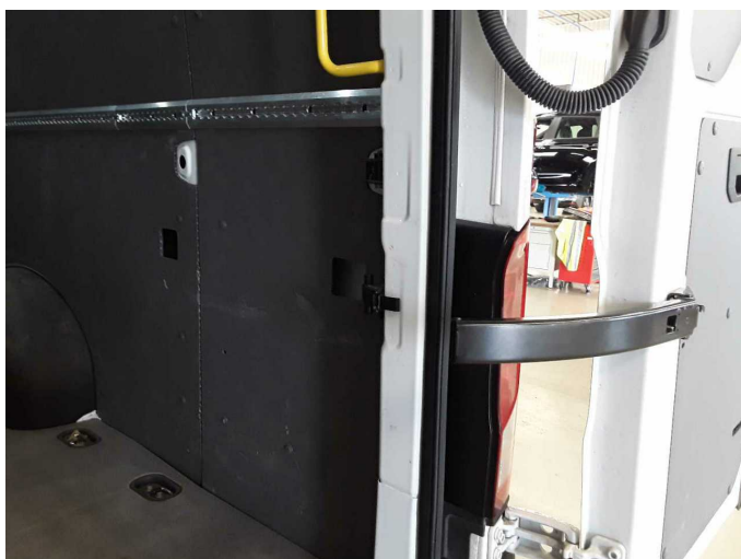
Damage 1: Boot lid / rear door: Door check strap / arrestor (rechts) - Broken / torn - Replace
