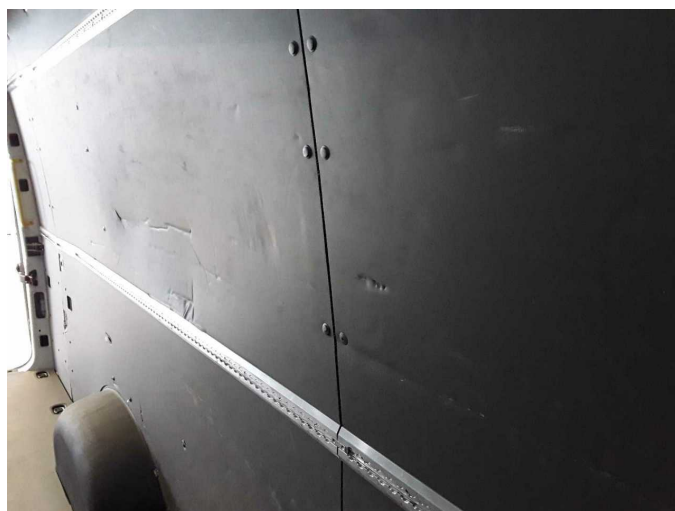
Damage 4: Interior: Interior (Laderaumverkleidungen) - Broken / torn - Replace
