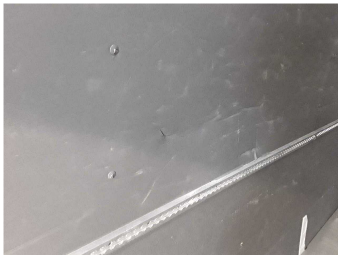
Damage 4: Interior: Interior (Laderaumverkleidungen) - Broken / torn - Replace
