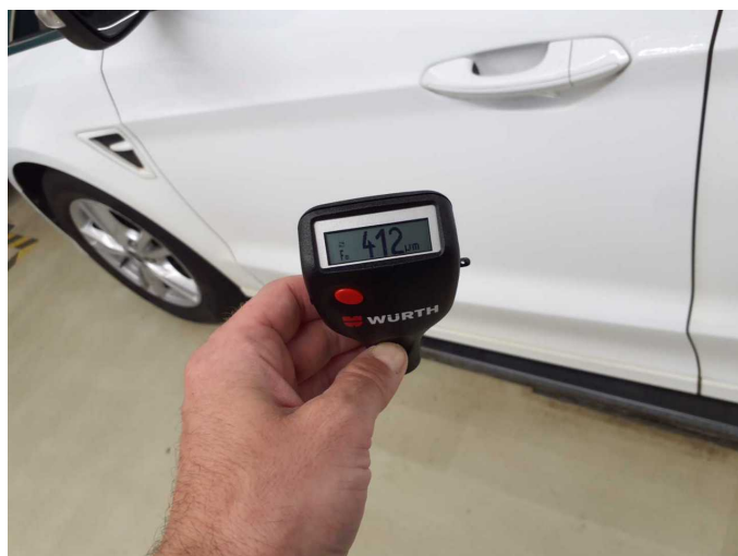
Door - front left side: 412 µm
