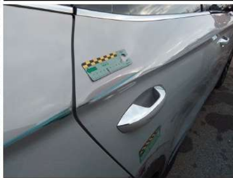
Porta / Posteriore Destro / Rientranza
