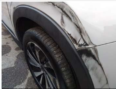
Mdatura parafango / Anteriore Destro / Riga
