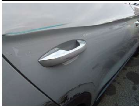
Maniglia esterna porta / Posteriore Destro / Riga
