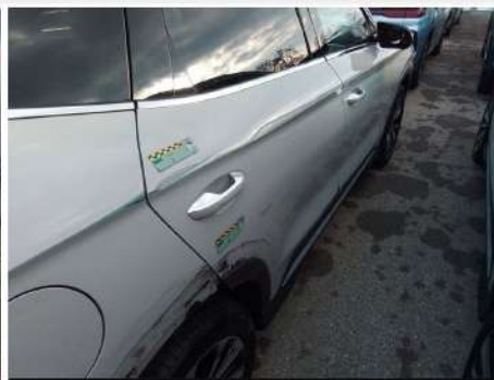
Porta / Posteriore Destro / Rientranza
