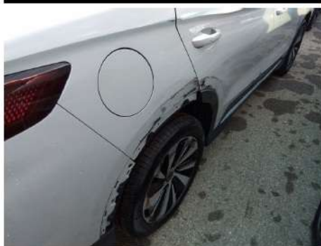
Modanatura parafrango / Posteriore Destro / Mancante
