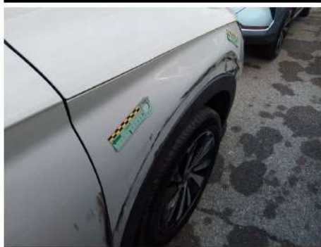
Parafango / Anteriore Destro / Rientranza
