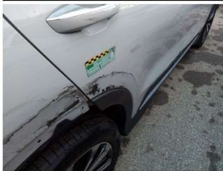
Porta / Posteriore Destro / Rientranza
