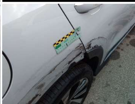
Parafrango / Posteriore Destro / Rientranza
