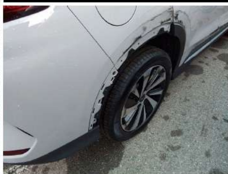
Modanatura parafrango / Posteriore Destro / Mancante
