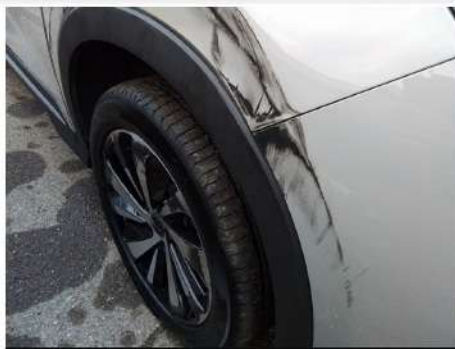
Mdatura parafango / Anteriore Destro / Riga
