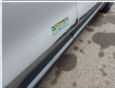
Porta / Posteriore Destro / Rientranza
