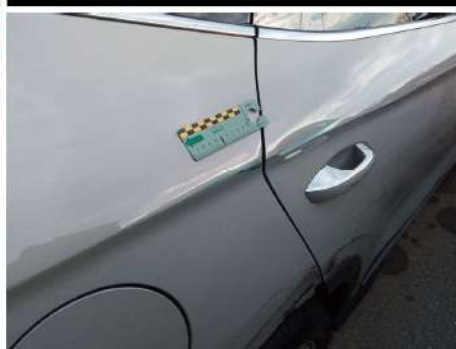
Parafrango / Posteriore Destro / Rientranza
