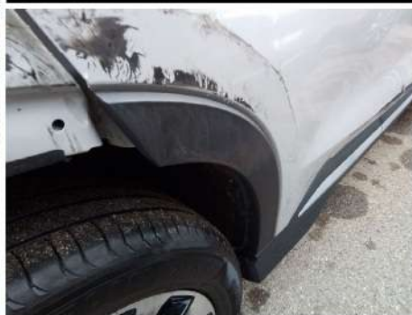
Modanatura porta / Posteriore Destro / Riga
