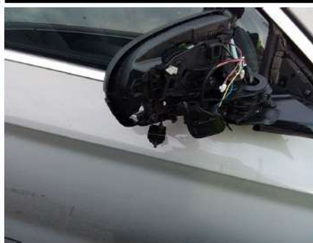
Indicatore di direzione / Destro / Rotto
