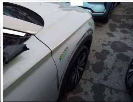
Parafango / Anteriore Destro / Rientranza
