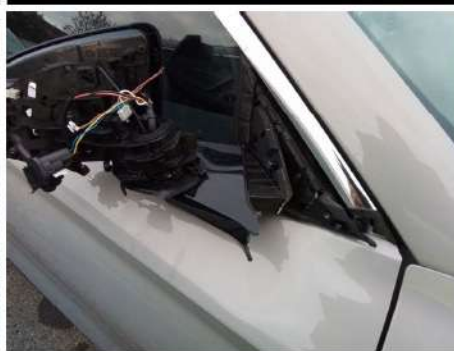
Retrovisore elettrico / Destro / Rotto
