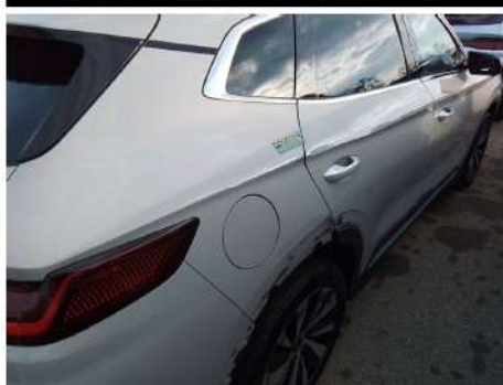
Parafrango / Posteriore Destro / Rientranza
