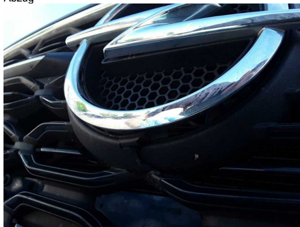
Beschädigung #2: Frontmaske: Emblem (Lose) - beschädigt - erneuern
