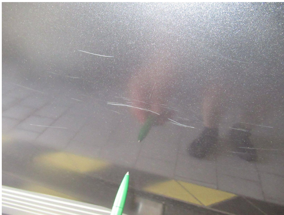
Bild 8 : Tür hinten links Lackierung, zerkratzt, lackieren mit Lackaufbau
