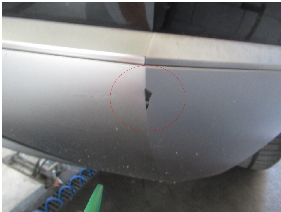
Bild 15 : Heckschürze hinten unten Lackierung, zerkratzt, lackieren mit Lackaufbau
