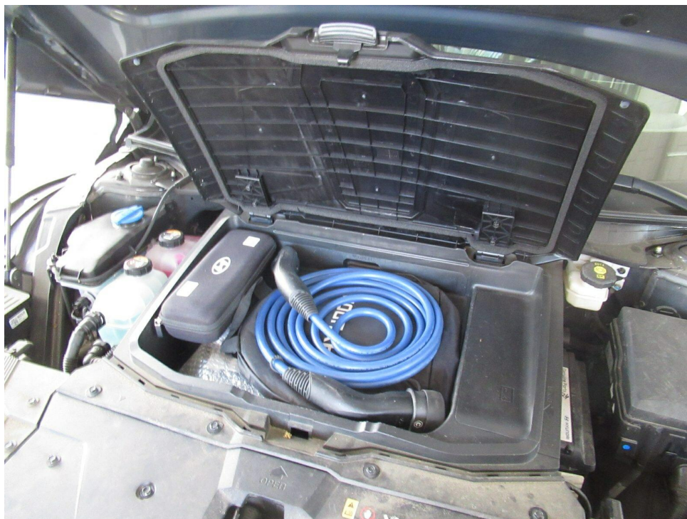
Bild 7 : Ladekabel beim E-Fahrzeug
