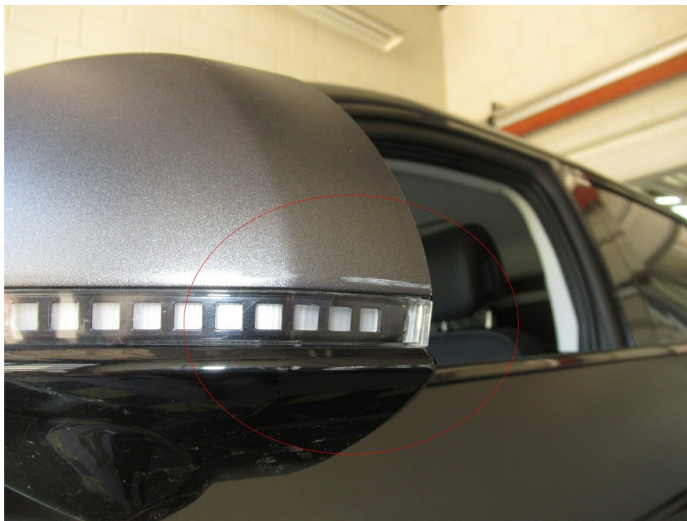
Bild 12 : Außenspiegel links Lackierung, zerkratzt, lackieren mit Lackaufbau
