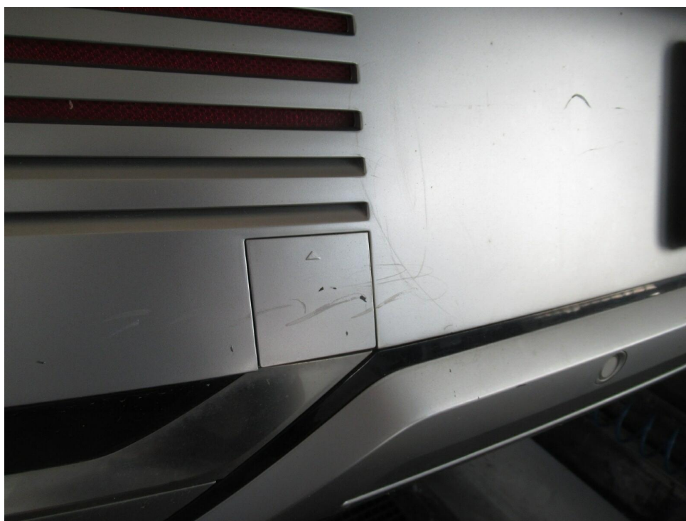
Bild 14 : Stoßfänger hinten Lackierung, zerkratzt, lackieren mit Lackaufbau
