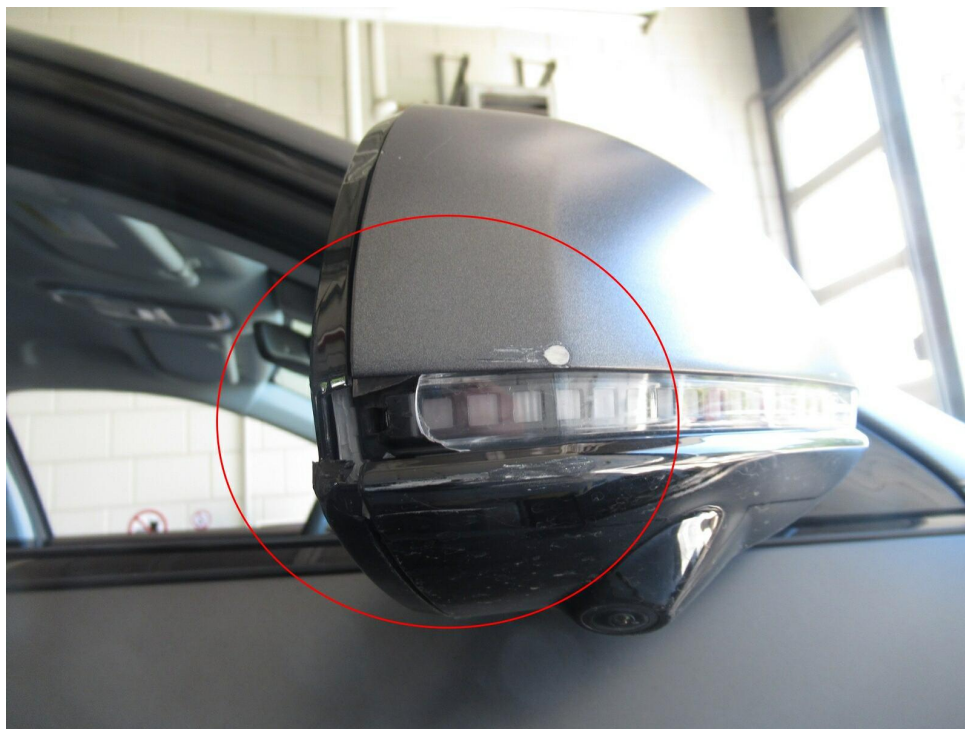
Bild 17 : Außenspiegelgehäuse r. gebrochen
