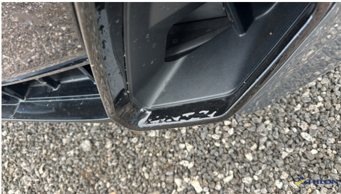
1. spoiler anteriore Difetto di esecuzione
