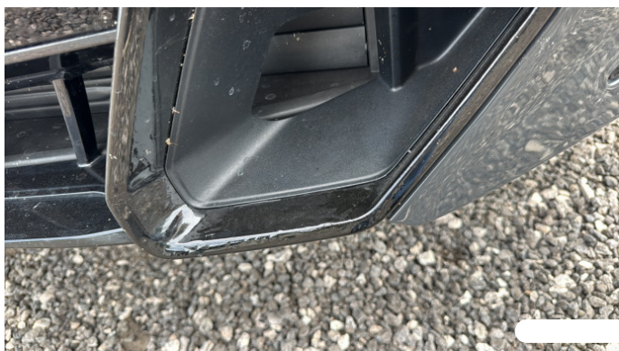
1. spoiler anteriore Difetto di esecuzione
