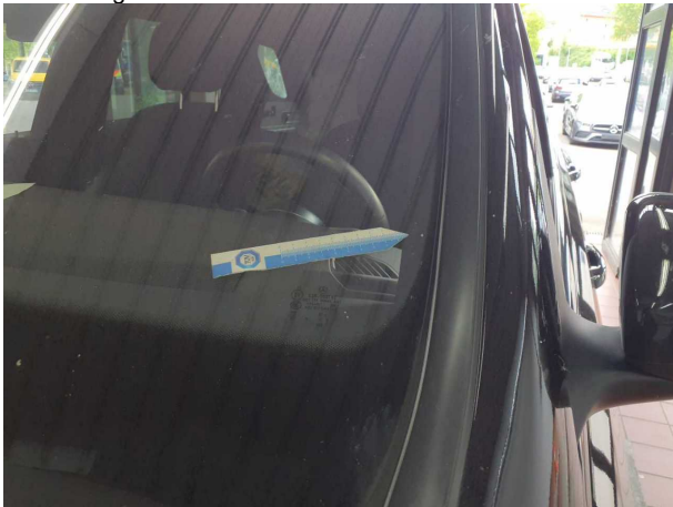
Beschädigung #10: Verglasung: Frontscheibe (Rissbildung) - Steinschlag - erneuern
