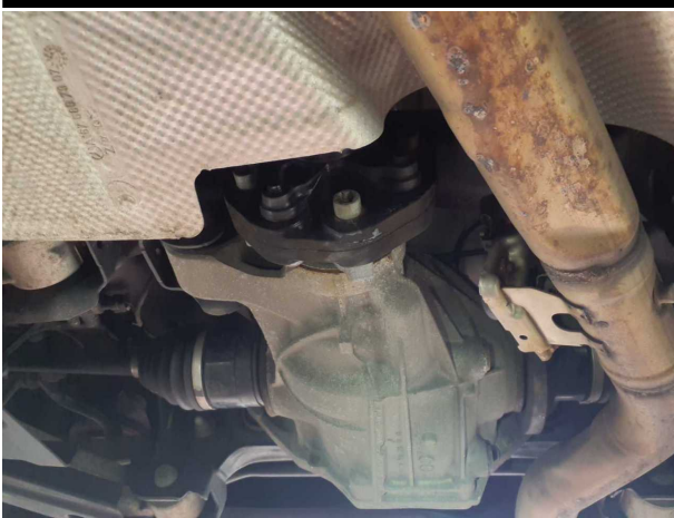
Beschädigung #7: Antriebsstrang: Gelenkwelle Hinterachse (Hardyscheibe porös) - erneuern
