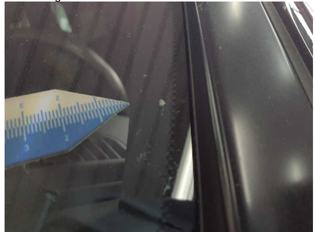
Beschädigung #10: Verglasung: Frontscheibe (Rissbildung) - Steinschlag - erneuern
