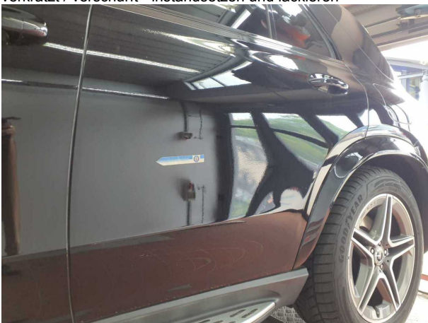
Beschädigung #9: Tür hinten links: Tür - verkratzt / verschürft - instandsetzen und lackieren
