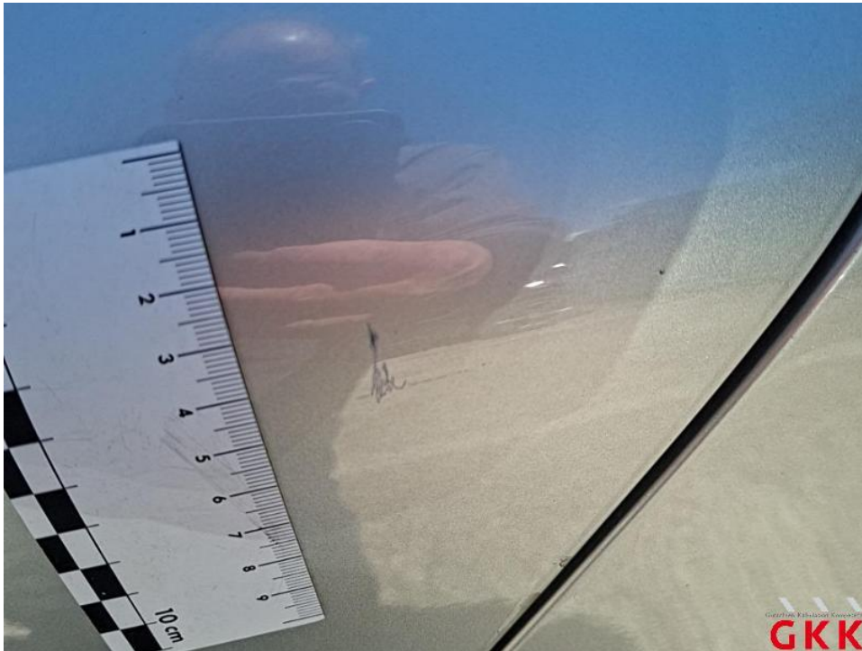
Bild 36. Tür hinten links, verkratzt, Spotlackieren
