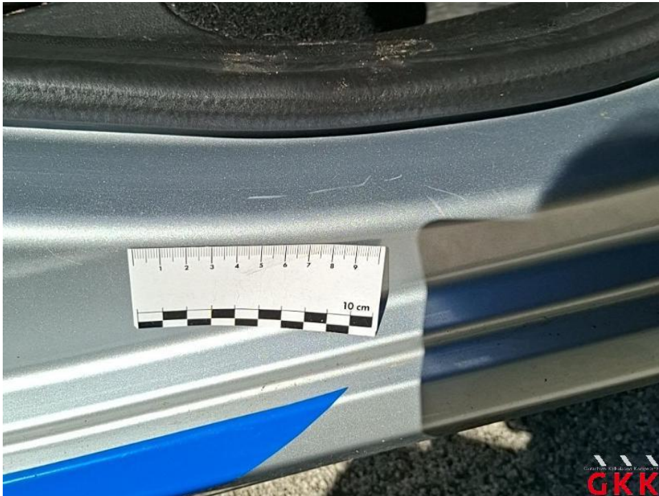
Bild 24. Tür hinten rechts, Einstieg, verkratzt, Smartrepair
