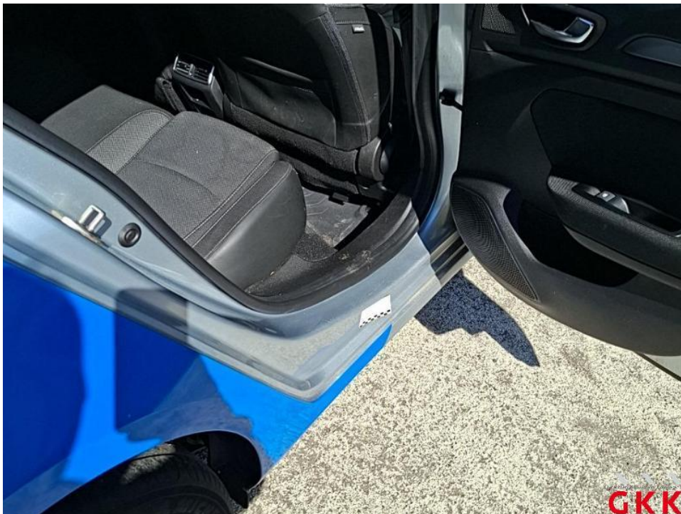
Bild 23. Tür hinten rechts, Einstieg, verkratzt, Smartrepair
