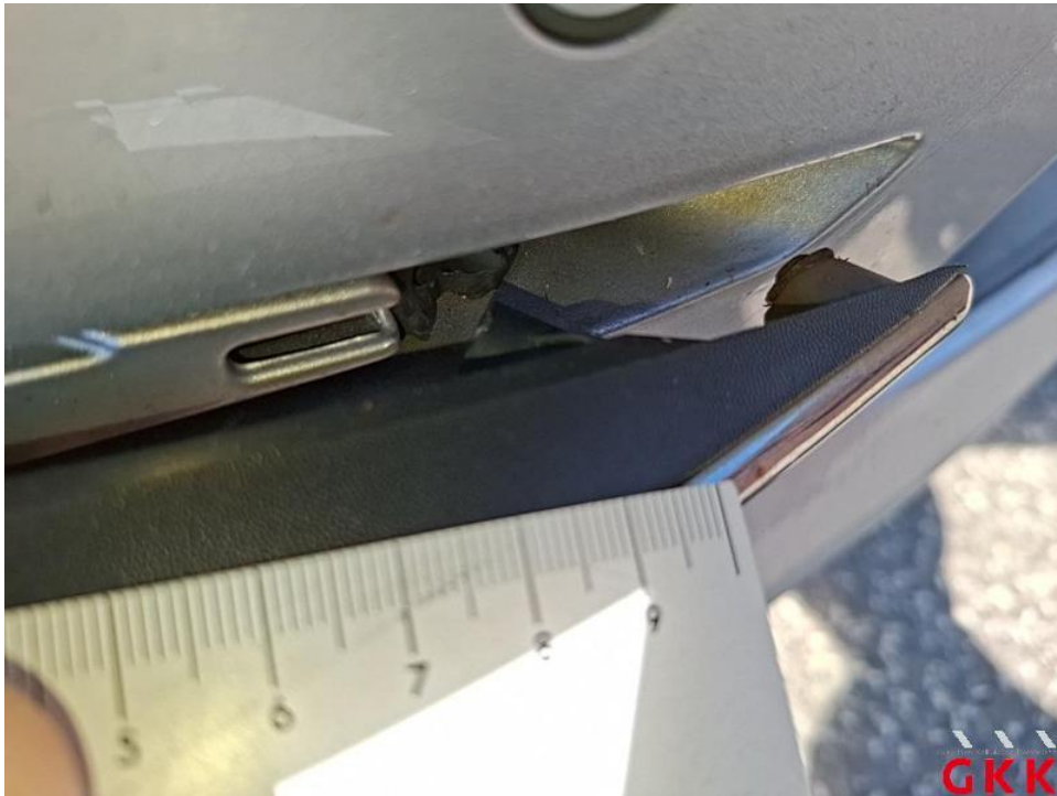
Bild 20. Stoßfänger vorne, Blende -unlackiert-, beschädigt, ersetzen
