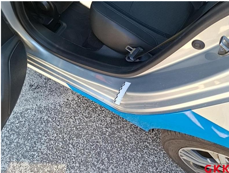
Bild 37. Tür hinten links, Einstieg, verkratzt, Smartrepair
