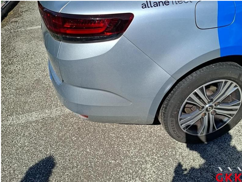
Bild 42. Stoßfänger hinten, Verkleidung -lackiert-, verkratzt, Spotlackieren
