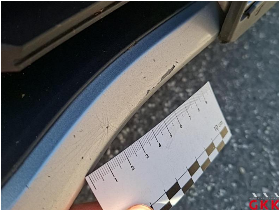
Bild 22. Stoßfänger vorne, Verkleidung -lackiert-, beschädigt, lackieren
