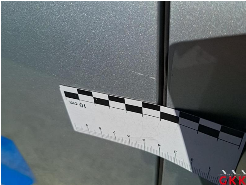
Bild 30. Tür hinten rechts, verkratzt, auslegen, schleifen, polieren
