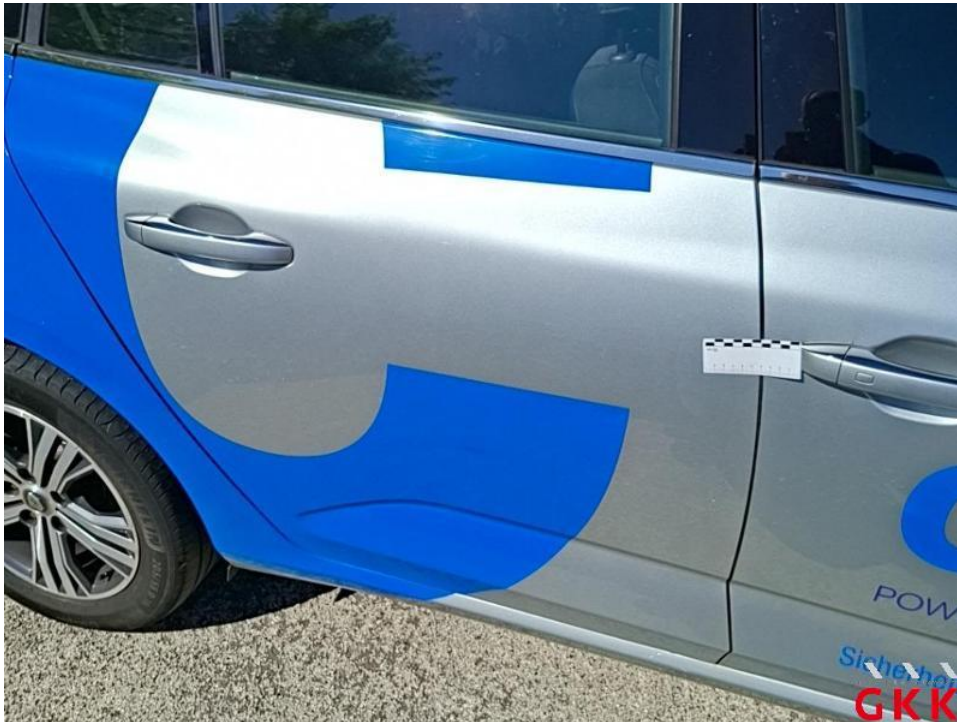
Bild 29. Tür hinten rechts, verkratzt, auslegen, schleifen, polieren
