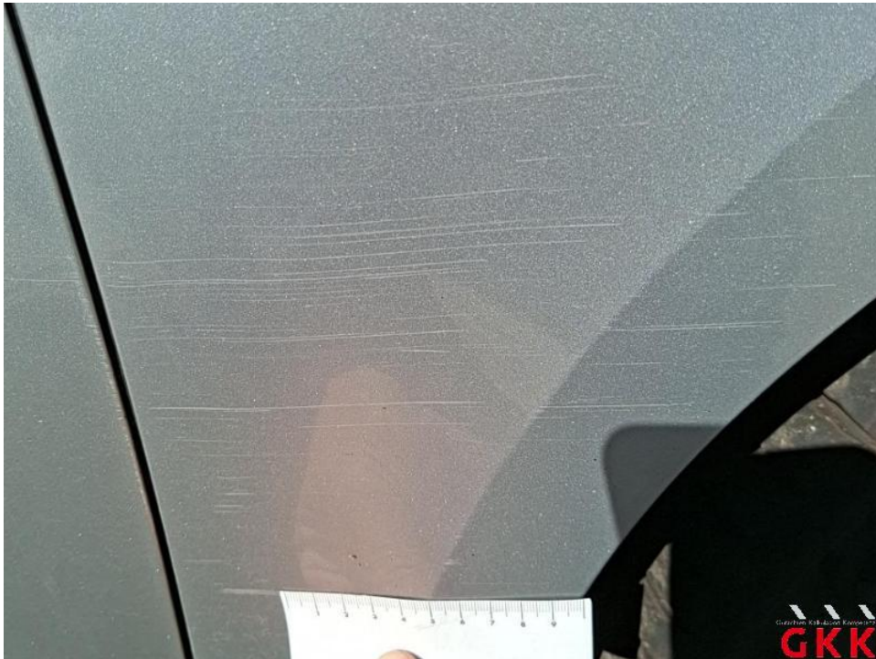
Bild 34. Kotflügel vorne rechts, verkratzt, lackieren
