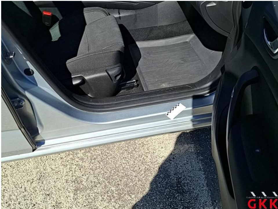
Bild 26. Tür vorne rechts, Einstieg, verkratzt, Smartrepair
