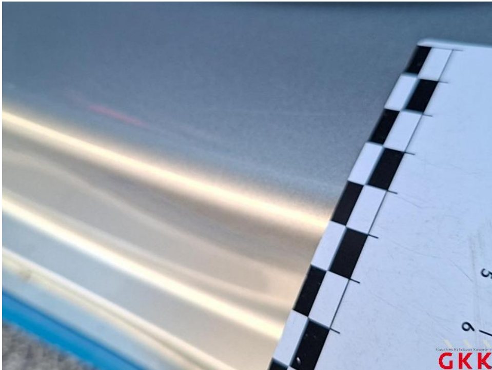
Bild 38. Tür hinten links, Einstieg, verkratzt, Smartrepair
