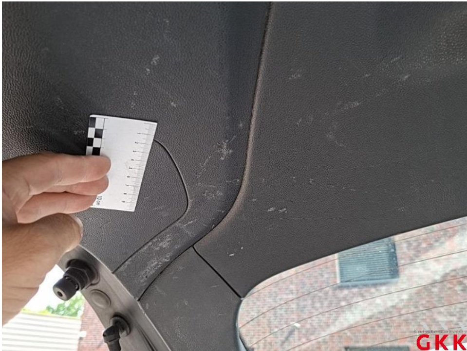
Bild 18. Heckklappe, Innenverkleidung, beschädigt, ersetzen
