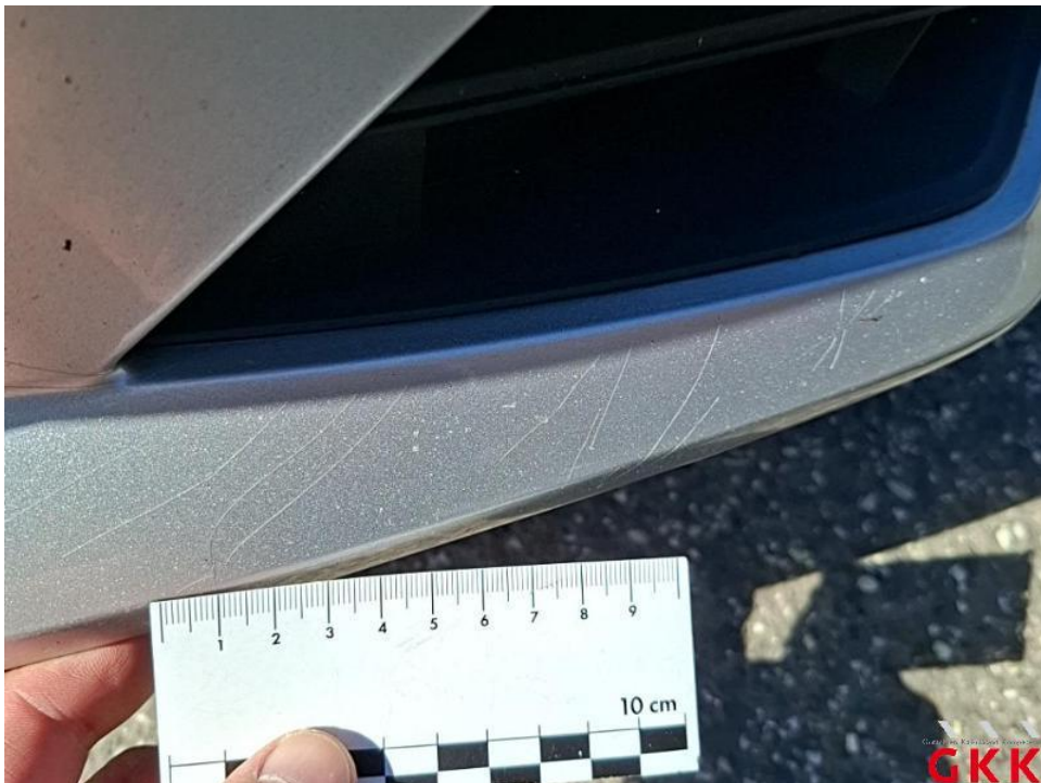
Bild 21. Stoßfänger vorne, Verkleidung -lackiert-, beschädigt, lackieren
