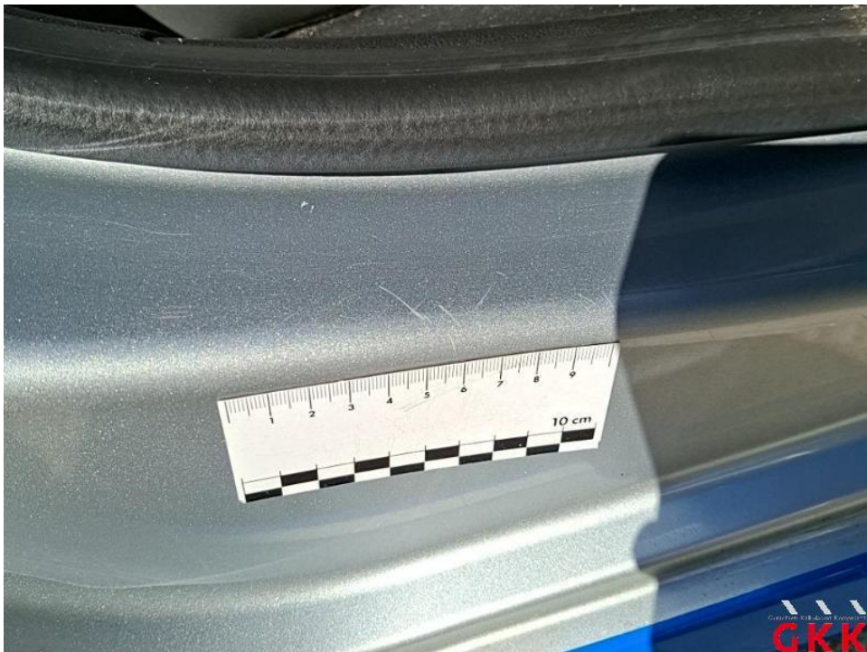
Bild 25. Tür hinten rechts, Einstieg, verkratzt, Smartrepair
