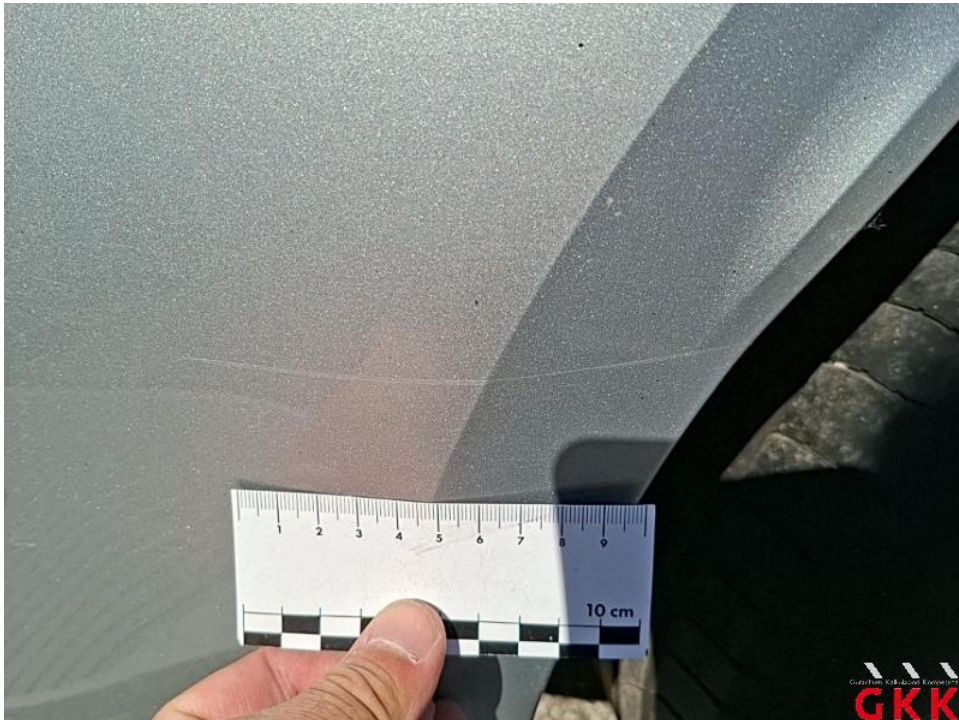
Bild 43. Stoßfänger hinten, Verkleidung -lackiert-, verkratzt, Spotlackieren
