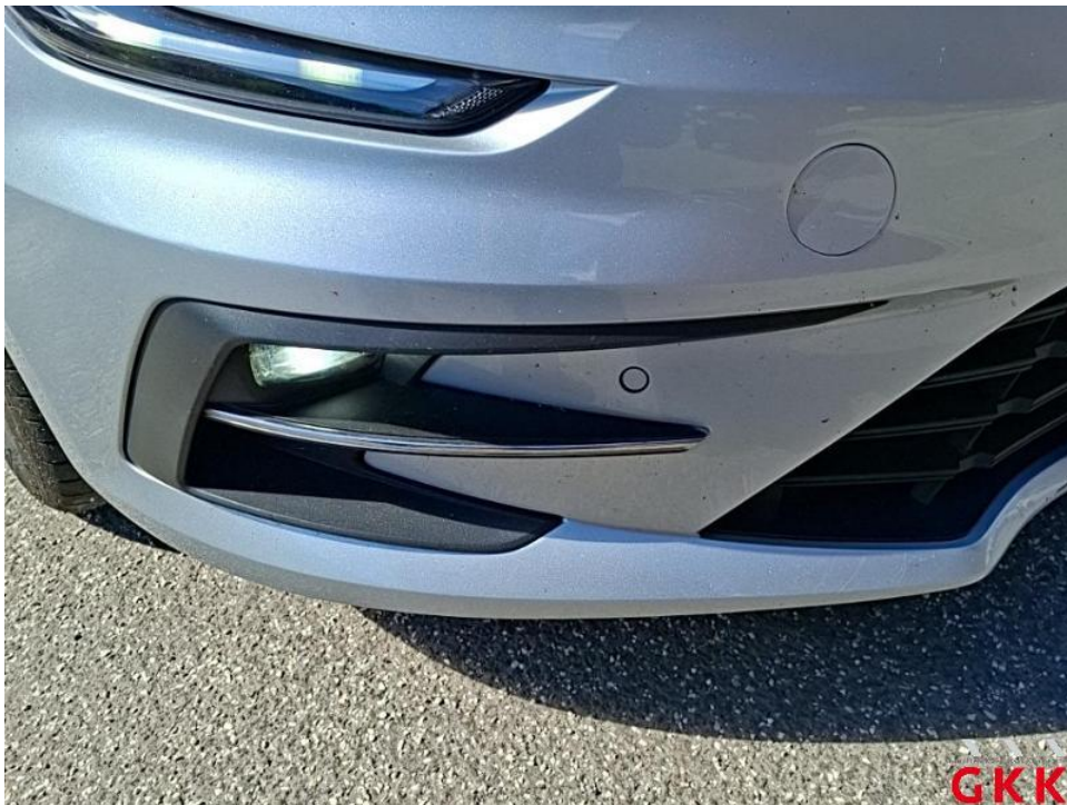
Bild 19. Stoßfänger vorne, Blende -unlackiert-, beschädigt, ersetzen
