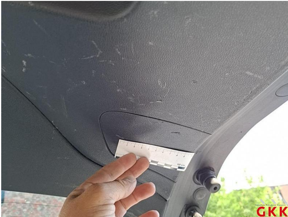
Bild 17. Heckklappe, Innenverkleidung, beschädigt, ersetzen
