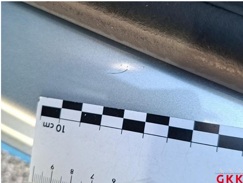
Bild 39. Tür hinten links, Einstieg, verkratzt, Smartrepair
