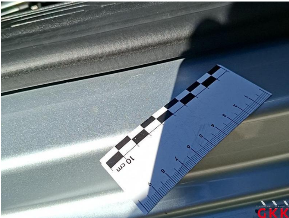
Bild 27. Tür vorne rechts, Einstieg, verkratzt, Smartrepair
