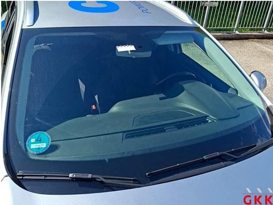
Bild 44. Frontscheibe, mit Regensensor und Frontkamera, Steinschlag mit Rissbildung, ersetzen
