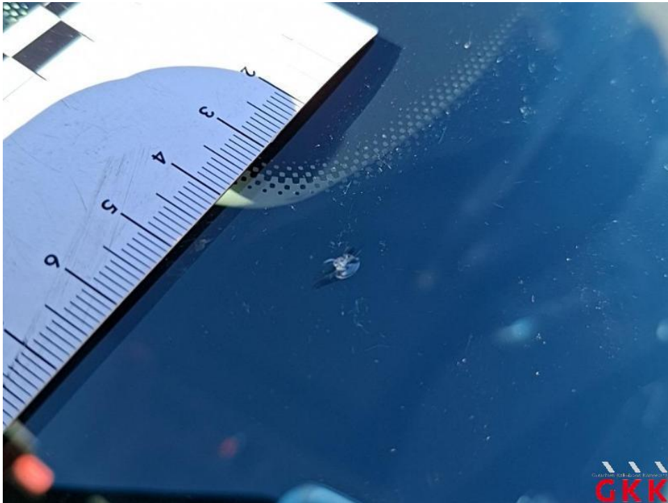
Bild 45. Frontscheibe, mit Regensensor und Frontkamera, Steinschlag mit Rissbildung, ersetzen
