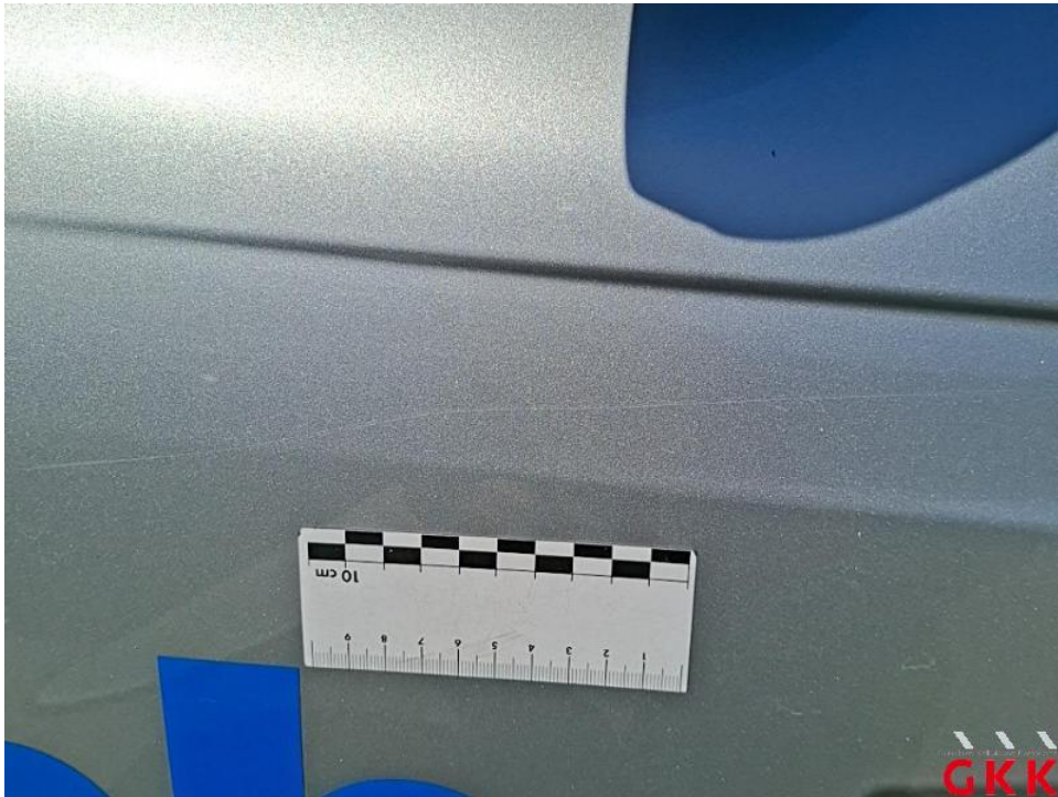
Bild 32. Tür vorne rechts, verkratzt, lackieren
