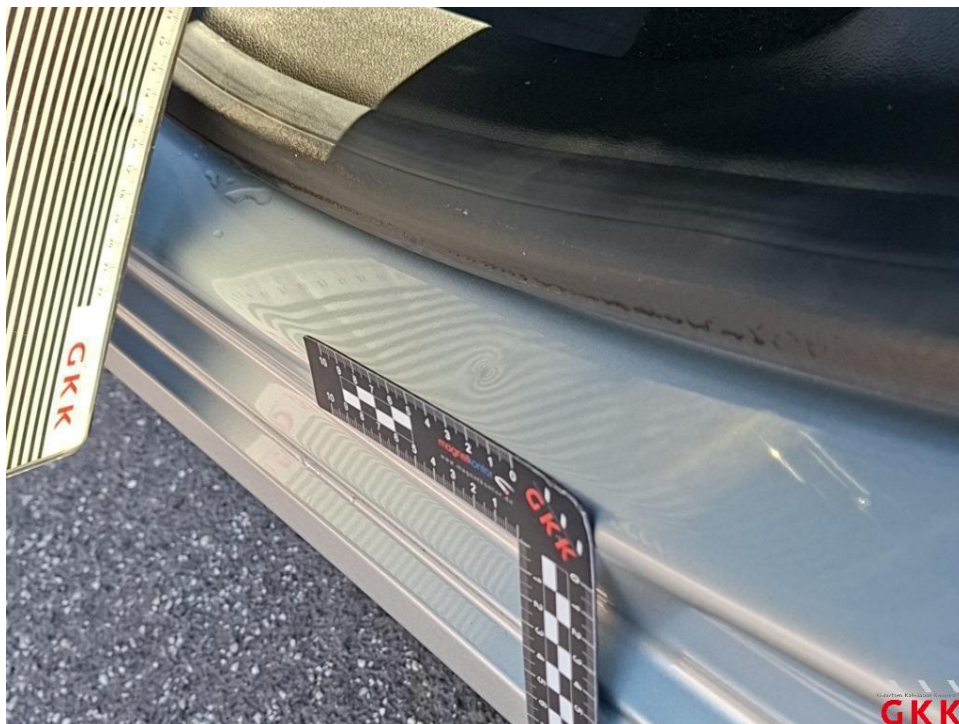
Bild 33. Tür hinten links, Einstieg, beschädigt, kalt drücken
