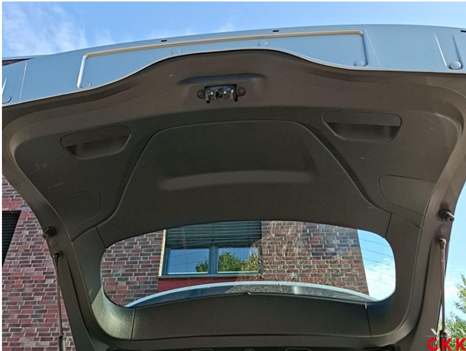
Bild 26. Heckklappe, Innenverkleidung, verkratzt, ersetzen
