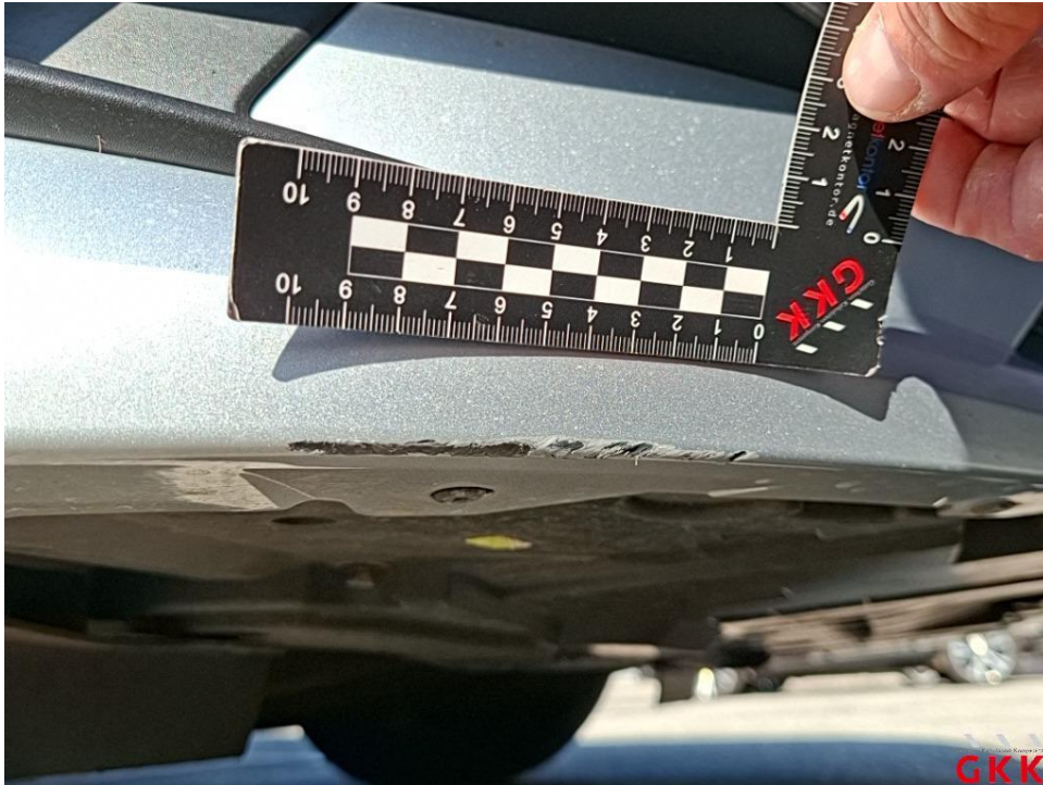
Bild 17. Stoßfänger vorne, Verkleidung -lackiert-, beschädigt, ersetzen
