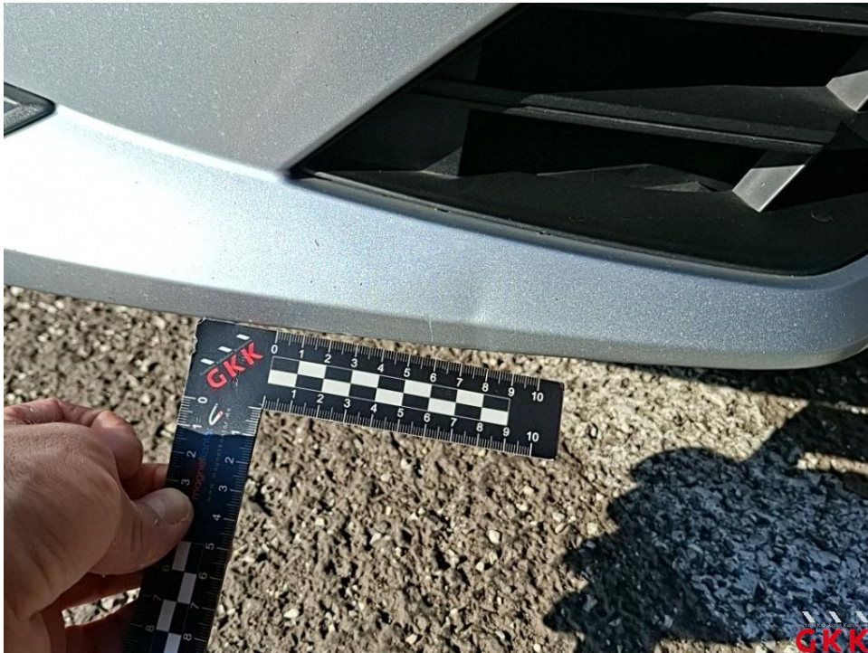
Bild 16. Stoßfänger vorne, Verkleidung -lackiert-, beschädigt, ersetzen
