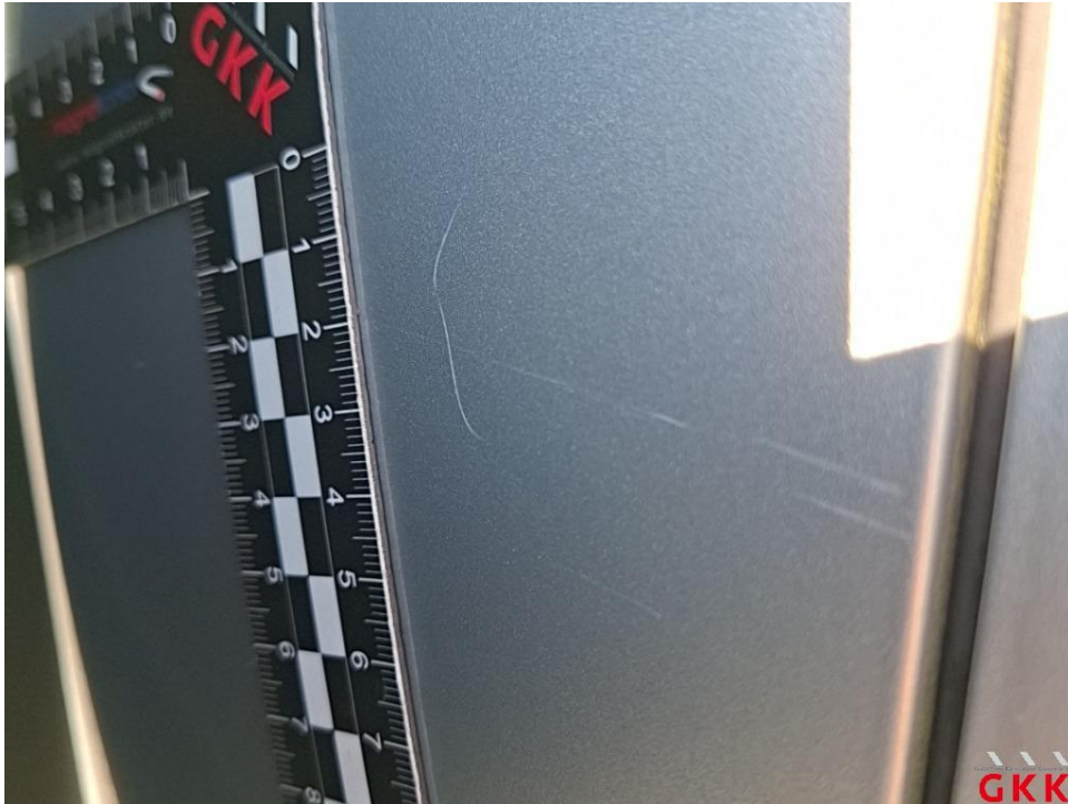
Bild 19. Tür hinten rechts, verkratzt, lackieren
