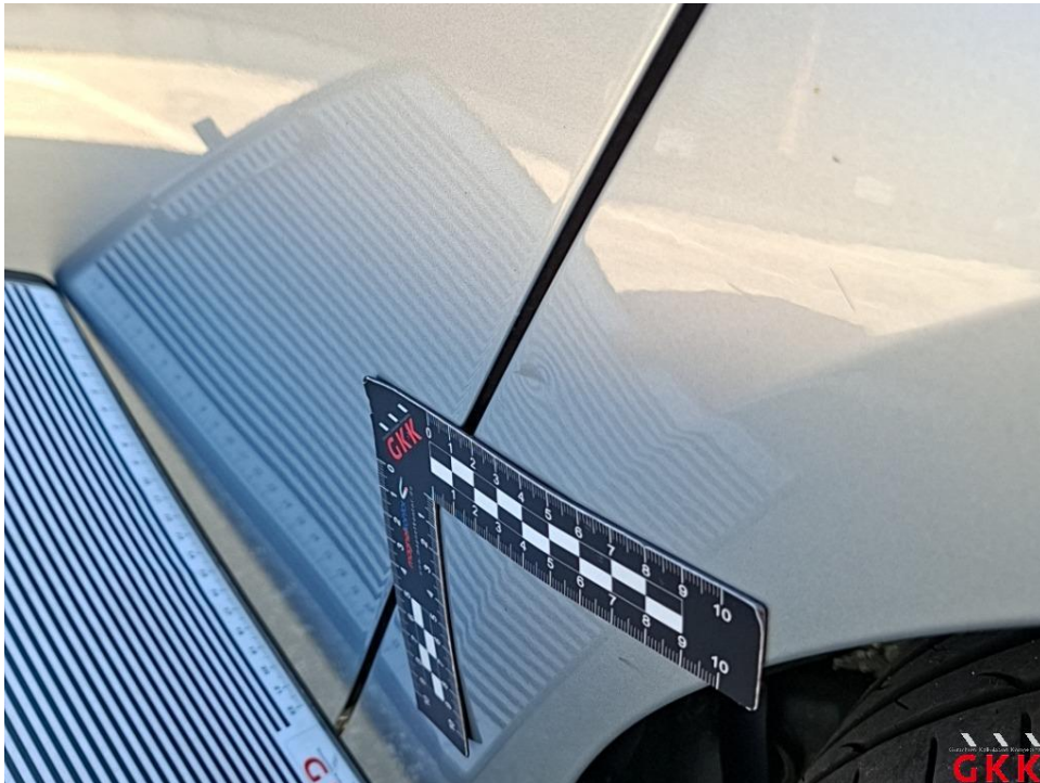
Bild 30. Seitenwand links, beschädigt, instand setzen - lackieren
