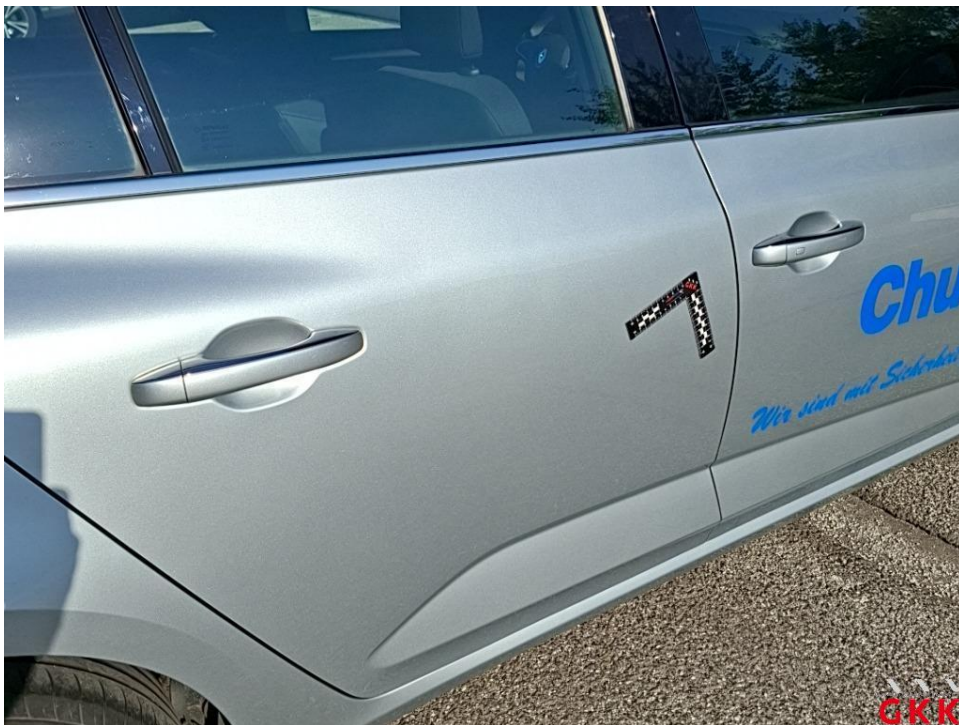
Bild 18. Tür hinten rechts, verkratzt, lackieren
