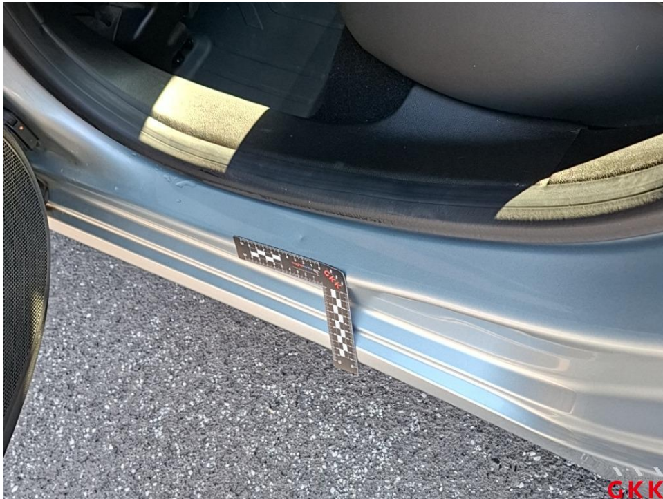
Bild 32. Tür hinten links, Einstieg, beschädigt, kalt drücken
