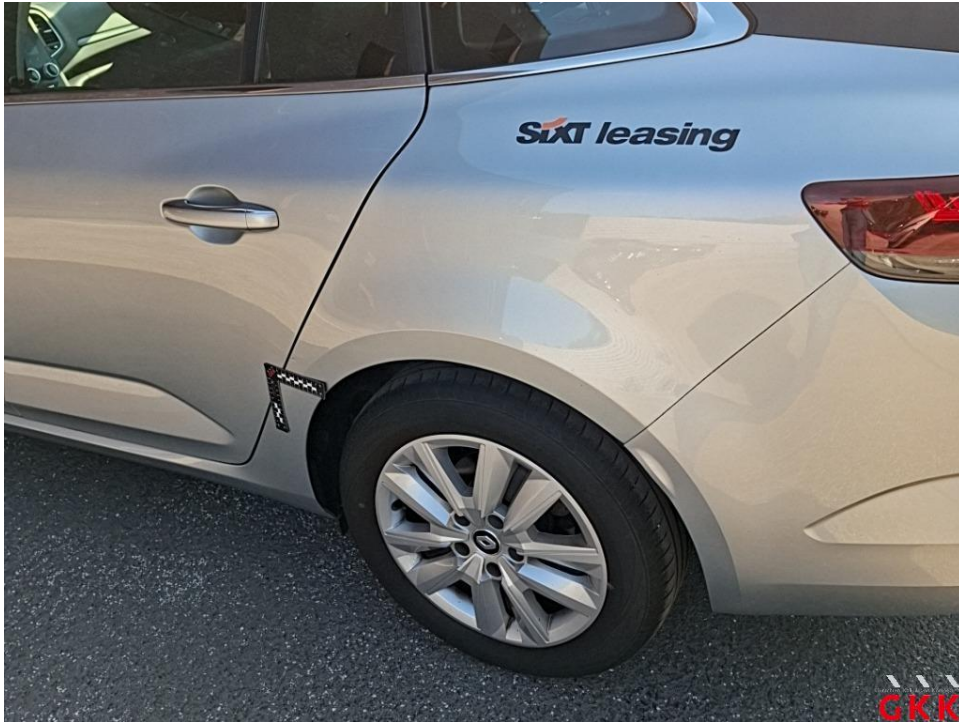
Bild 29. Seitenwand links, beschädigt, instand setzen - lackieren
