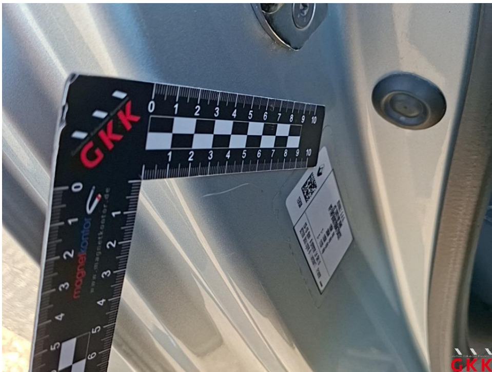
Bild 22. Tür hinten rechts, Einstieg, beschädigt, Smartrepair
