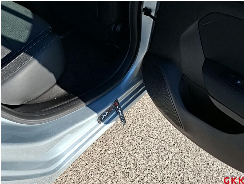
Bild 20. Tür hinten rechts, Einstieg, beschädigt, Smartrepair
