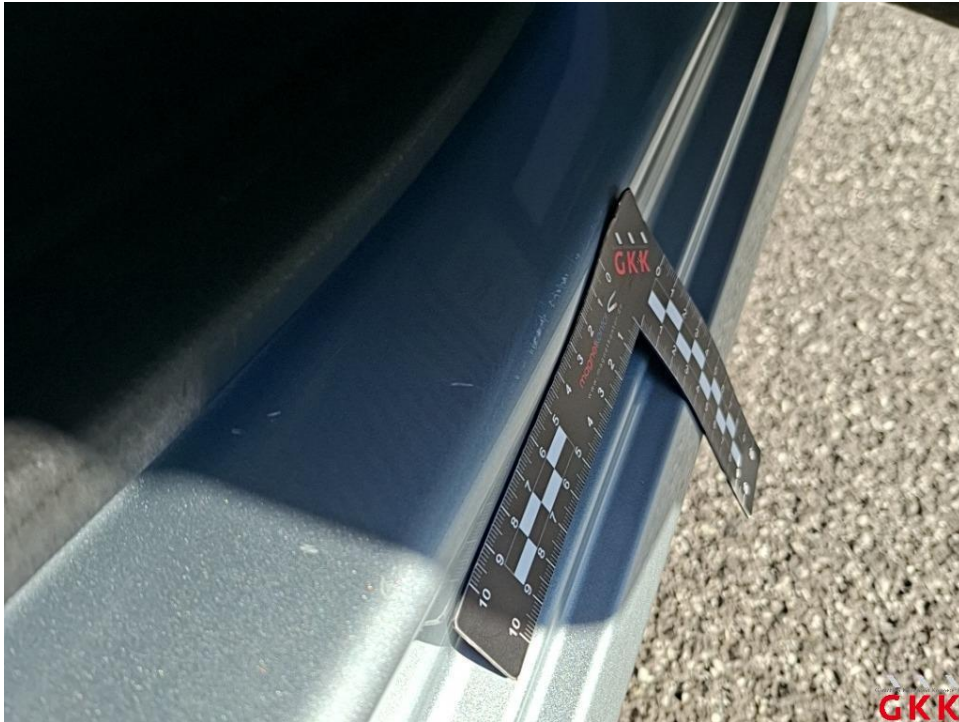
Bild 21. Tür hinten rechts, Einstieg, beschädigt, Smartrepair
