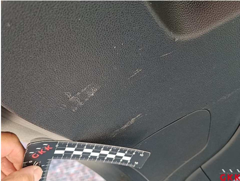
Bild 27. Heckklappe, Innenverkleidung, verkratzt, ersetzen
