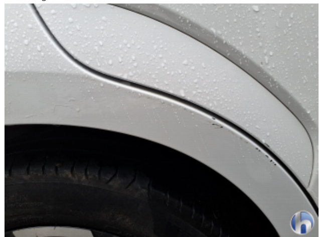
2. Seitenwand - Hinten - Rechts Beschädigt - Instandsetzen und Lackieren
