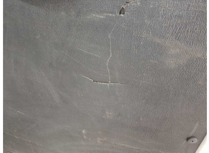
Damage 2: Boot lid / rear door: Rear door - right side (Verkleidung unten) - Broken / torn - Replace
