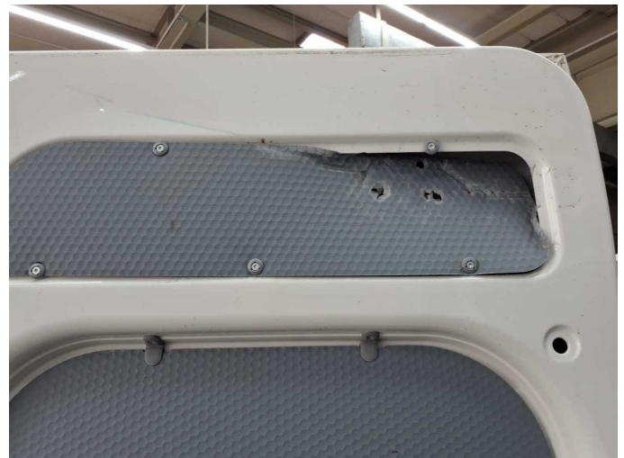
Damage 3: Boot lid / rear door: Rear door - left side (Verkleidung oben) - Broken / torn - Replace
