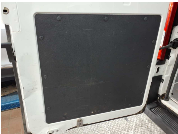
Damage 1: Boot lid / rear door: Rear door - left side (Verkleidung unten) - Broken / torn - Replace
