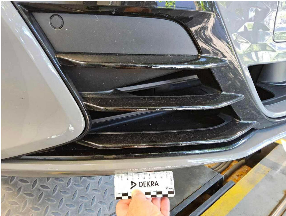
Bild 23 : Stoßfänger und Blende vorne rechts und gebrochen
