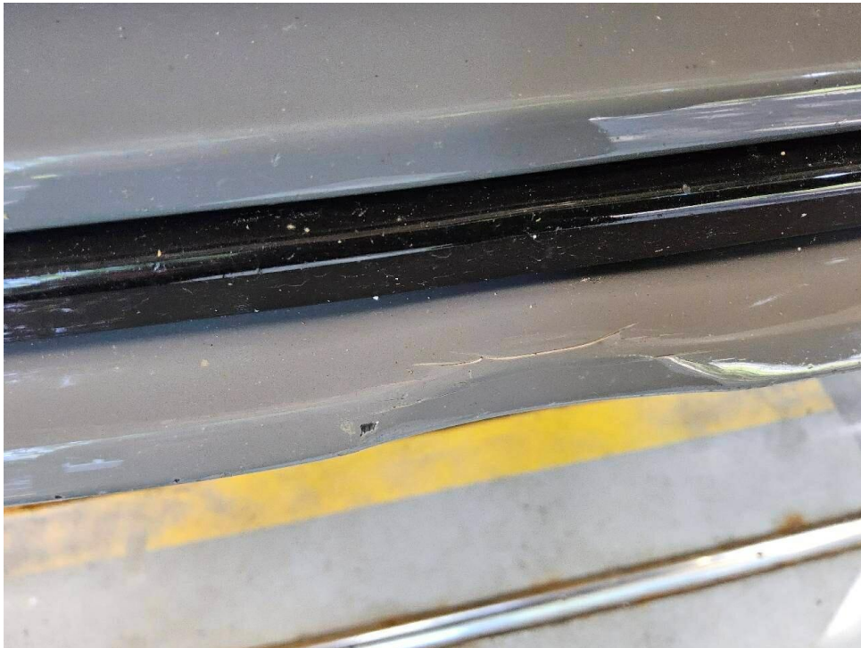
Bild 20 : Stoßfänger und Blende vorne rechts und gebrochen
