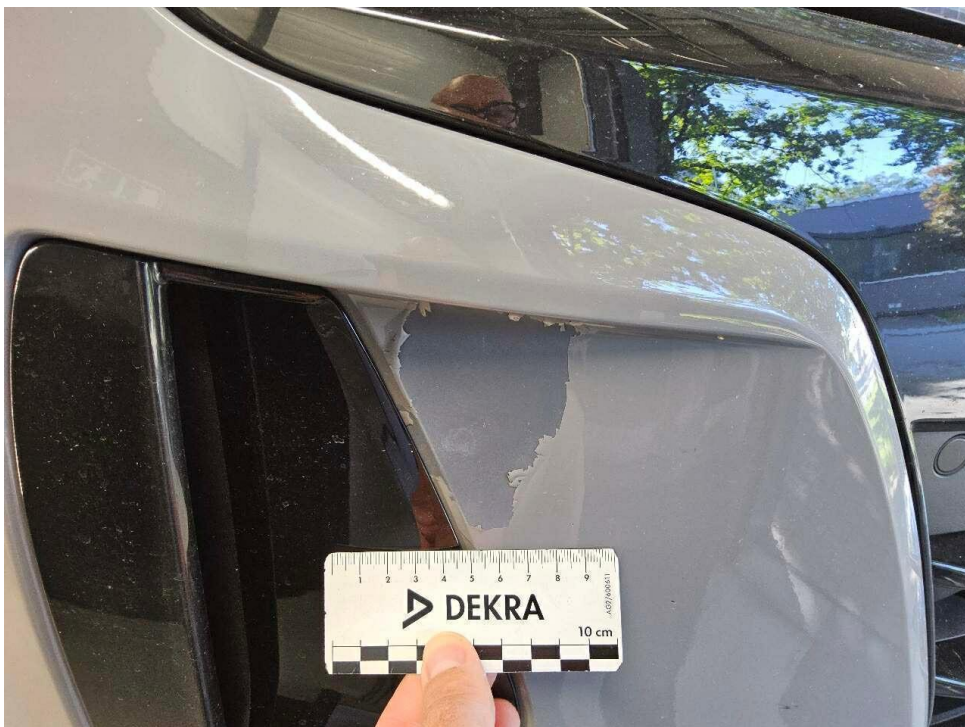
Bild 24 : Stoßfänger und Blende vorne rechts und gebrochen
