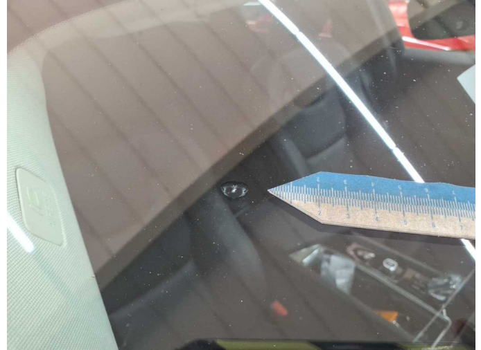
Damage 6: Vehicle glazing: Windscreen (vorbehaltlich Folgekosten) - Stone chips - Smart repair
