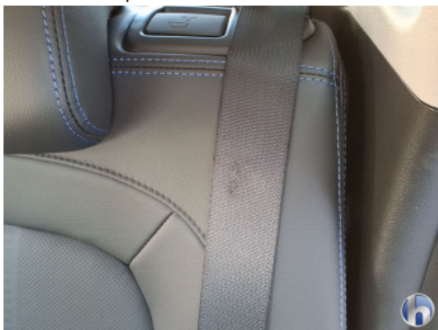
2. Sitz Innenraum links hinten Beschädigt - Erneuern
