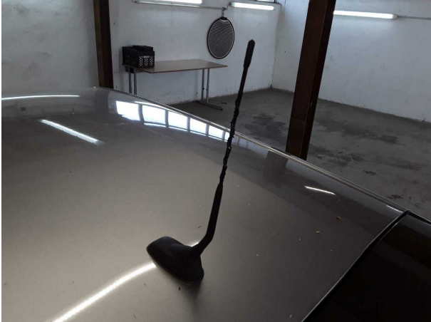
Beschädigung #1: Fahrzeugdach: Antennenstab - beschädigt - erneuern
