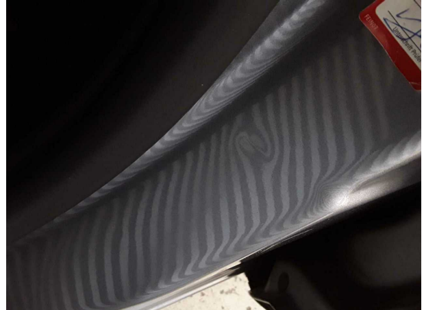
Beschädigung #2: Schweller links: Einstieg - Delle(n) - sanft instandsetzen
