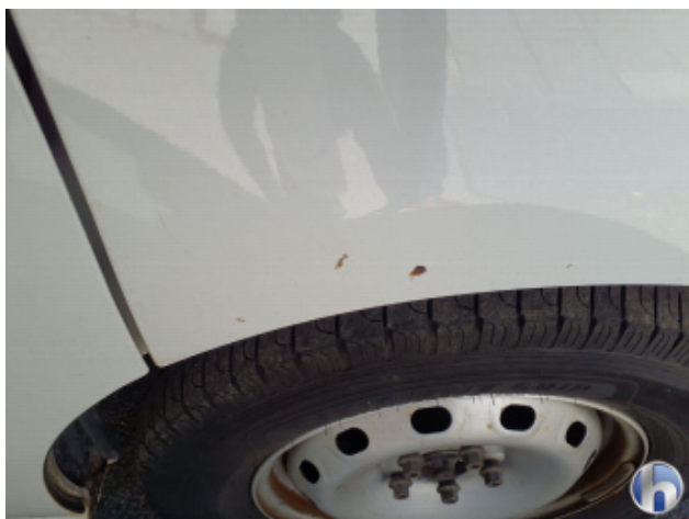
3. Kotflügel Vorne - Rechts Rost - Smart Repair
