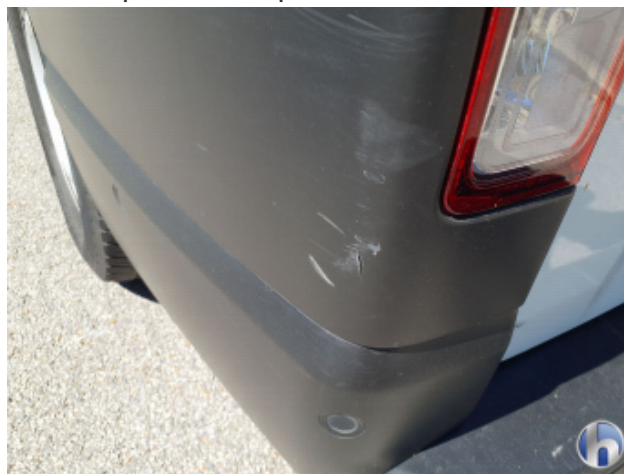
7. Eckstück Säule Beschädigt - Erneuern
