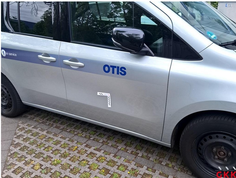
Bild 20. Tür vorne rechts, beschädigt, instand setzen - lackieren
