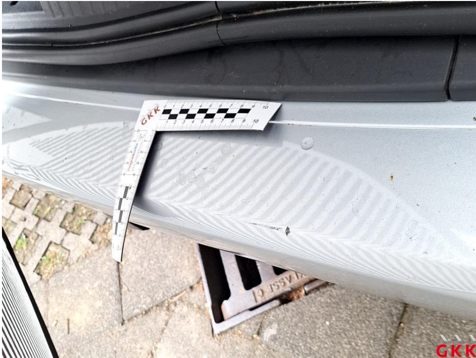
Bild 37. Stoßfänger hinten, Verkleidung -lackiert-, beschädigt, instand setzen - lackieren
