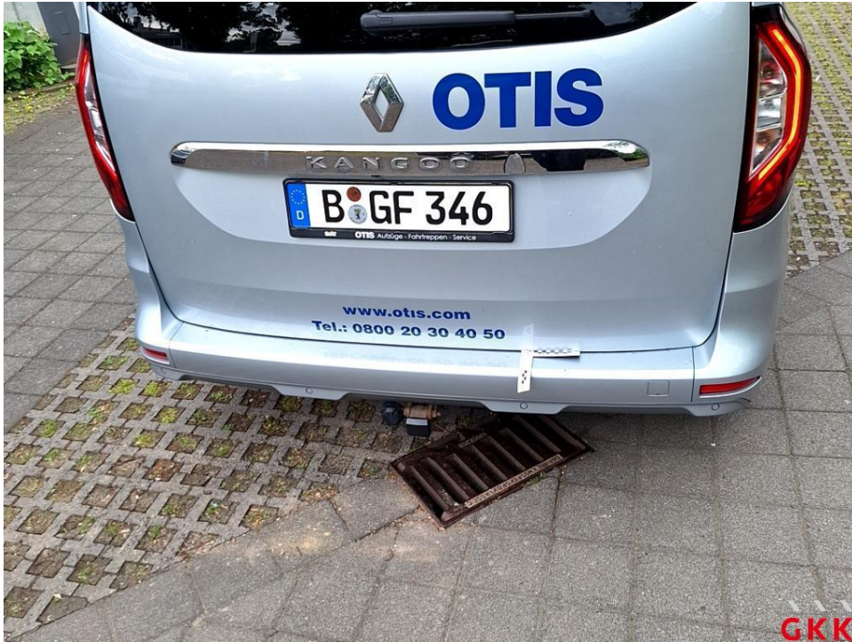
Bild 35. Stoßfänger hinten, Verkleidung -lackiert-, beschädigt, instand setzen - lackieren
