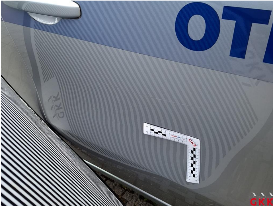
Bild 21. Tür vorne rechts, beschädigt, instand setzen - lackieren
