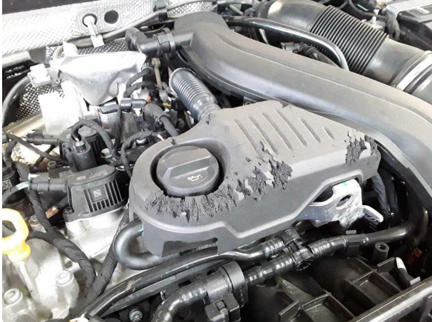
Beschädigung #1: Fahrerhaus: Dämmmatte - Marderschaden - erneuern
