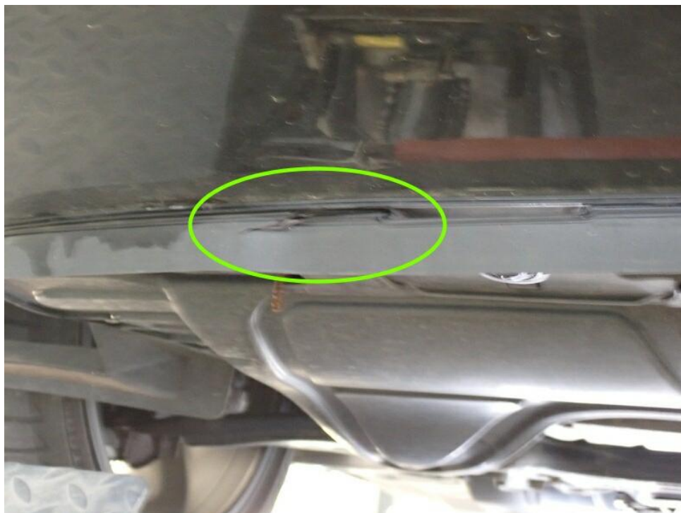
Bild 26 : Spoilerlippe (gummi) vorn eingerissen
