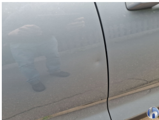
3. Tür Hinten - Rechts Beschädigt - Instandsetzen und Lackieren
