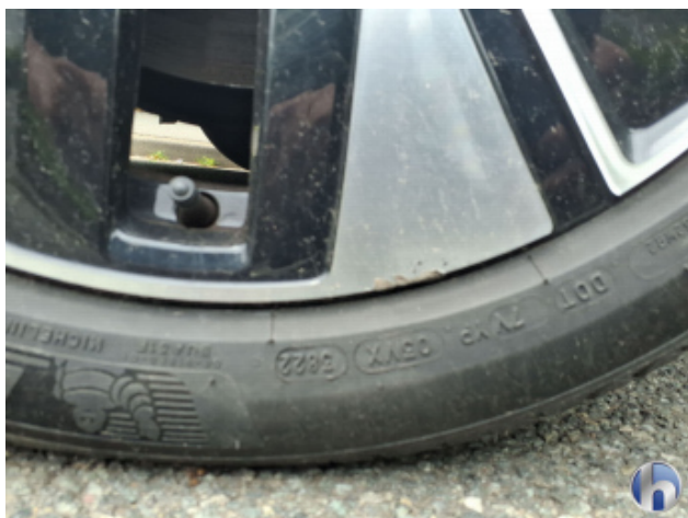
2. Felge Vorne - Links Kratzer - Smart Repair
