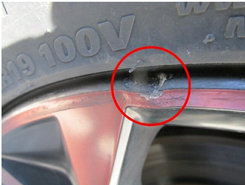
Bild 13 : Felge vorne rechts Material ausgebrochen
