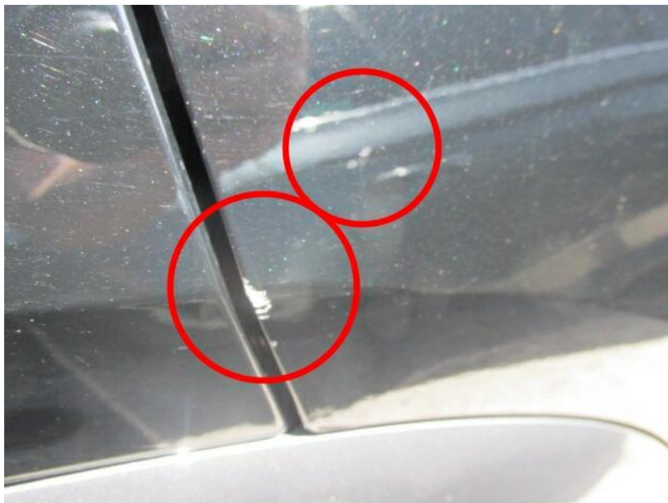
Bild 16 : Türe hinten rechts Kratzer
