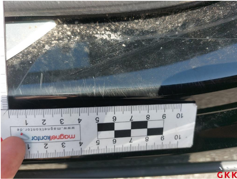
Bild 33. Tür vorne links, Einstieg, verkratzt, lackieren
