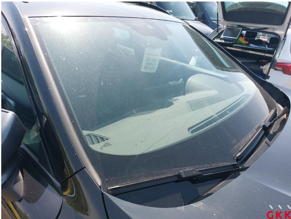
Bild 30. Frontscheibe, gerissen, ersetzen
