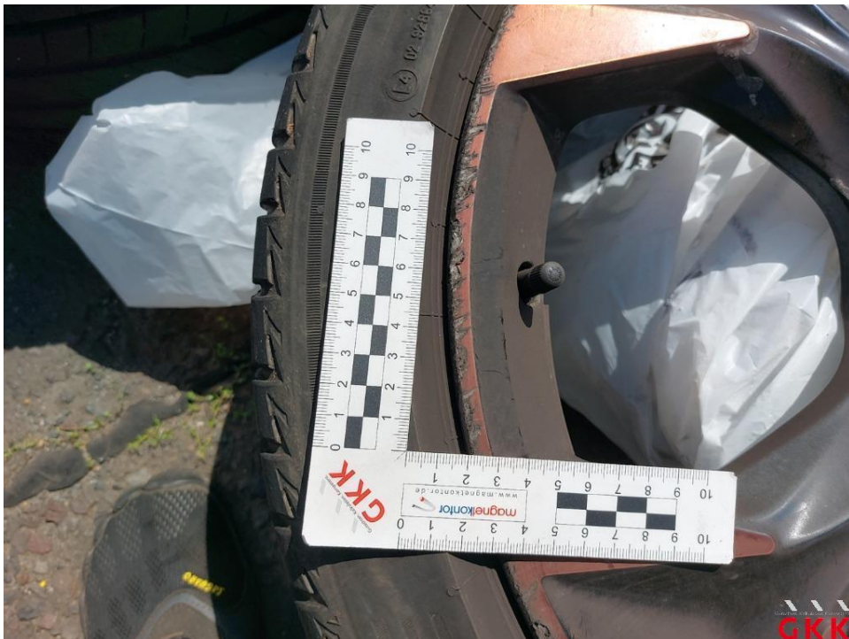
Bild 40. LM-Rad, 1 x beiliegend, Materialabtrag, ersetzen
