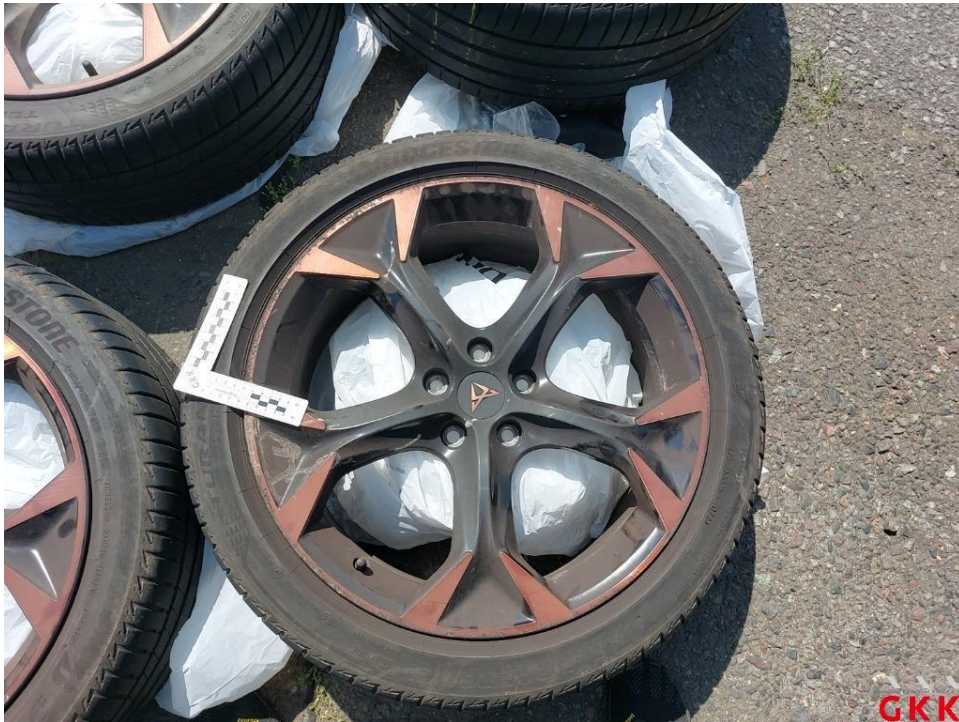
Bild 42. LM-Rad, 1 x beiliegend, Materialabtrag, ersetzen
