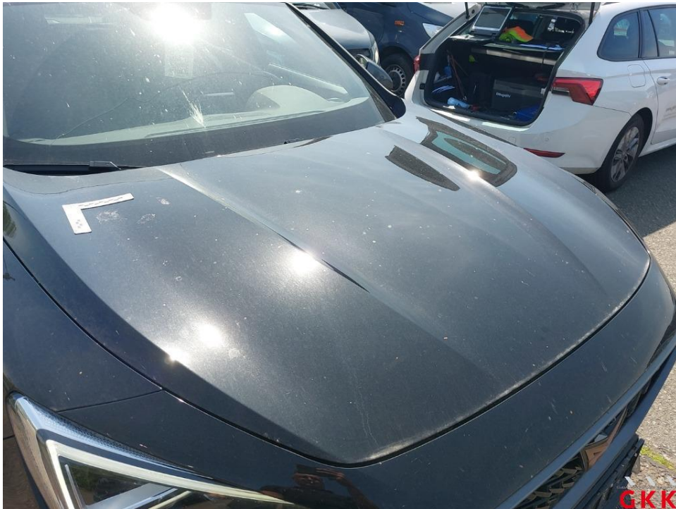
Bild 20. Motorhaube, Lackierung verätzt, lackieren
