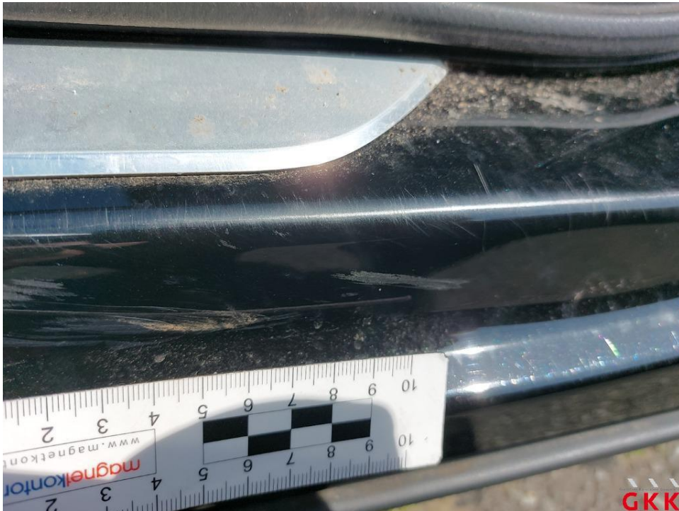
Bild 32. Tür vorne links, Einstieg, verkratzt, lackieren
