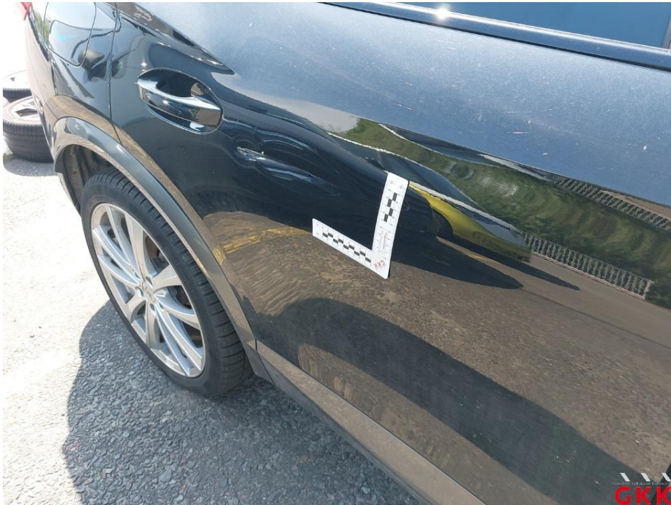
Bild 26. Tür hinten rechts, beschädigt, ersetzen
