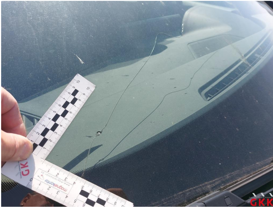
Bild 29. Frontscheibe, gerissen, ersetzen
