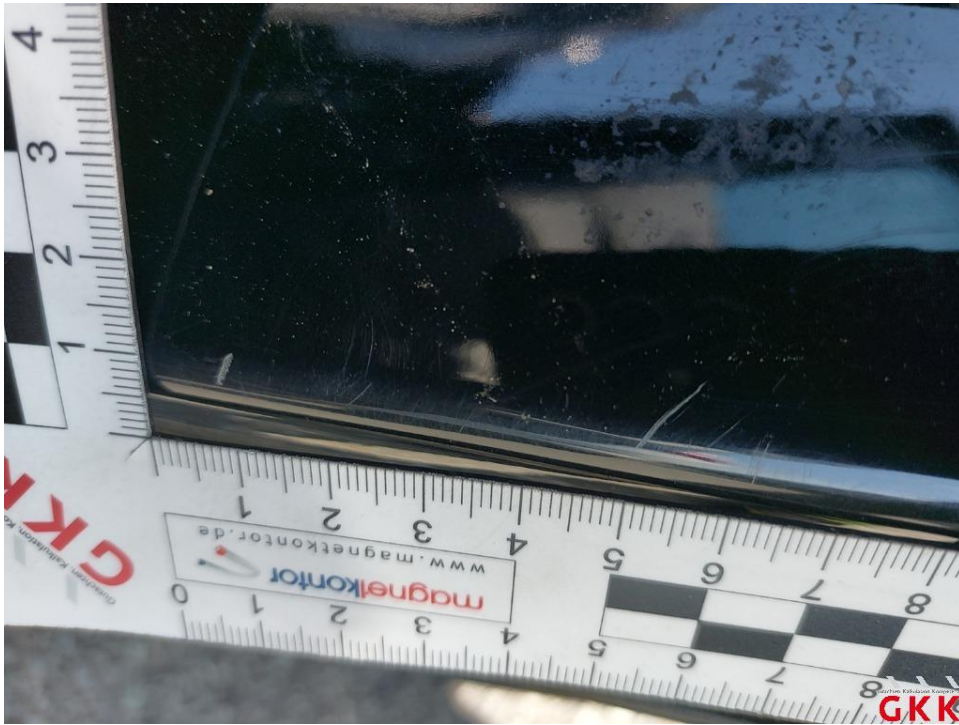
Bild 35. Tür hinten links, Einstieg, verkratzt, lackieren
