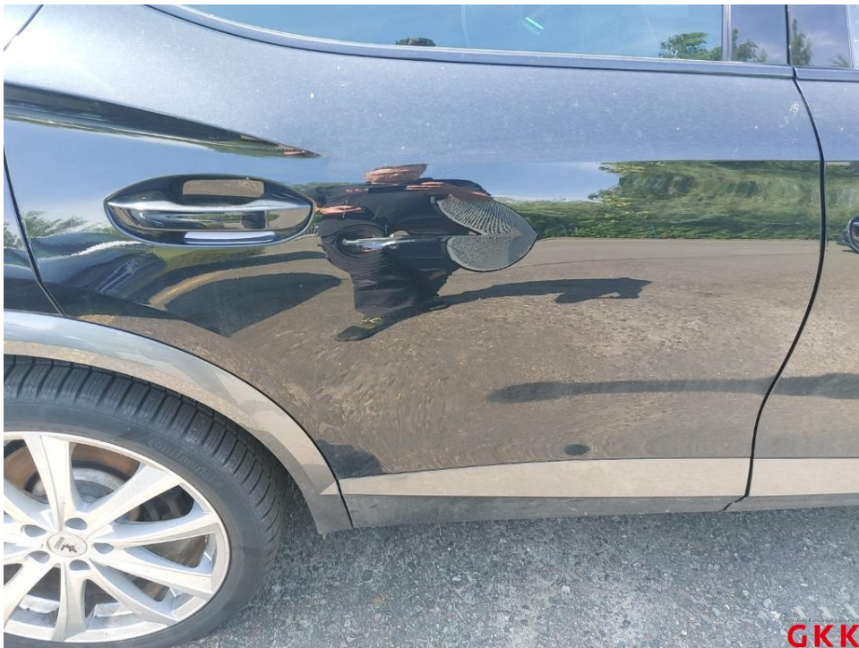
Bild 28. Tür hinten rechts, beschädigt, ersetzen
