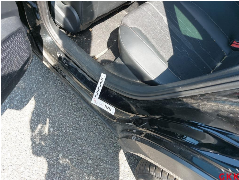
Bild 34. Tür hinten links, Einstieg, verkratzt, lackieren
