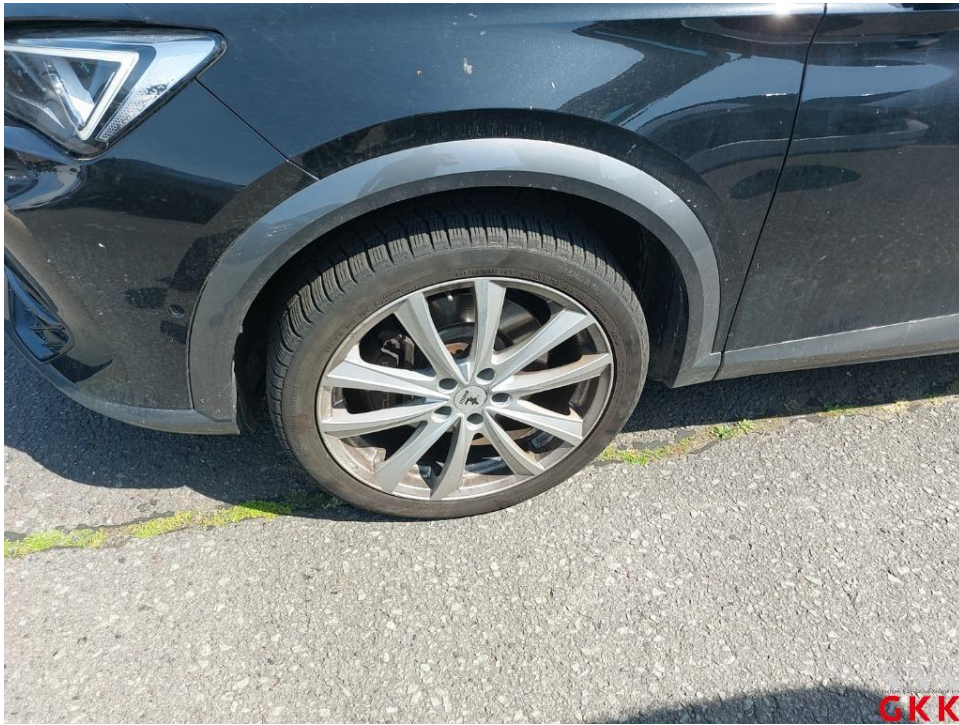
Bild 37. LM-Rad, vorne links, verkratzt, lackieren
