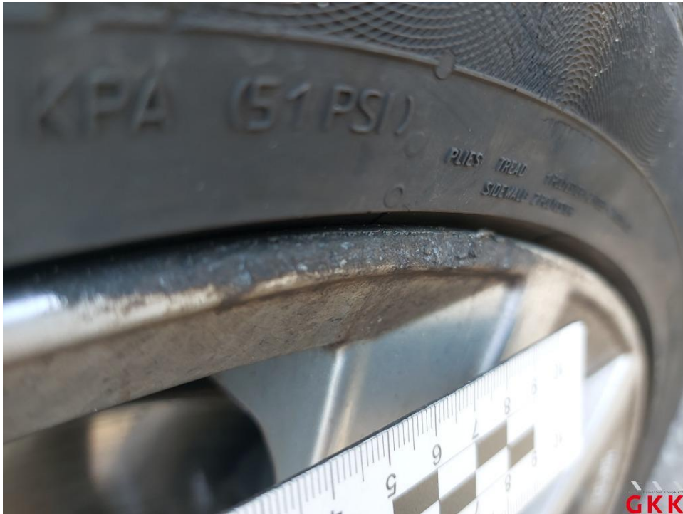
Bild 39. LM-Rad, vorne rechts, Materialabtrag, ersetzen
