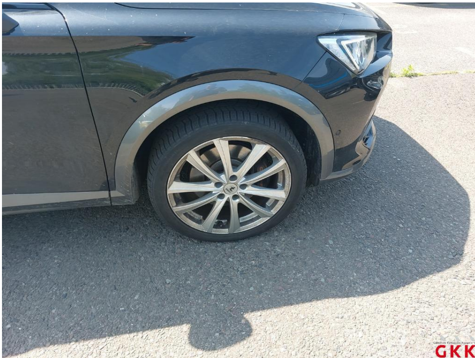
Bild 38. LM-Rad, vorne rechts, Materialabtrag, ersetzen
