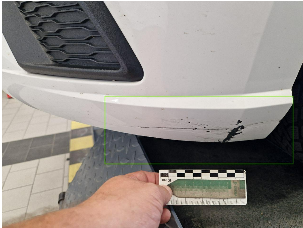
Bild 23 : Stoßfänger vorn mehrfach verschrammt
