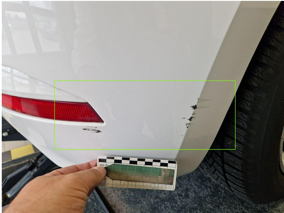
Bild 25 : Stoßfänger hinten mehrfach verschrammt
