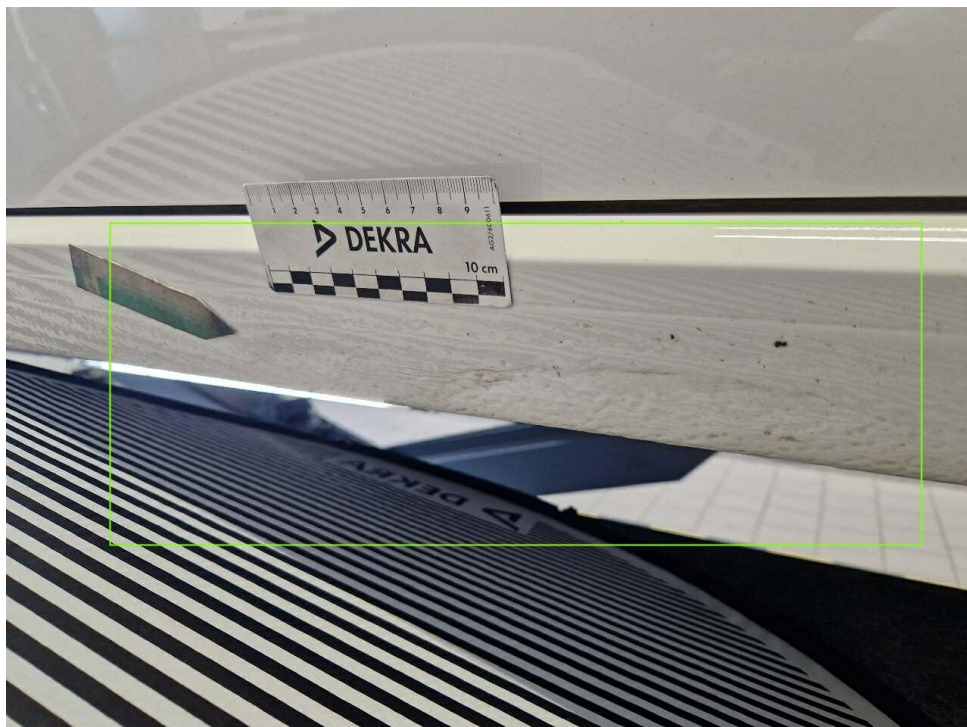
Bild 20 : Schweller rechts eingedrückt und verschrammt
