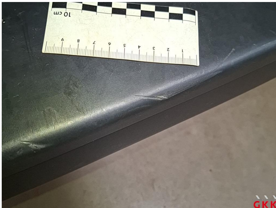
Bild 23 Stoßfänger hinten, Verkleidung -unlackiert-, beschädigt, Smartrepair
