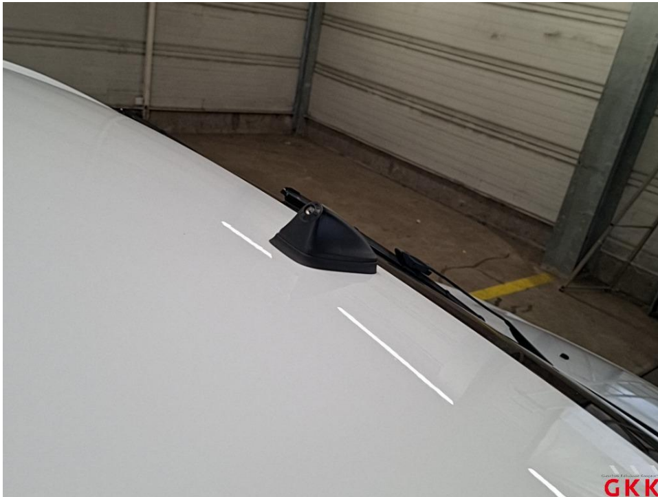
Bild 33 Antenne, Stab, fehlt, ersetzen
