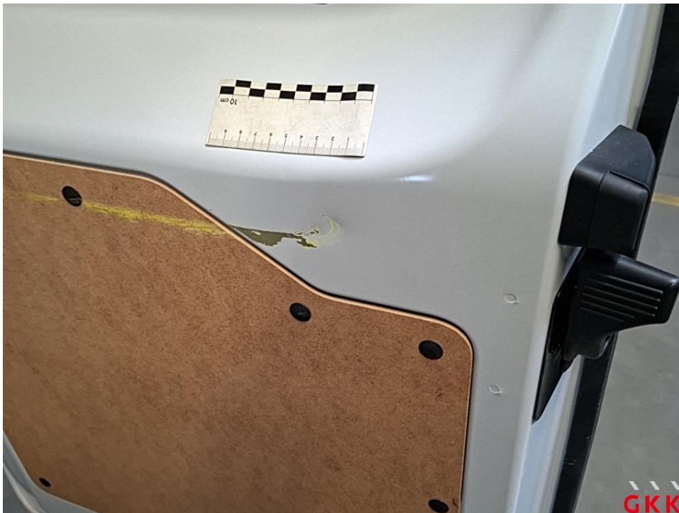
Bild 20 Hecktür rechts, innen, beschädigt, Smartrepair
