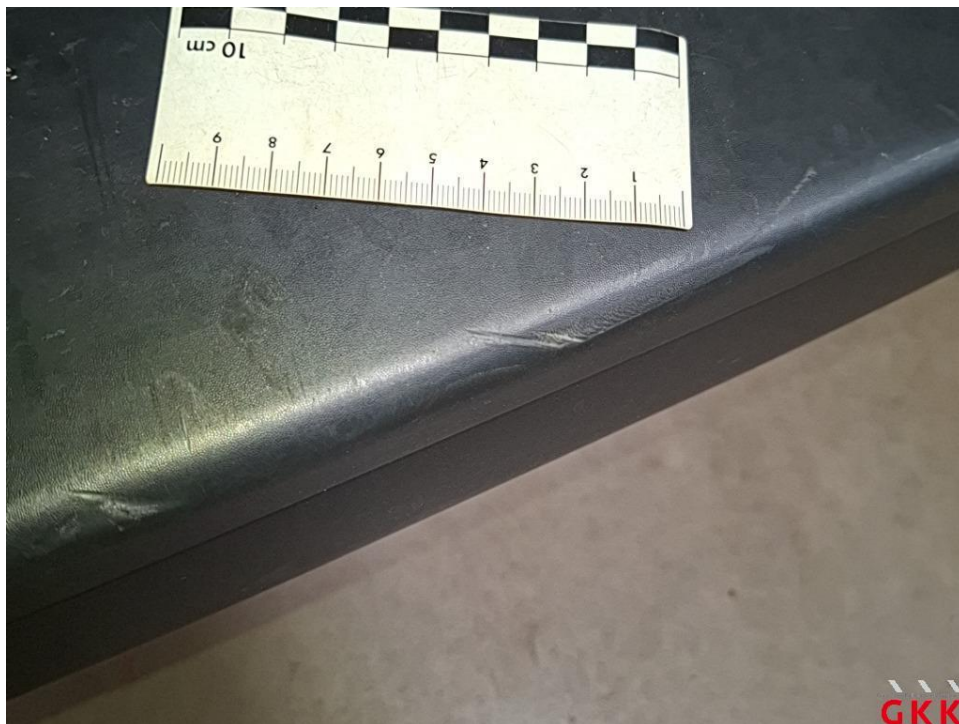
Bild 23 Stoßfänger hinten, Verkleidung -unlackiert-, beschädigt, Smartrepair
