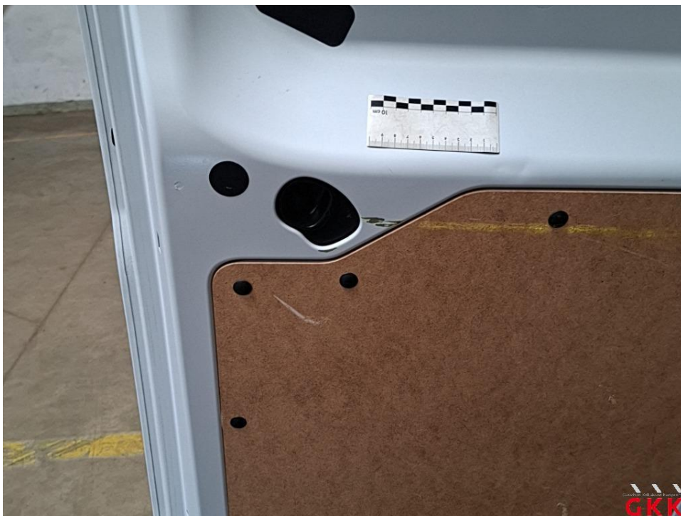
Bild 18 Hecktür links, innen, beschädigt, Smartrepair
