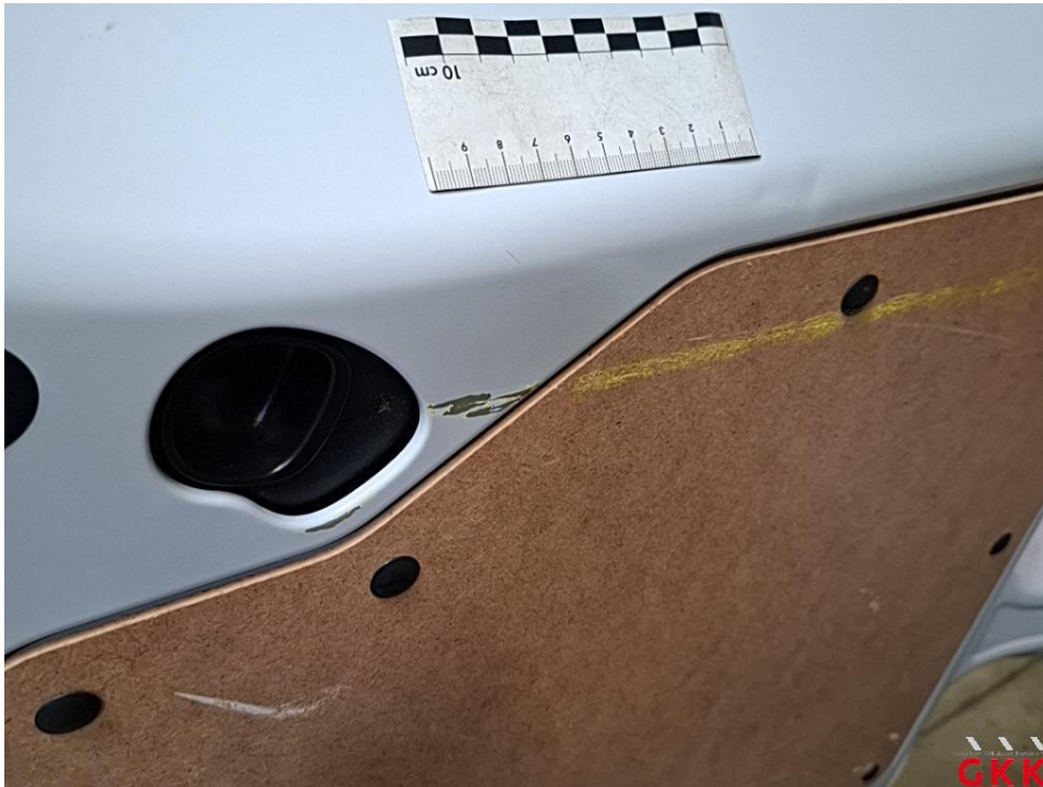
Bild 19 Hecktür links, innen, beschädigt, Smartrepair
