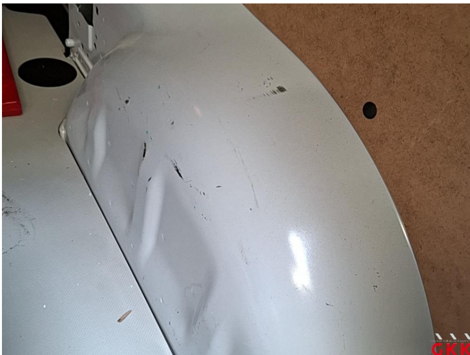
Bild 15 Laderaum, beschädigt, Smartrepair
