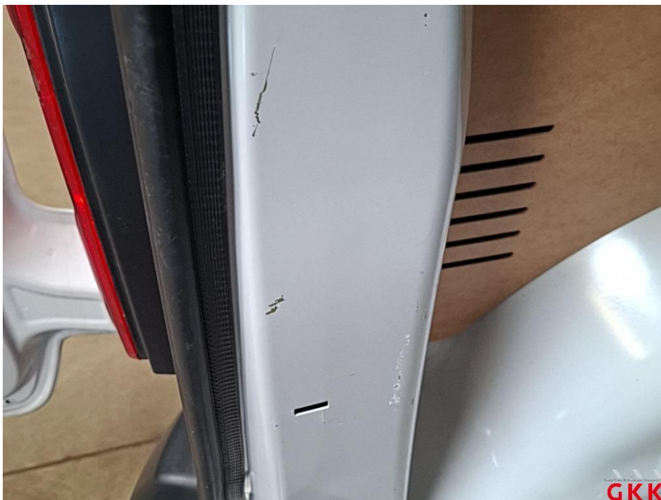
Bild 17 Laderaum, beschädigt, Smartrepair
