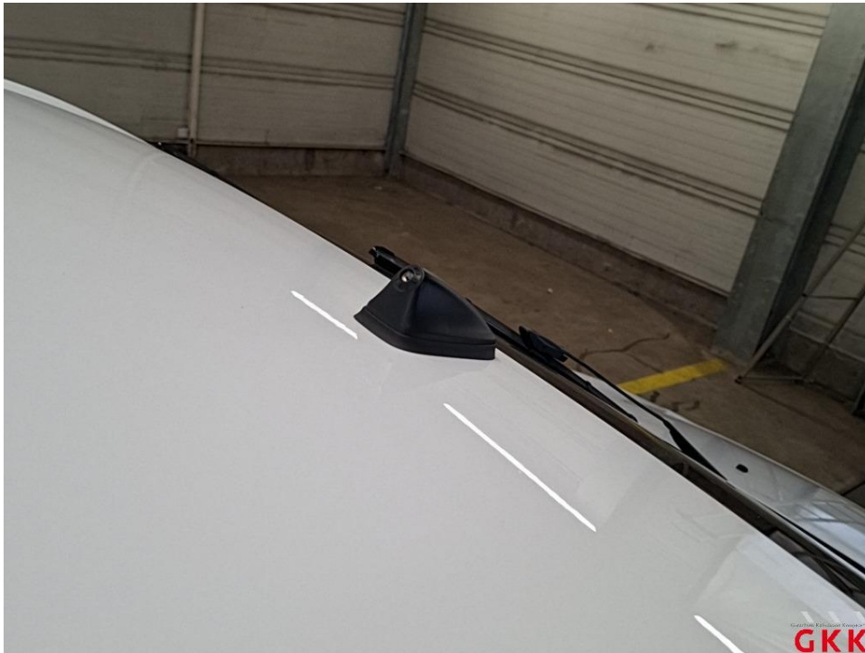
Bild 33 Antenne, Stab, fehlt, ersetzen
