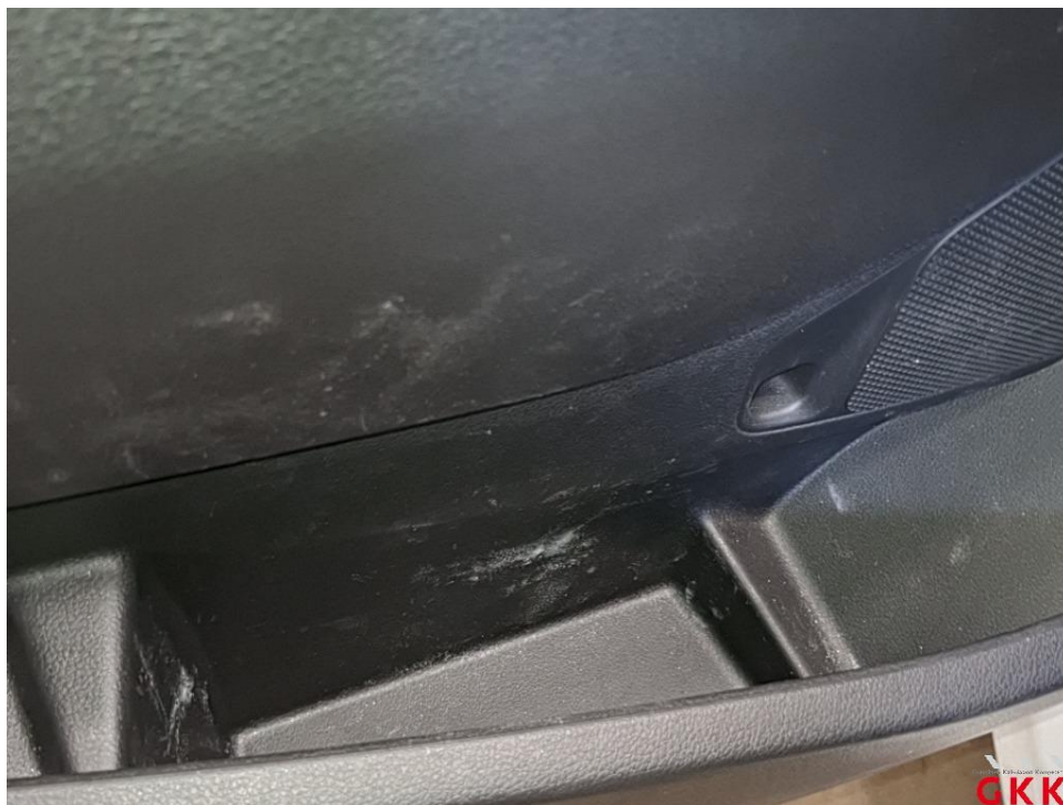
Bild 30 Fahrzeug, innen, verkratzt und verschmutzt, aufbereiten
