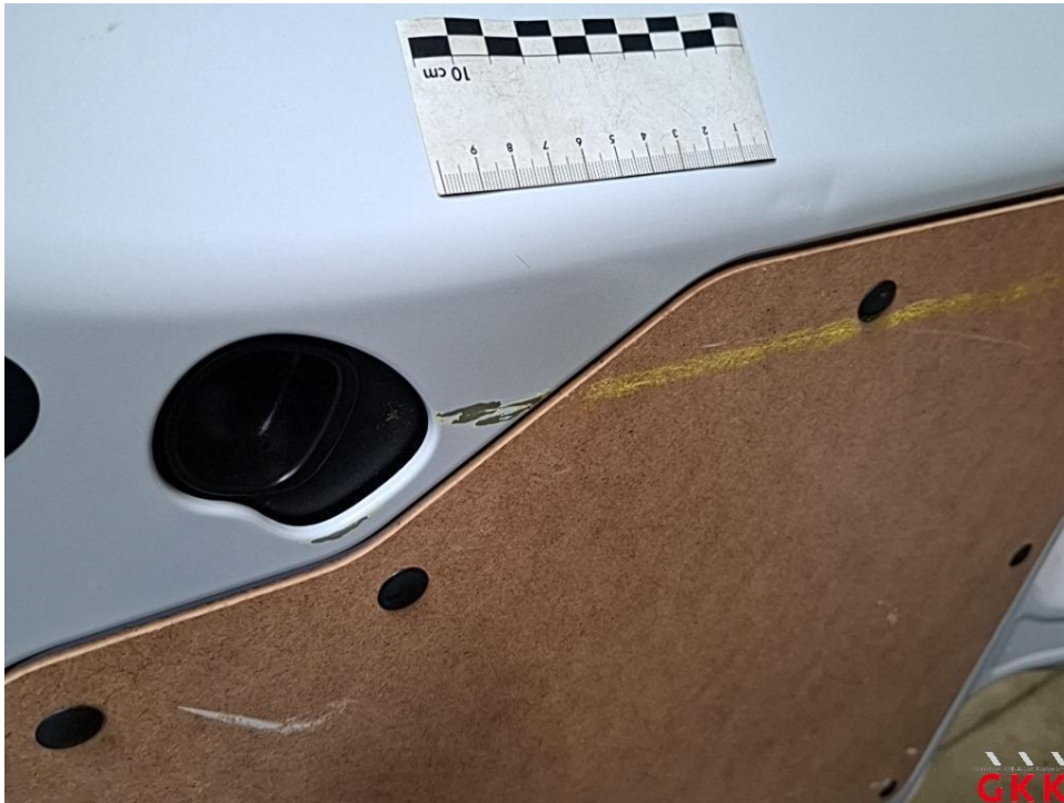
Bild 19 Hecktür links, innen, beschädigt, Smartrepair
