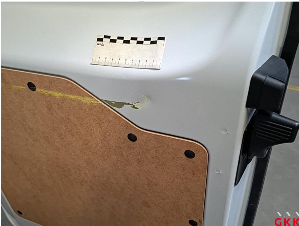
Bild 20 Hecktür rechts, innen, beschädigt, Smartrepair
