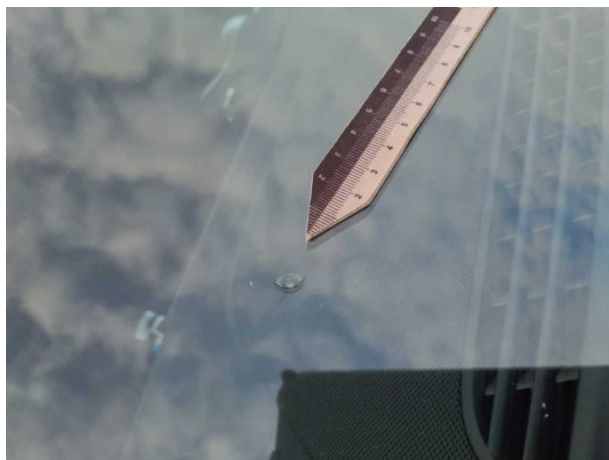
Damage 5: Vehicle glazing: Windscreen (Von Carglas bereits ausgeharzt) - Broken / torn - Replace
