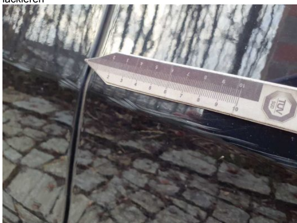
Beschädigung 4: Tür vorn rechts: Tür - verkratzt / verschürft - lackieren
