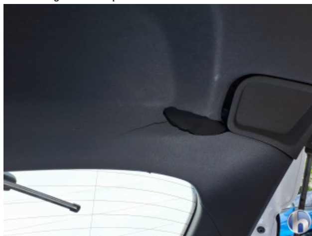
3. Heckdeckelverkleidung Beschädigt - Erneuern
