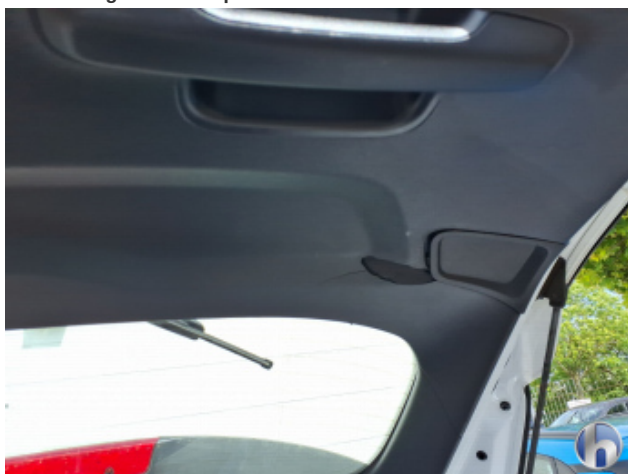
3. Heckdeckelverkleidung Beschädigt - Erneuern
