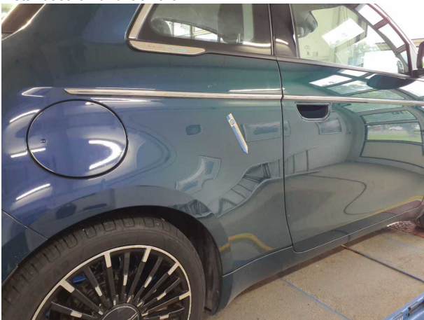
Beschädigung #5: Seitenwand rechts: Seitenwand (+ smartrepair) - Delle / Lackschaden - instandsetzen und lackieren
