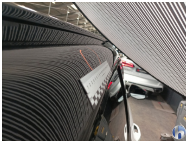
3. Dachrahmen - Rechts Delle - Sanft Instandsetzen
