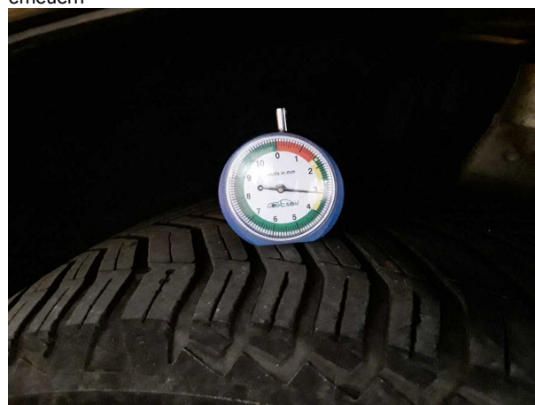
Beschädigung #1: Rad/Reifen: Reifen vorn - verschlissen - erneuern
