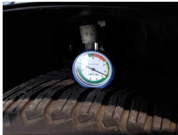
Beschädigung #1: Rad/Reifen: Reifen vorn - verschlissen - erneuern
