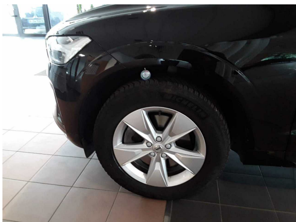
Beschädigung #1: Rad/Reifen: Reifen vorn - verschlissen - erneuern
